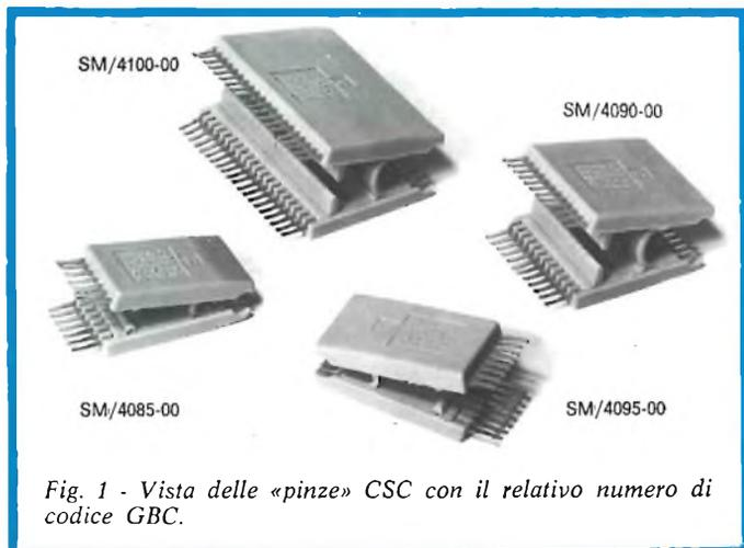
Fig. 1 - Vista delle «pinze» CSC con il relativo numero di codice GBC.
