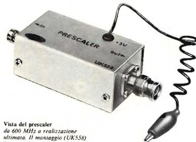
Vista del prescaler da 600 MHz a realizzazione ultimata. Il montaggio (UK558) è reperibile presso le sedi GBC.
