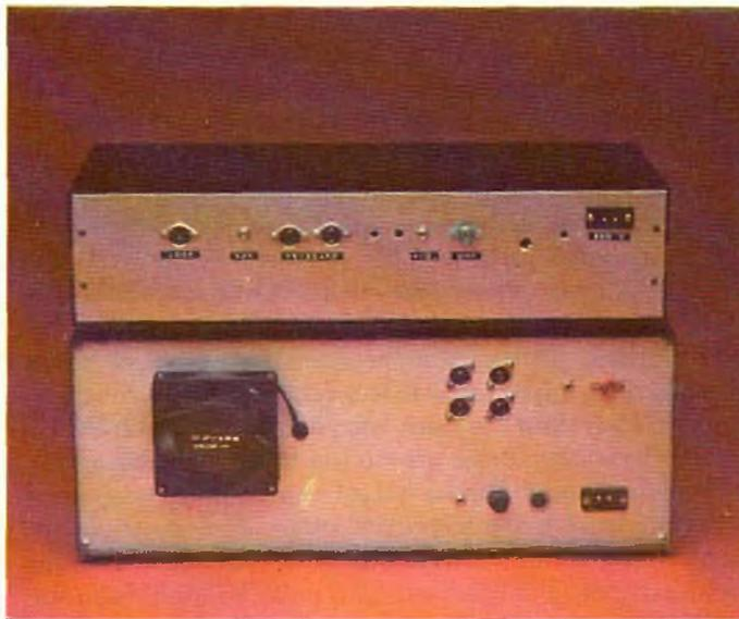
Fig. 2 - Vista del retro dei due contenitori di figura 2. Si noti, sempre nel contenitore del Computer, la ventola del raffreddamento. Ricordo che il computer è alloggiato, insieme alle espansioni di RAM e I/O, in un contenitore standard Rack 19".
