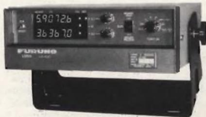
Fig. 8 - Apparecchio ricevente completamente automatico per il sistema LORAN C. Modello LC-200 della FURUNO (SIRM).
