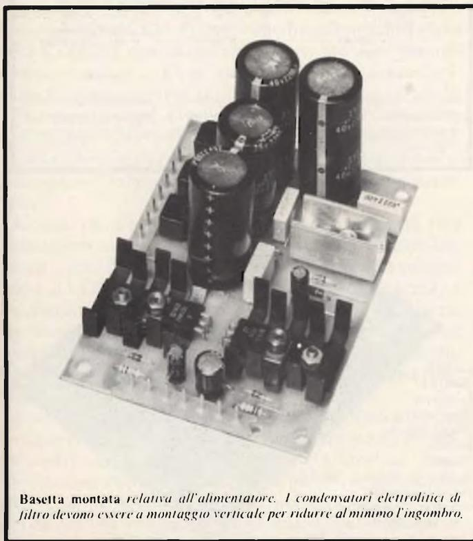
Basetta montata relativa all'alimentatore. I condensatori elettrolitici di filtro devono essere a montaggio verticale per ridurre al minimo l'ingombro.
