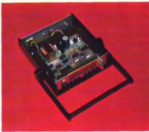
Le foto mostrano la vista interna del prototipo a realizzazione ultimata. Si noti oltre all'eleganza della disposizione dei componenti, il quarzo "Q1" che regola la frequenza della base dei tempi.
