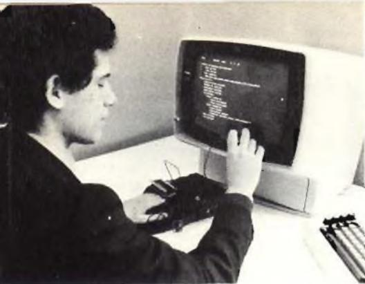
Fig. 7 - L'Optical tactile converter, cioè l'OP<sup>2</sup> TACON della IBM per non vedenti.
