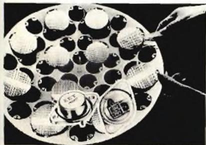
Transistori di potenza switchmode in grado di manovrare una potenza di 250W.
