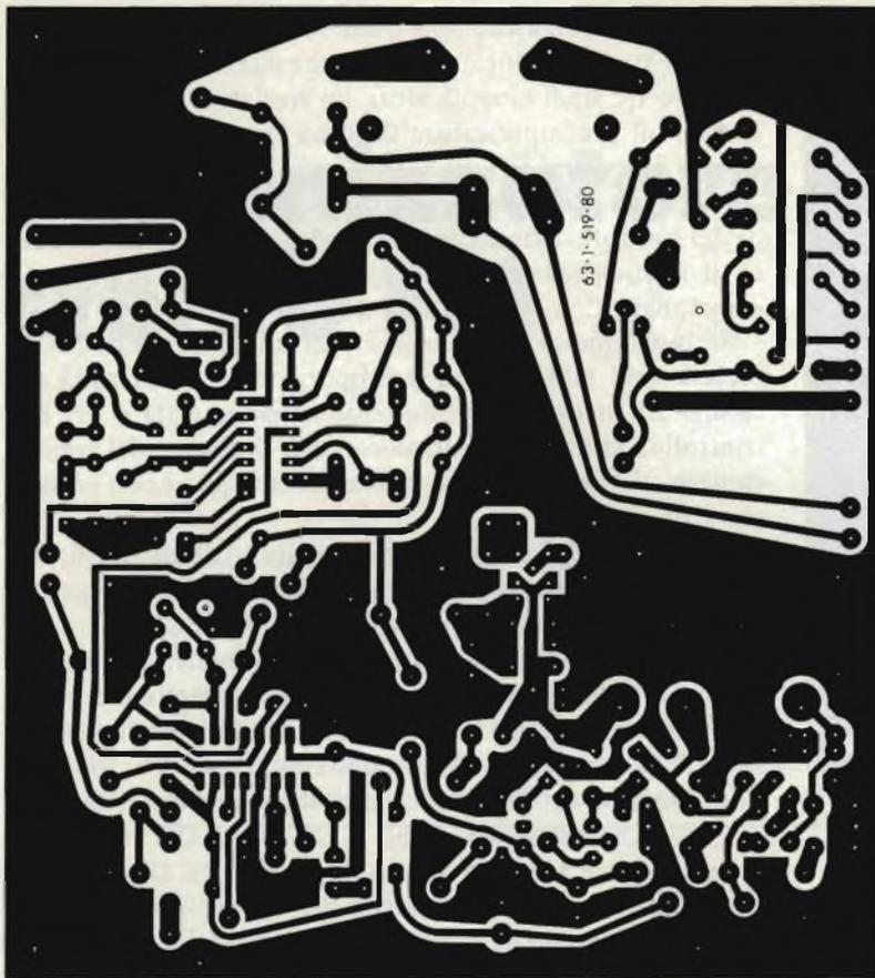
Fig. 2 - Circuito stampato lato rame del sintonizzatore.
