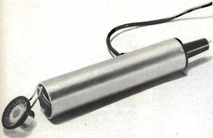
Fig. 8 - La foto mostra il prototipo della sonda logica acustica a realizzazione ultimata.
