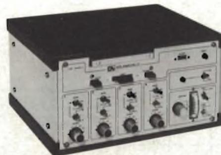
Fig. 7 - Registratore analogico a nastro magnetico, quattro canali, per usi di laboratorio, ingegneria, ricerca, medicina. Si tratta del modello 1432/4 (Ing. Vianello).
