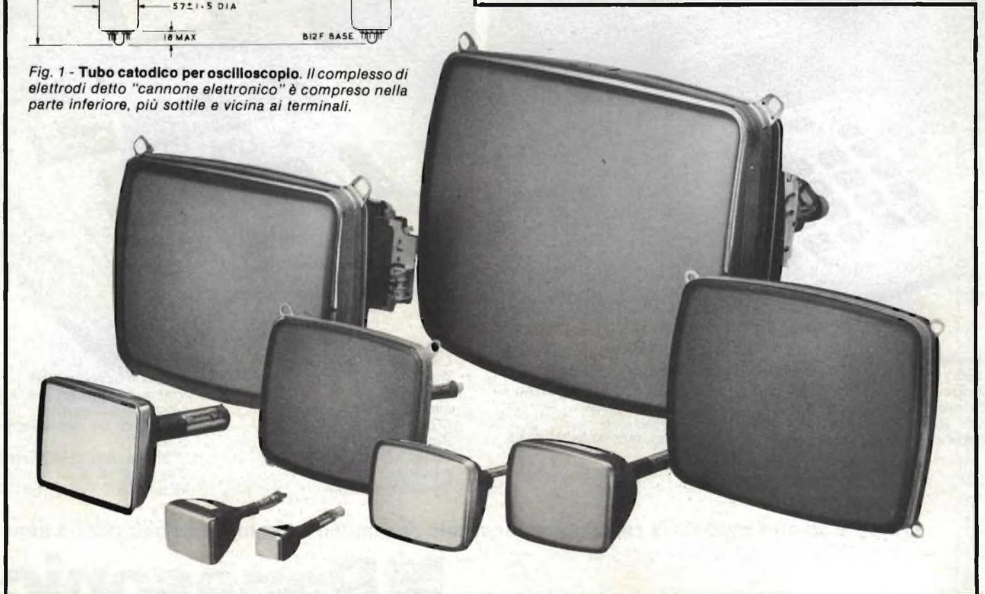
Il pennello di elettroni che si forma all'interno di un tubo catodico, per creare le immagini che servono sullo schermo, è deflesso tramite campi elettromagnetici o elettrostatici.
