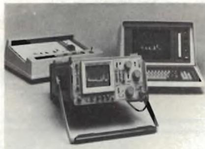
Analizzatore di spettro programmabile funzionante da 50 KHz a 220 GHz.
