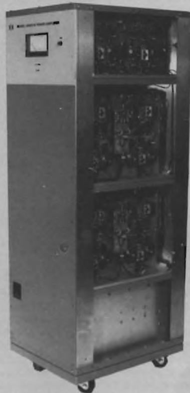
Amplificatore a larga banda con 100 W di uscita.
