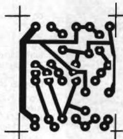
Fig. 4 - Circuito stampato della basetta inerte alla sezione "S-meter" opzionale in scala 1 : 1. La vetronite è ramata da un solo lato.
