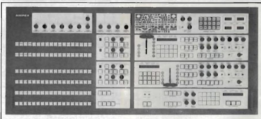
*In queste due foto sono riportati due modelli di mixer video della Ampex e precisamente sopra il 4000A, e a lato il modello AVC-33, controllato a microprocessore.*
