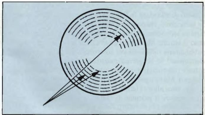
*Il video-disco. Un disco ruotante è molto più conveniente di un video-nastro, perchè qualunque punto della superficie del disco può essere raggiunto rapidamente da parte del meccanismo di lettura, permettendo così una libera selezione del materiale da visionare.*
