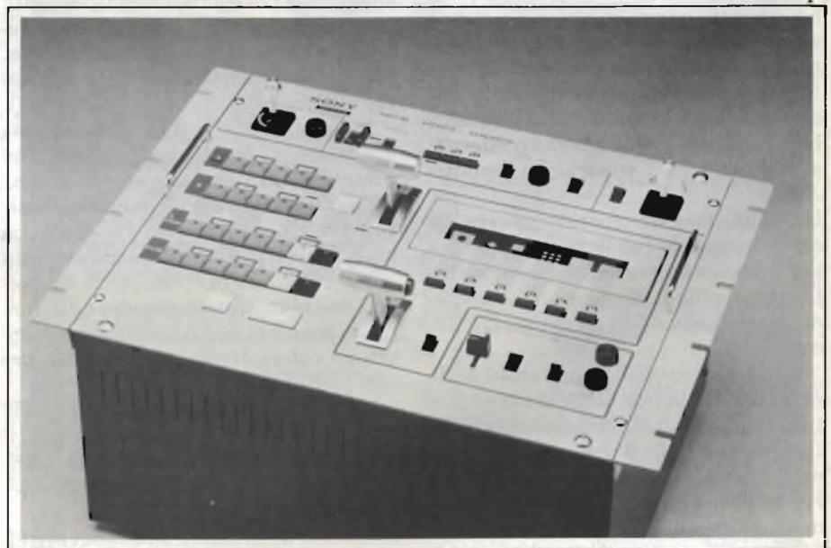
Generatore di effetti speciali - mixer video SEG - 1210 P della Sony, con cassetto per l'inserimento di chip preprogrammati, che consentono di ottenere fino a 107 differenti figure di tendina.
