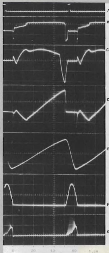
Fig. 16 - Forme d'onda nel circuito dello stadio finale di riga. (Le lettere trovano riscontro nel circuito di figura 2) A = sincronismo di riga, riferimento = 5 V/divisione; B = tensione di base, 5V/div.; C = corrente di base, 1 A/div.; D = corrente di collettore, 1 A/div.; E = corrente nelle bobine di deflessione, 1 A/div.; F = tensione sul collettore 500 V/div.; G = tensione modulatore a diodi, 50 V/div.
