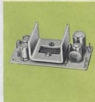
È un amplificatore che unisce ad estrema semplicità costruttiva un ottimo rendimento acustico ed un'ottima stabilità, grazie all'impiego di un circuito integrato al silicio. Unisce ad un basso contenuto di armoniche una trascurabile distorsione di crossover.
