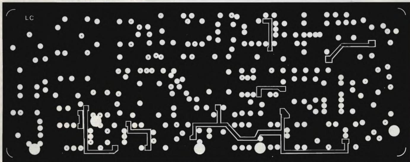
Fig. 1 - Circuito stampato del ricevitore visto dal lato dei componenti in scala 1 : 1. La superficie è ramata pressochè totalmente.
