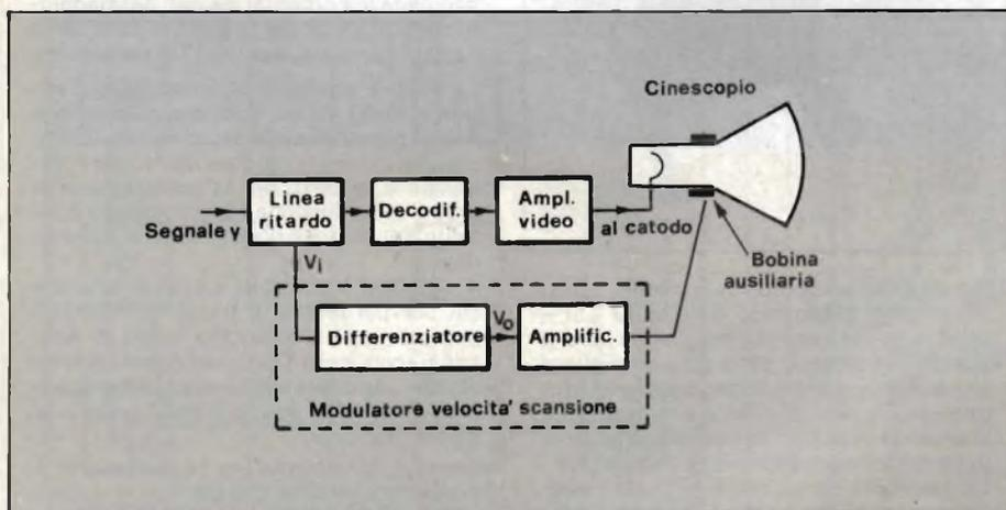
Fig. 1 - Schema a blocchi indicante la struttura fondamentale del sistema di modulazione della velocità di scansione di riga (MVS).
