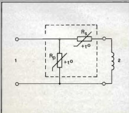
Fig. 15b - Circuito di smagnetizzazione. 1 = 110/120 V oppure 220/240 V; 2 = bobina di smagnetizzazione; R<sub>s</sub> e R<sub>p</sub> devono trovarsi in stretto contatto termico.
