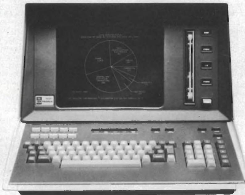
Il calcolatore da tavolo Tektronix 4051 è stato migliorato nelle sue caratteristiche, senza venire aumentato di prezzo. Il 4051 è un calcolatore autosufficiente, programmabile in BASIC, con capacità grafiche. L'unità comprende ora 16 kbyte di memoria e le funzioni per il caricamento binario e matriciale, che erano in precedenza disponibili come opzioni.
