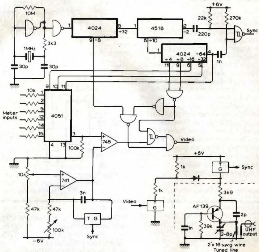
nismo di quadro. Per avere 25 canali occorreranno 4 integrati 4051, che saranno attivati uno dopo l'altro da una decodifica 1 - di - 4, pilotata da un divisore per 32 o per 64, basato sul secondo 4024. Tutte le uscite dei 4024, ad eccezione del sincronismo di quadro, hanno la frequenza quadruplicata.
