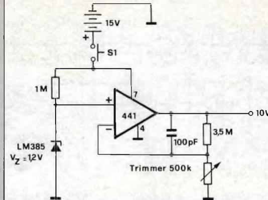
**Fig. 3 - Precisione a lungo termine.** Con l'impiego di un solo LF441, e di un diodo di riferimento che eroga la tensione costante di 1,2V, questo circuito di calibrazione, e di controllo della calibrazione dei voltmetri digitali, eroga all'uscita 10V. L'assorbimento è di soli 250  $\mu$ A. Con l'impiego di una pila da 15V, il circuito manifesta una precisione, all'uscita, dello 0,1% a lungo termine, come dire per un anno di tempo o anche più.
