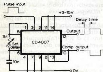
Ritardi di impulsi che vanno da alcuni millisecondi a parecchi secondi, si possono ottenere con un solo circuito integrato, basta che il tempo di ritardo sia inferiore alla durata dell'impulso.
