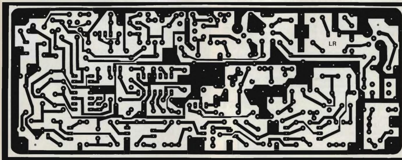
Fig. 2 - Basetta a circuito stampato dell'apparecchio vista dal lato rame in scala 1 : 1. L'eventuale autoconstruzione è bene venga eseguita tramite fotoincisione.
