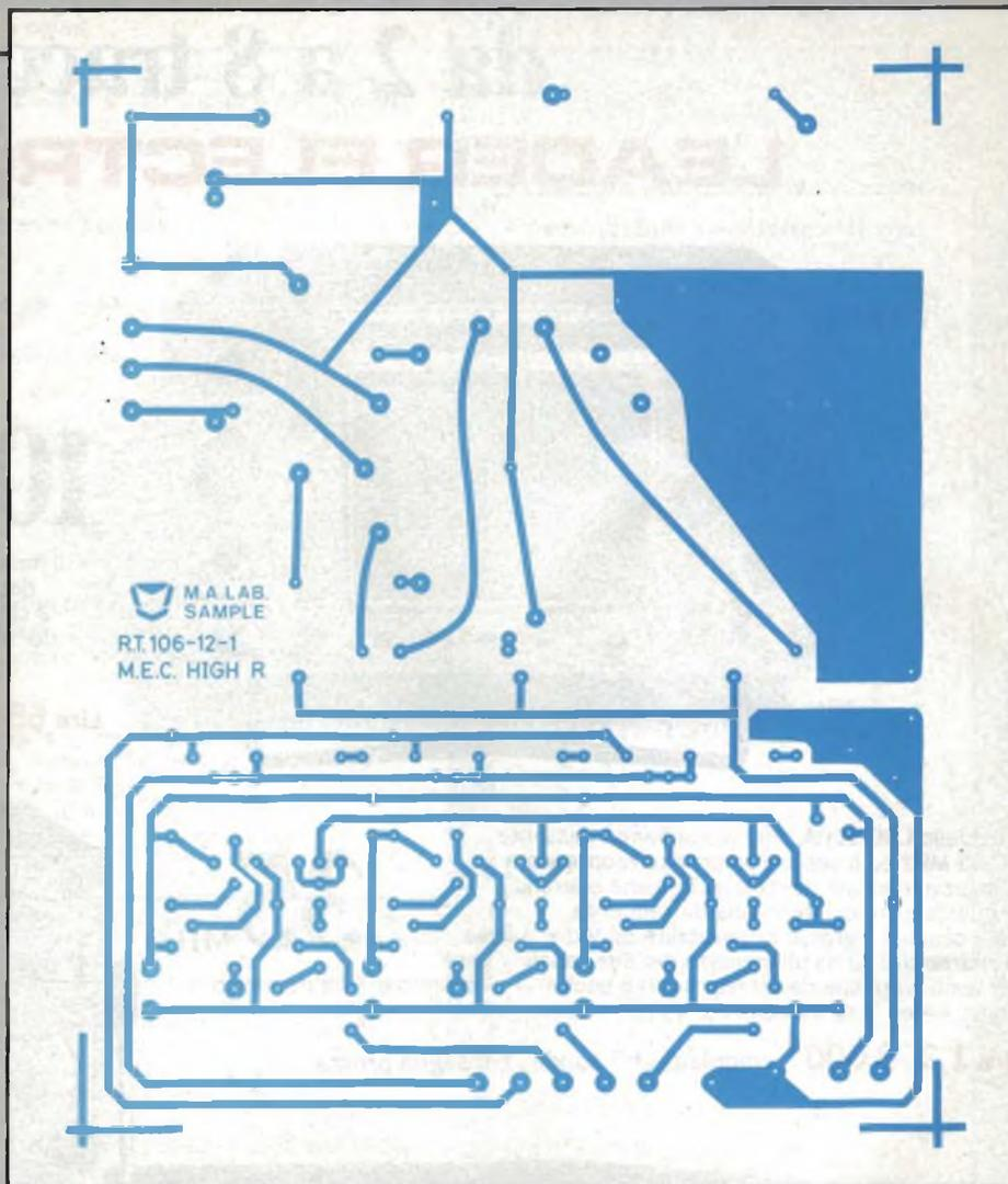
Fig. 7 - Circuito stampato del pannello del cinescopio. (Scala 1:1).
