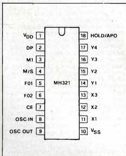
Fig. 1 - Disposizione dei terminali nel circuito integrato MH-321.
