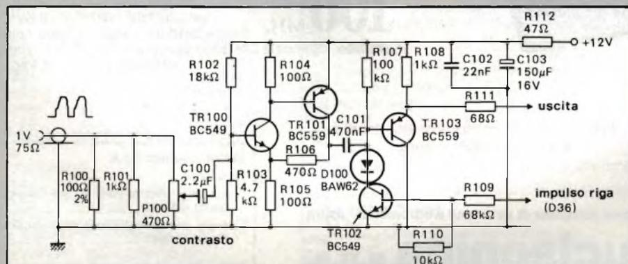
Fig. 9 - Preamplificatore video (ne occorrono tre).
