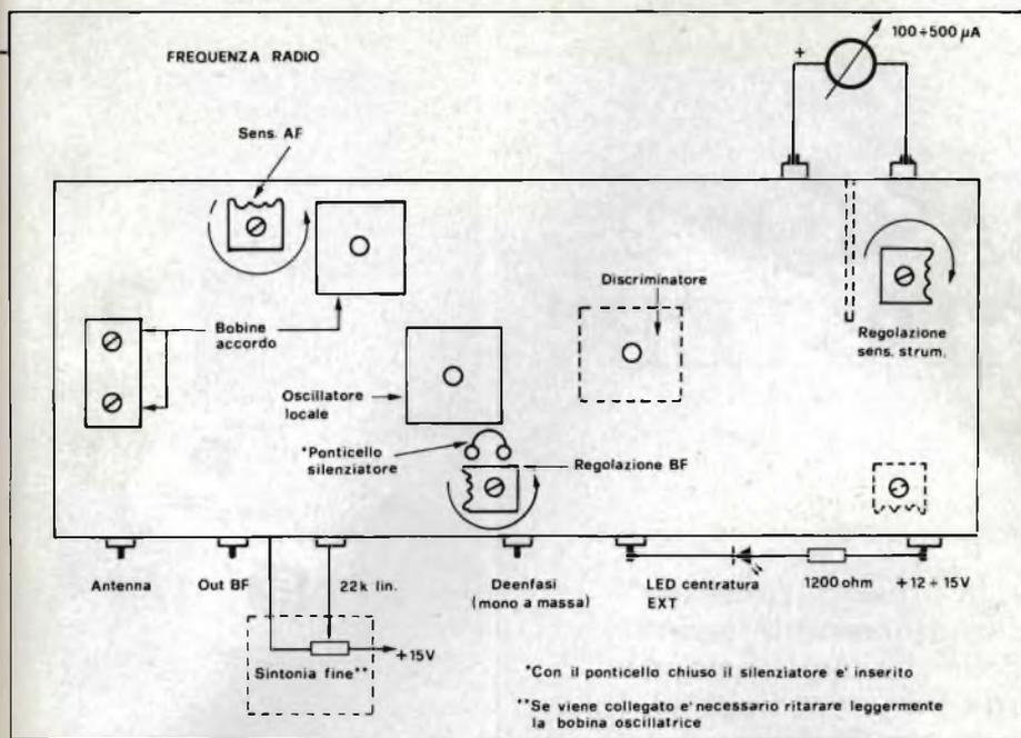
Fig. 6 - Connessioni da effettuare esternamente al contenitore. La figura mostra anche i principali punti di taratura per l'allineamento del ricevitore.
