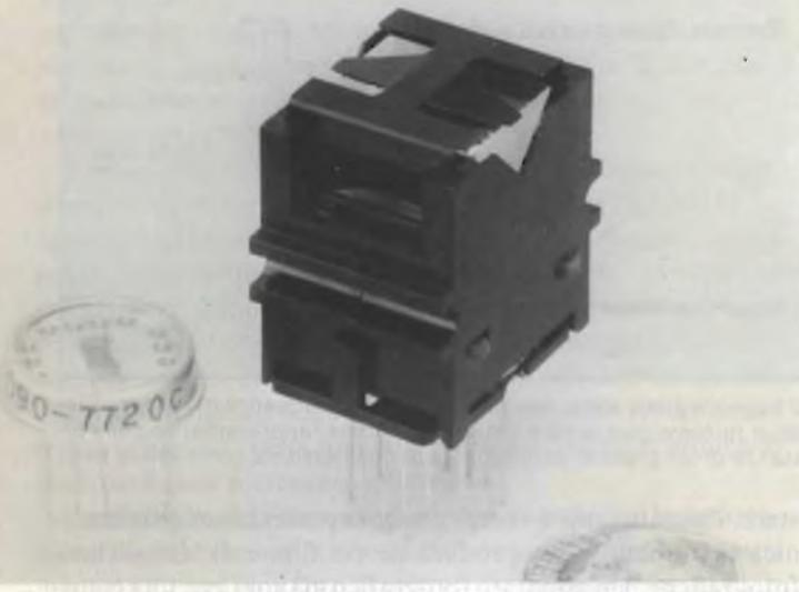
*Il Visitronic della Honeywell contiene un circuito che controlla automaticamente il fuoco di un apparecchio fotografico paragonando due immagini "viste" elettronicamente. La fotografia mostra il circuito e il contenitore in cui è posto.*
