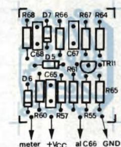
Fig. 5 - Disposizione dei componenti sulla basetta di figura 4, che andrà montato verticalmente sullo stampato "master" tramite spezzoncini di filo.
