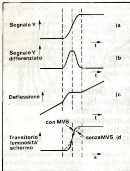
Fig. 2 - a) Segnale prelevato dalla linea di ritardo della luminanza; b) lo stesso segnale all'uscita del differenziatore; c) deflessione di riga modificata dal sistema MVS in funzione del tempo; d) transitorio di luminosità sullo schermo prodotto dal segnale di luminanza a).
