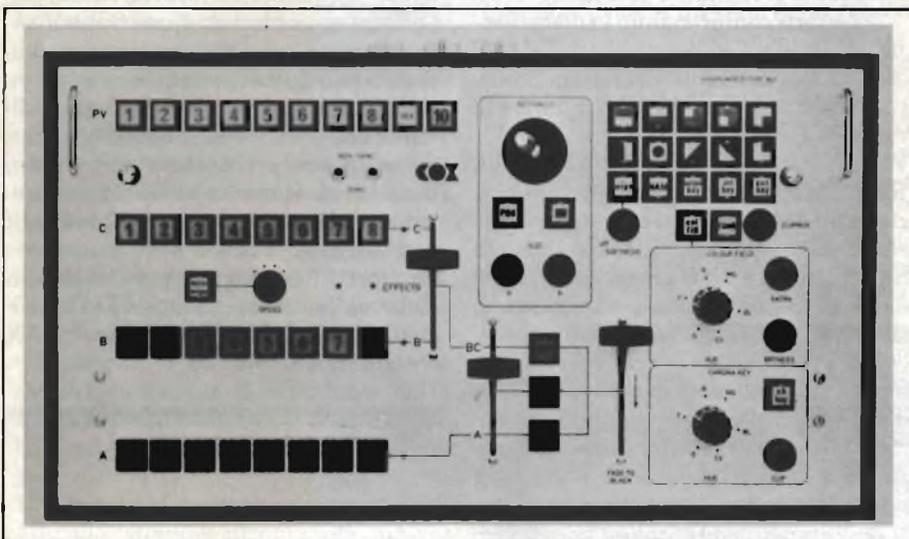
dotato di 8 ingressi di cui due non sincroni (ora però è disponibile anche in versioni a 10,12 e 16 ingressi) con tre barre di commutazione più una di preview. Ha 10 figure di tendina con bordi di morbidezza regolabile; inoltre si può posizionare con il joystick un rettangolo (regolabile in altezza e larghezza) in qualsiasi posizione dello schermo. Un generatore di colore consente di colorare i titoli con tinta, luminosità e saturazione a piacere.
