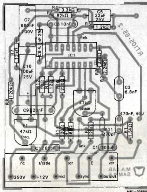
Fig. 5 - Circuito stampato dell'oscillatore di riga. (Scala 1:1).
