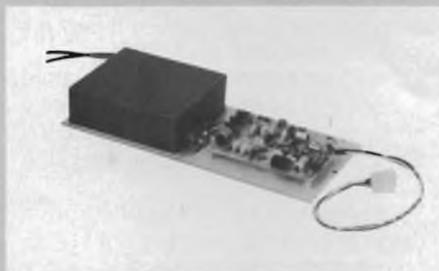
*Alimentatore CRT di precisione con uscite multiple.*
