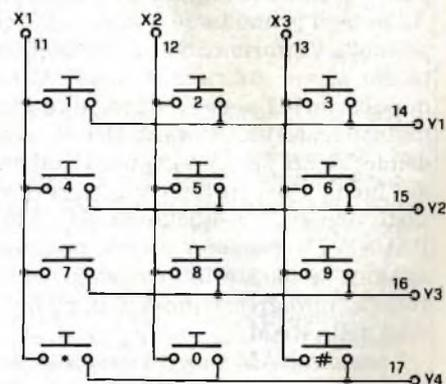
Fig. 3 - Schema elettrico dei collegamenti della tastiera.
