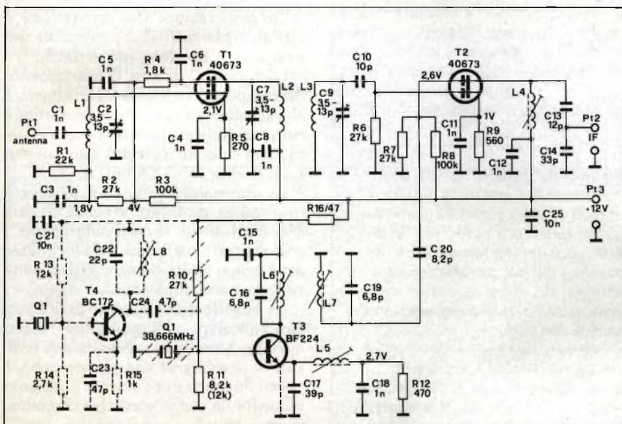
Fig. 1 - Schema elettrico del convertitore “MINI-MOSFET”. La parte tratteggiata può essere inclusa o omessa, a seconda delle preferenze del costruttore (si veda il testo).
