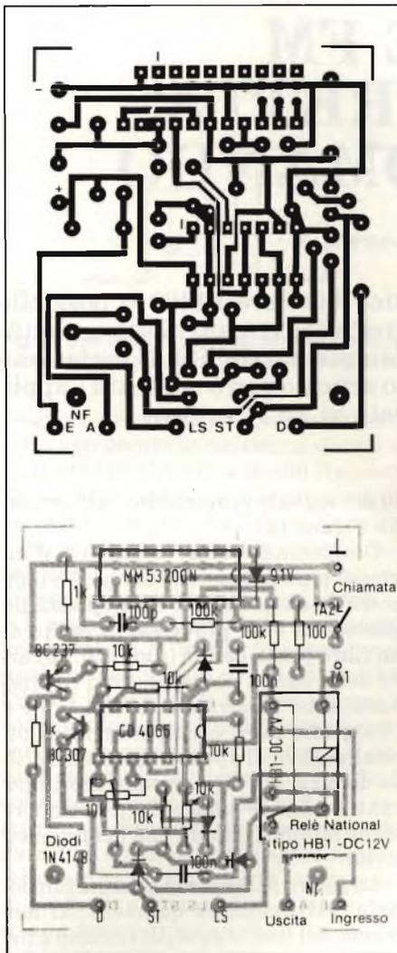
**Fig. 3 - Circuito stampato e disposizione dei componenti per il circuito di chiamata selettiva.**
