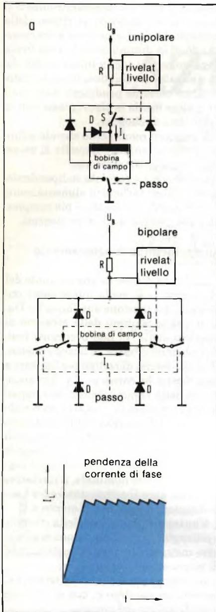
Fig. 4 - Limitazione della corrente di fase mediante azionamento a chopper.
