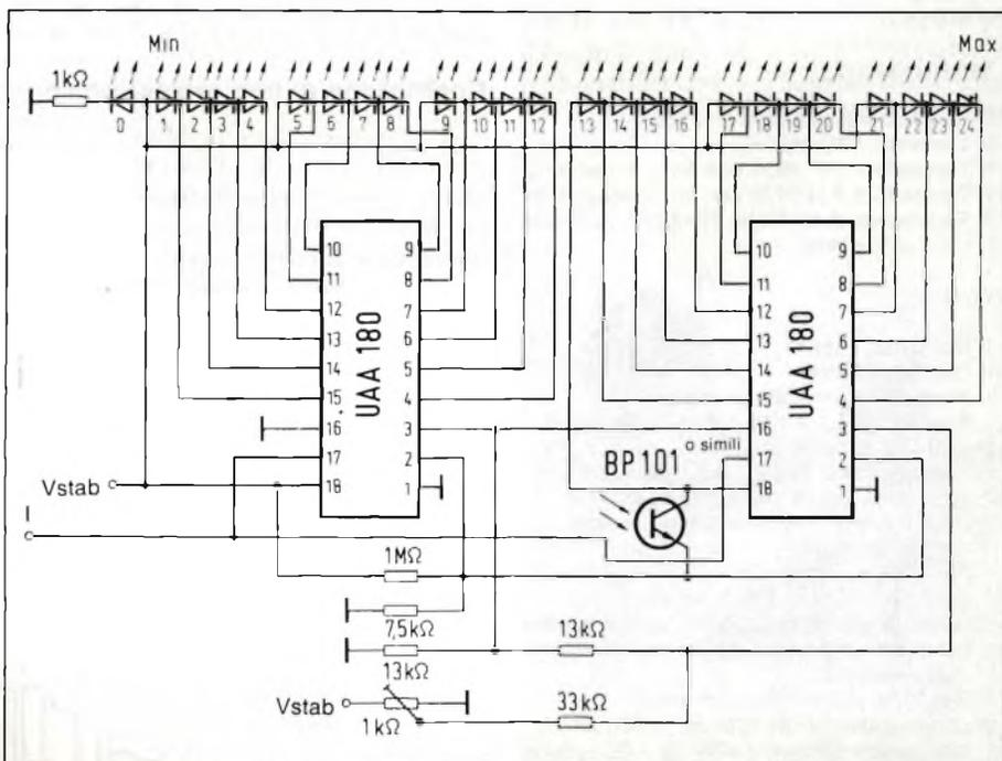
Fig. 2. Il circuito del visualizzatore è basato su due circuiti integrati UAA 180 collegati in cascata e contiene anche un regolatore automatico della luminosità dei LED. Il primo dei 25 LED della scala è la spia di apparecchio acceso ed indica il regime di rotazione zero.
