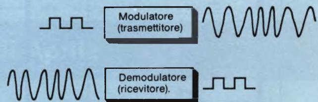
Un modem è composto da un modulatore (trasmettitore) e da un demodulatore (ricevitore).
