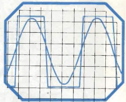
Fig. 3. Oscillogramma delle onde sinusoidali e rettangolari, rilevato alla frequenza di 833 Hz, con una tensione d'uscita Vp-p di 6 V.
