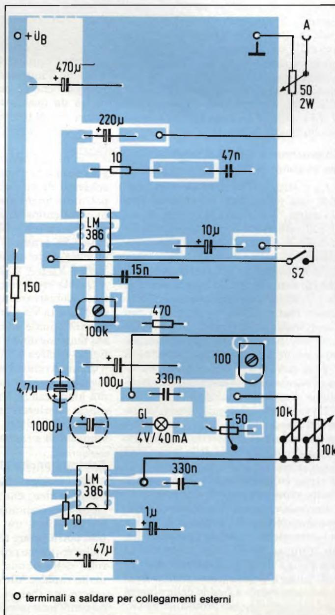
Fig. 5. Disposizione dei componenti sul circuito stampato.
