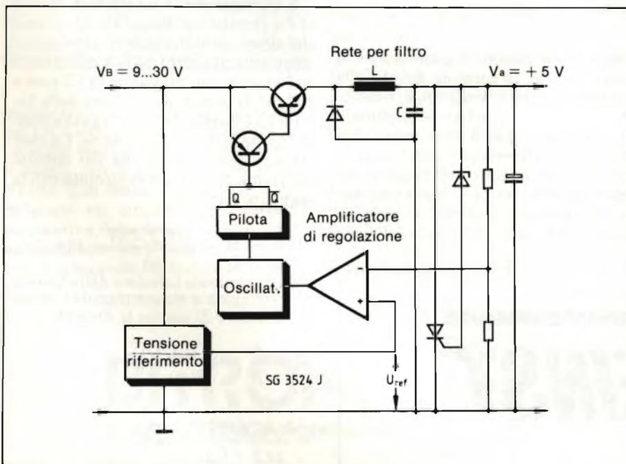
Fig. 1 - Schema di principio del convertitore da +5V.
