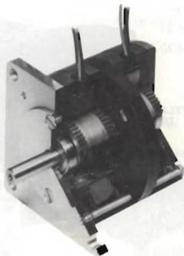
Spaccato di un motore passo-passo ibrido. Anche in questo caso, il rotore è a magnete permanente. La particolare struttura a denti del rotore e dello statore permette di ottenere valori di coppia elevata e angoli di passo estremamente piccoli, ( $1,8^\circ$ ).
