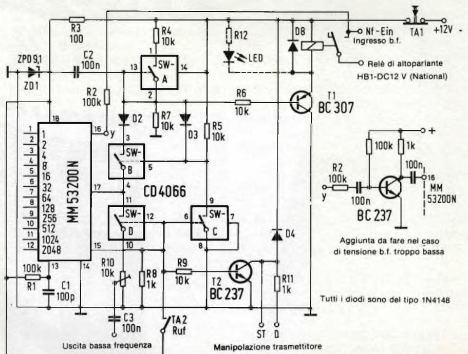
Fig. 2 - Circuito per l'impiego pratico in trasmissione ed analisi del segnale di chiamata.
