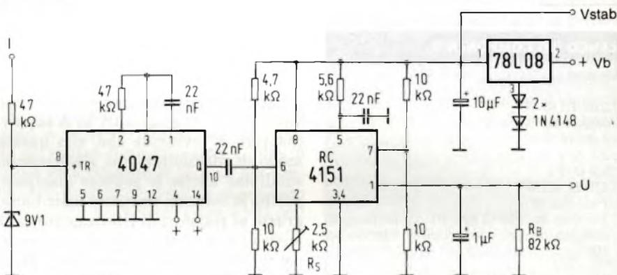
Fig. 1. Schema elettrico del convertitore frequenza - tensione. Al punto + V<sub>b</sub> verrà collegata la tensione di alimentazione (batteria auto). L'uscita V<sub>stab</sub> dovrà essere collegata al corrispondente ingresso del circuito stampato del visualizzatore; U della fig. 1 dovrà essere collegato al punto I della fig. 2. In questo schema parziale, il conduttore proveniente dal ruttore dovrà essere collegato al punto I.
