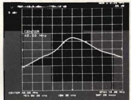
Fig. 4 - Banda passante d'ingresso con il circuito di figura 1b.
