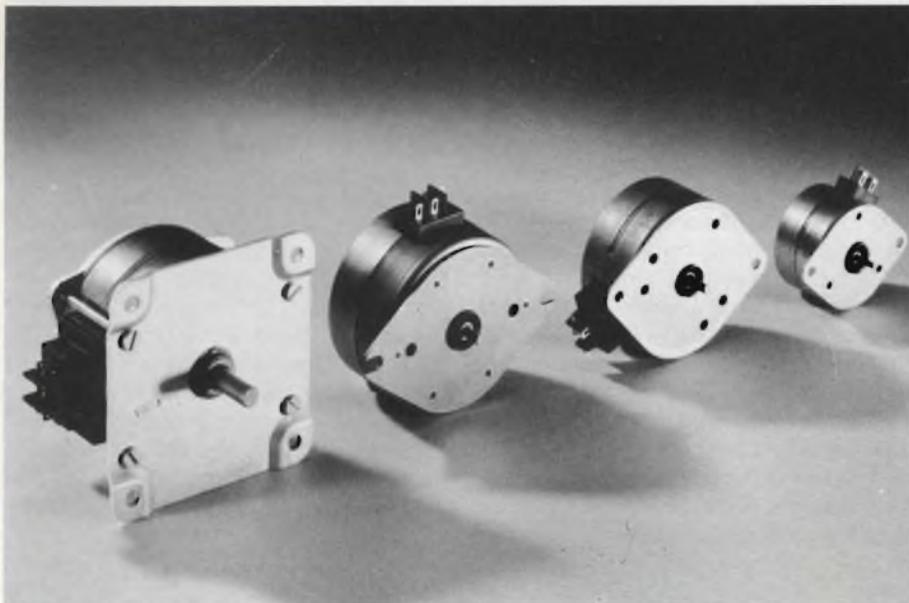
Tipici motorini in continua. Alcuni posseggono il rotore senza ferro e pertanto hanno uno spunto pronto; altri hanno incorporato un generatore tachimetrico, e pertanto, sono molto adatti per sistemi che richiedono una velocità costante indipendente dal carico.
