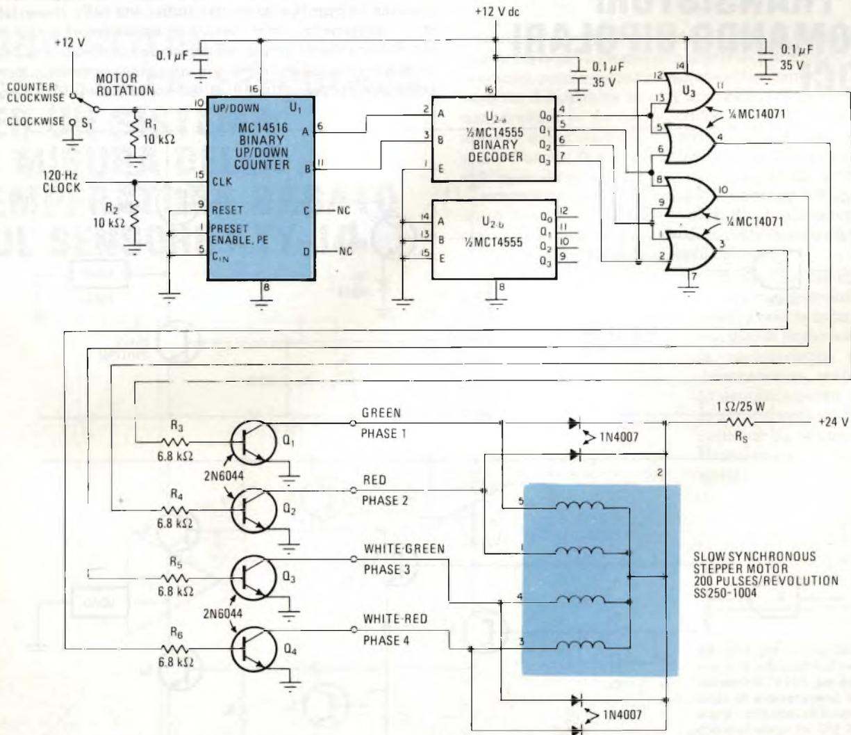
Il comando del motore passo-passo a quattro fasi (200 impulsi/giro) è attuato dai Darlington di potenza Q1 ... Q4 comandati a loro volta da quattro porte OR, un decodificatore binario e un contatore avanti/indietro. Il senso di rotazione è stabilito dall'interruttore S1. Il sistema può essere anche telecomandato.
