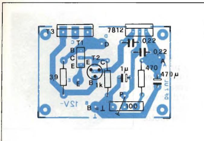
Fig. 3. Disposizione dei componenti sul circuito stampato.
