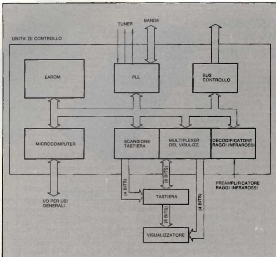
Fig. 6 - Unità di controllo. È l'insieme di un microcomputer e di circuiti dedicati per le diverse funzioni (PLL, tastiera, display...).
