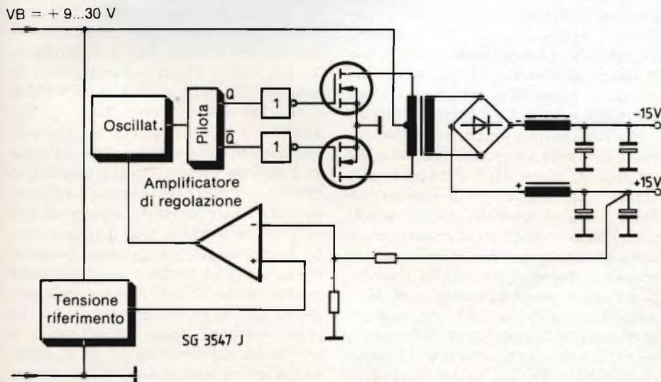
Fig. 3 - Schema di principio del convertitore da ±15V.
