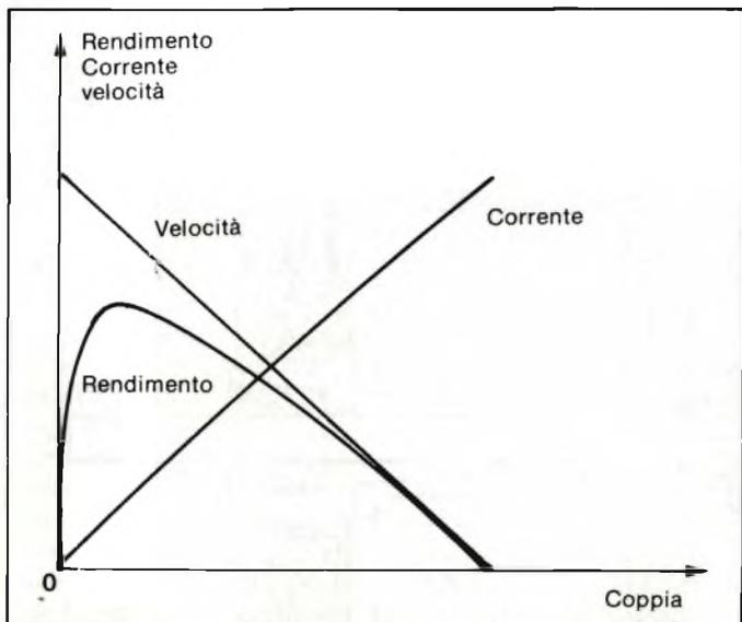
Fig. 1 - Andamento della velocità, del rendimento e della corrente in funzione della coppia di un motore in continua con eccitazione a magneti permanenti.
