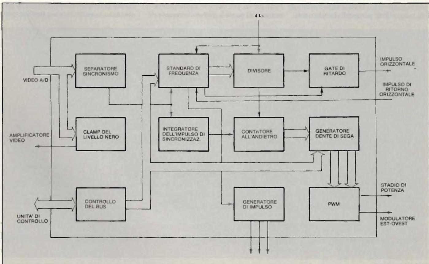
Fig. 4 - Processore di deflessione. Provvede a generare tutte le funzioni di temporizzazione e di sincronizzazione nel ricevitore TV.
