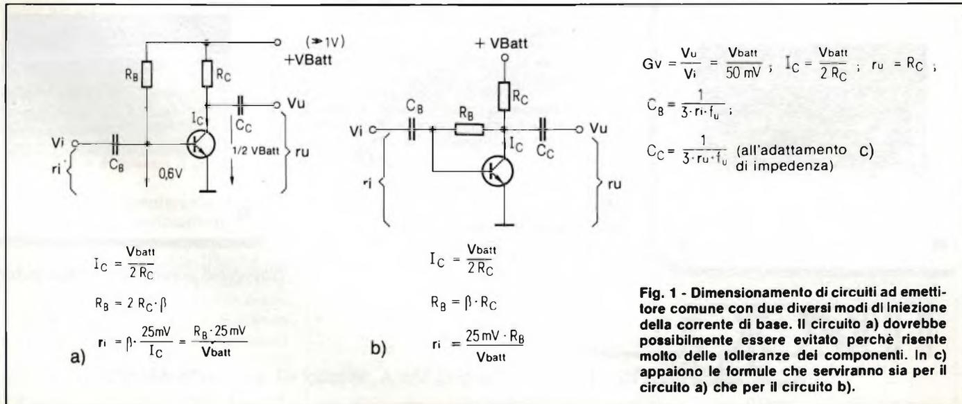
Fig. 1 - Dimensionamento di circuiti ad emettitore comune con due diversi modi di iniezione della corrente di base. Il circuito a) dovrebbe possibilmente essere evitato perchè risente molto delle tolleranze dei componenti. In c) appaiono le formule che serviranno sia per il circuito a) che per il circuito b).
