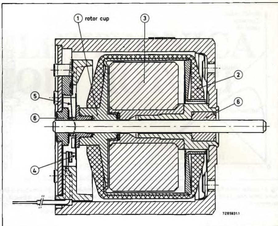
Fig. 3 - Struttura interna di un motore con rotore senza ferro: 1 = rotore; 2 = avvolgimento del rotore; 3 = magneti dello statore; 4 = commutatore; 5 = spazzole; 6 = boccole.
