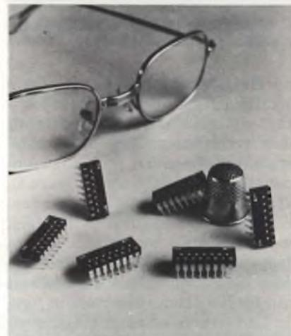
Inoltre per proteggere i contatti da possibili contaminazioni durante la saldatura ad onda, è sufficiente l'applicazione di un sottile nastro adesivo.
