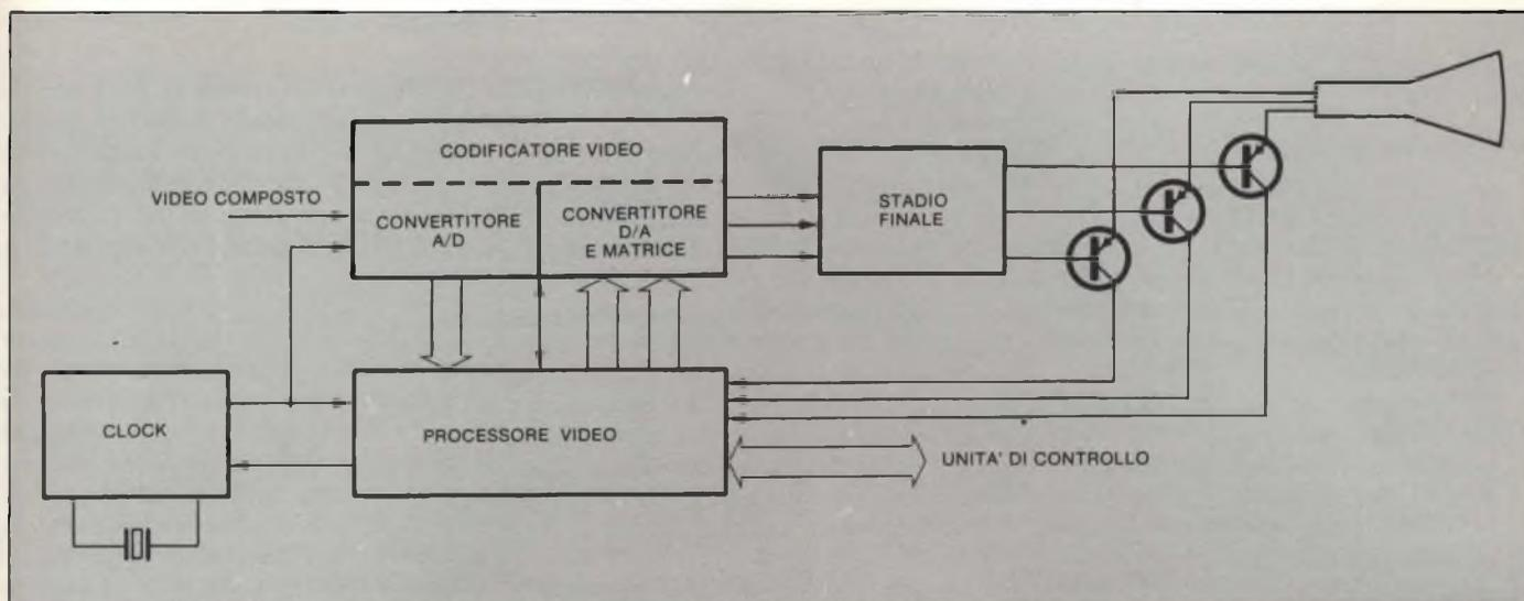
Fig. 2 - Sezione video del ricevitore TV. (I flussi di informazioni analogiche sono indicati dalle frecce semplici, quelle digitali dalle frecce doppie). Il segnale video è digitalizzato, elaborato dal processore video e quindi riconvertito e amplificato dagli stadi di potenze finali.
