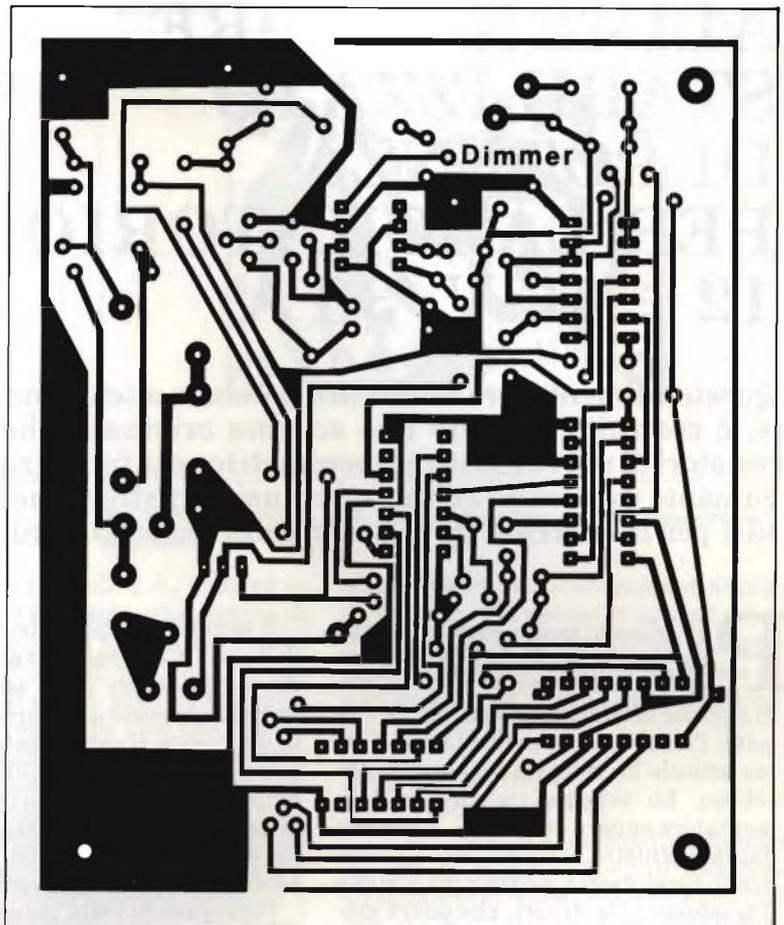
Fig. 8. Circuito stampato dell'elaboratore digitale.
