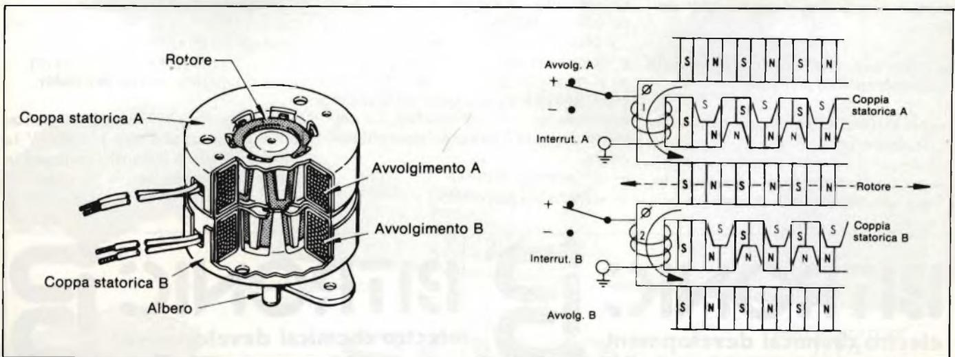
Fig. 4 - Struttura di un motore passo-passo convenzionale.
