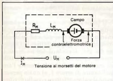
Fig. 1 - Circuito equivalente semplificato di un motore.
