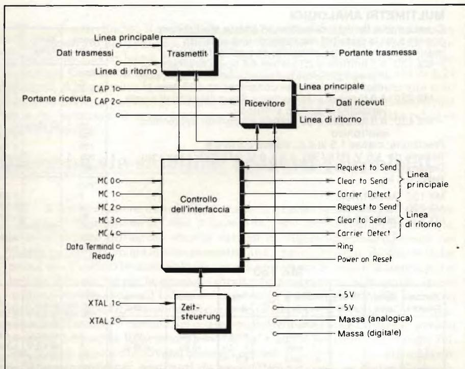
Fig. 1 - L'integrato Am7910 contiene il circuito completo di un modem. Programmando gli ingressi di controllo MC0 ... 4, si possono realizzare nove diversi tipi di modem.
