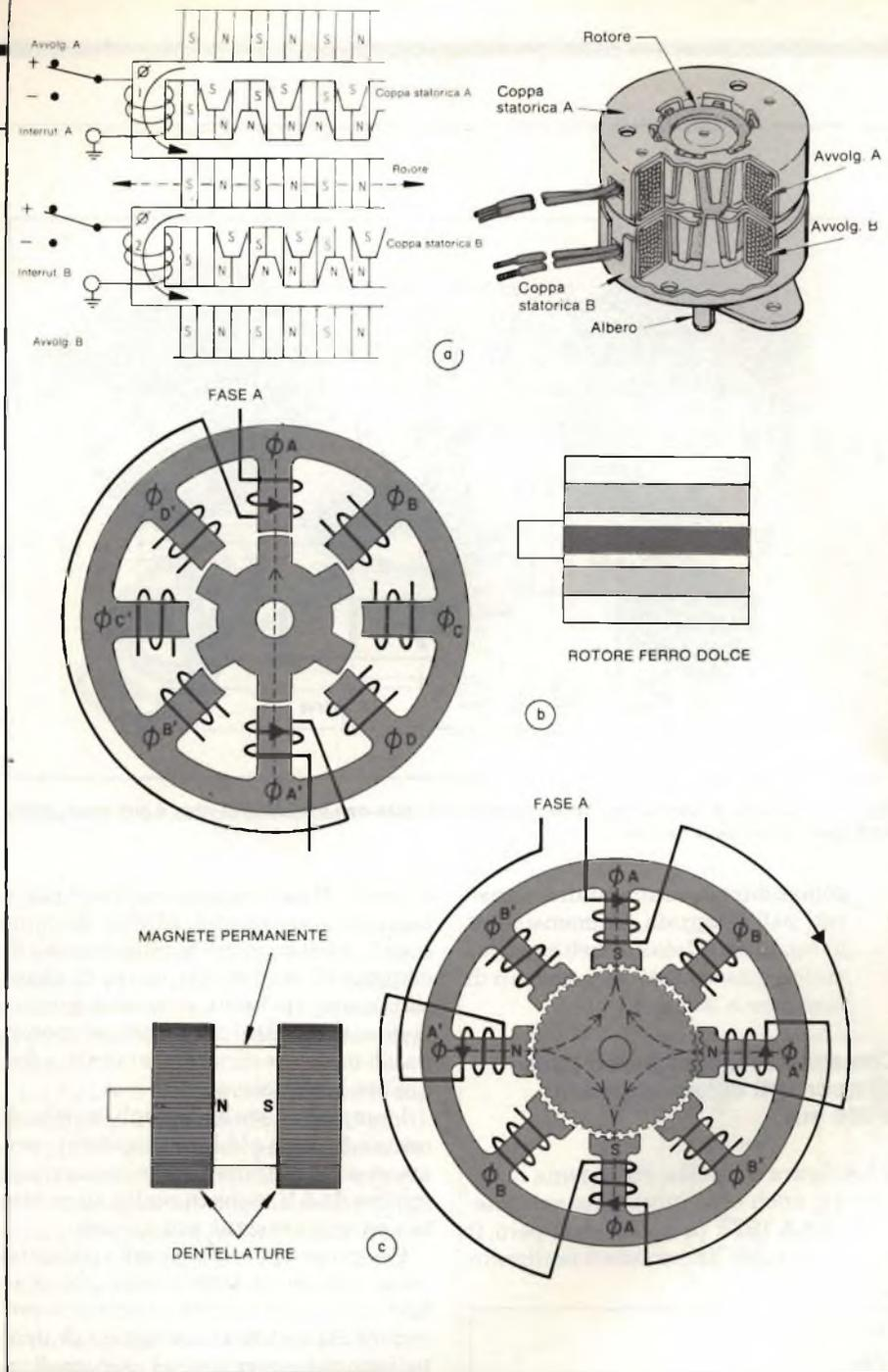
ti dai loro costruttori in una grande varietà di valori di frequenza di passo, che può infatti arrivare fino a 25 kHz (e cioè 25.000 passi di angolo al secondo). Anche il valore della coppia dinamica (o momento della coppia) può assumere un notevole spettro di valori che possono andare, per esempio, fino a 280 mNm ( $Nm = \text{Newton per metro}$ , unità di misura di una coppia, e cioè forza x spostamento;  $mNm = \text{millinewtonmetro}$ ).
