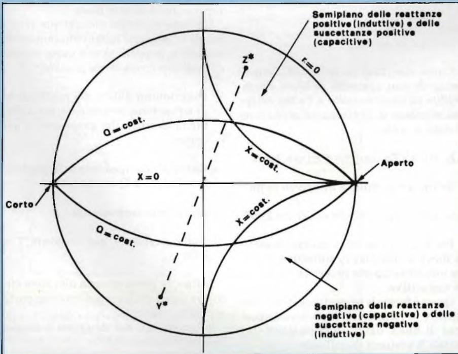
Fig. 5 - La carta delle impedenze è rappresentata da una serie di cerchi sovrapposti al diagramma polare di fig. 4 e aventi come parametri la resistenza normalizzata  $r = R/Z_0$  e la reattanza normalizzata  $x = X/Z_0$ . Per passare da un punto della carta delle impedenze  $Z^*(r^*, x^*)$  al corrispondente punto della carta delle ammettenze  $Y^*(g^*, b^*)$  si determina il simmetrico rispetto al centro.
