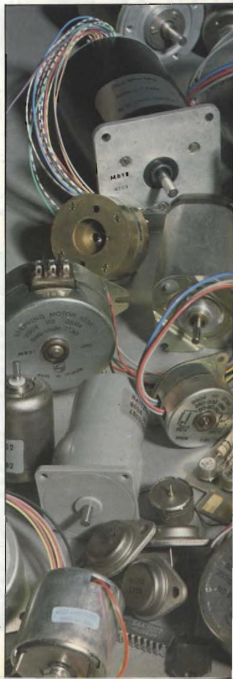
Fig. 1 - Tipici motori in continua e passo-passo.
