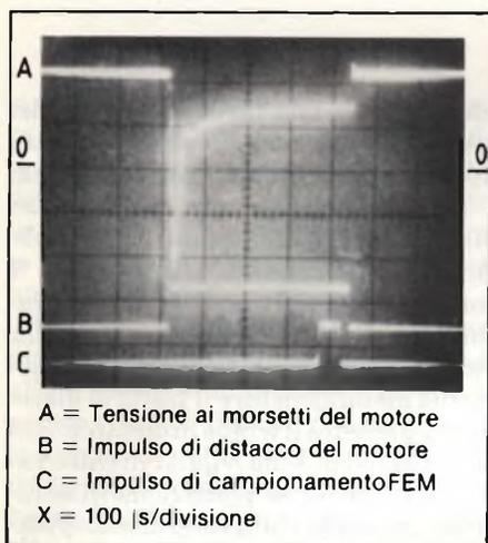
Fig. 7 - Andamento degli impulsi del generatore di clock.
