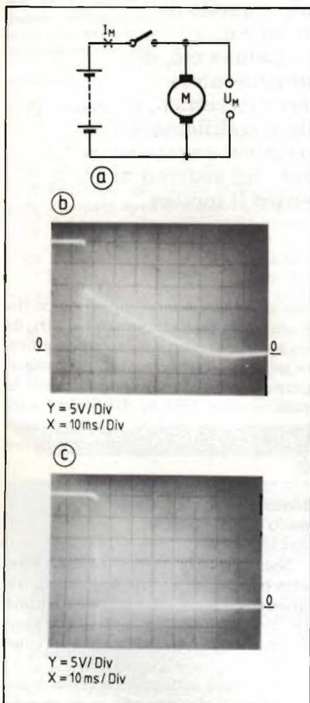
**Fig. 3 - Misura della forza controelettrica:** a) Dopo l'interruzione dell'alimentazione il motore si deve scaricare elettricamente del tutto, b) Comportamento della tensione ai morsetti di un motore caricato e quindi percorso da corrente, che continui a girare dopo il momento dell'interruzione dell'alimentazione, c) il comportamento della tensione ai morsetti ad albero motore bloccato.
