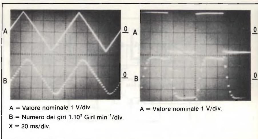
Fig. 8 - Risposta alle variazioni del numero di giri, misurata sul condensatore - memoria 7, per funzioni nominali a forma triangolare o quadra. Le variazioni del valore effettivo, dipendenti dagli impulsi di sincronismo ed a forma di gradini, sono chiaramente riconoscibili.
