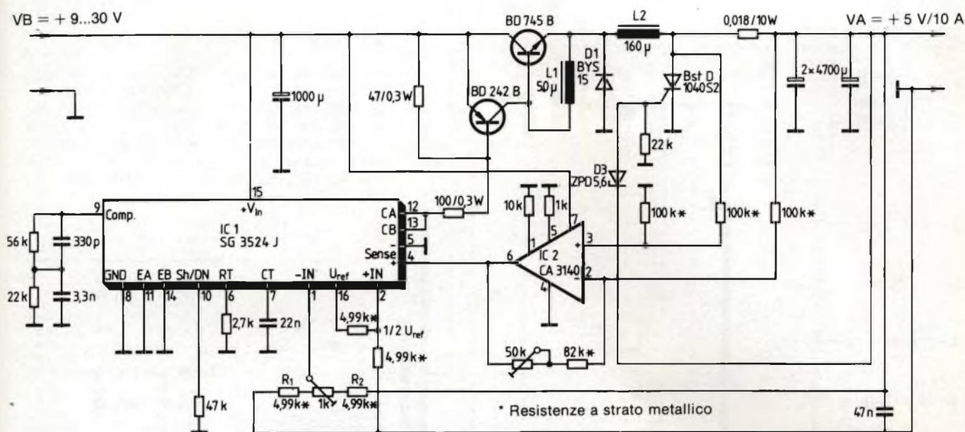
Fig. 2 - Schema completo del convertitore da +5V.
