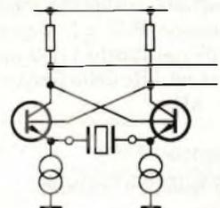
Fig. 5 - Schema di principio dell'oscillatore quarzato nella versione pratica del circuito.
