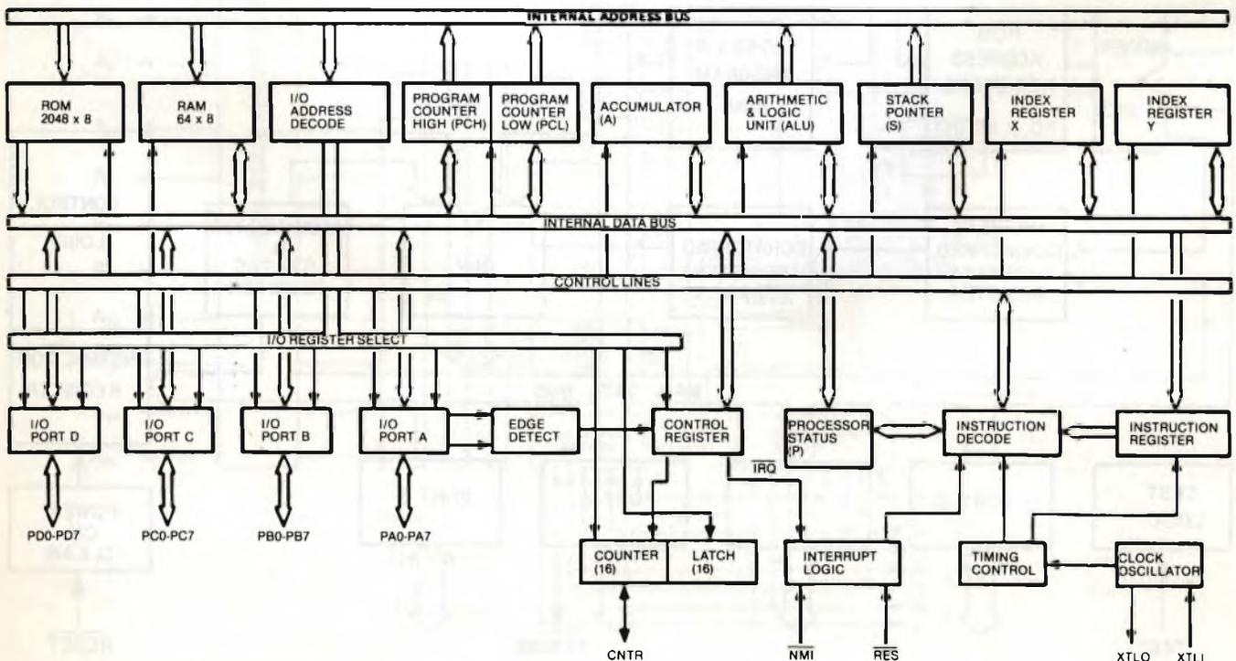
Fig. 7 - Architettura Interna del single chip 6500/1.
