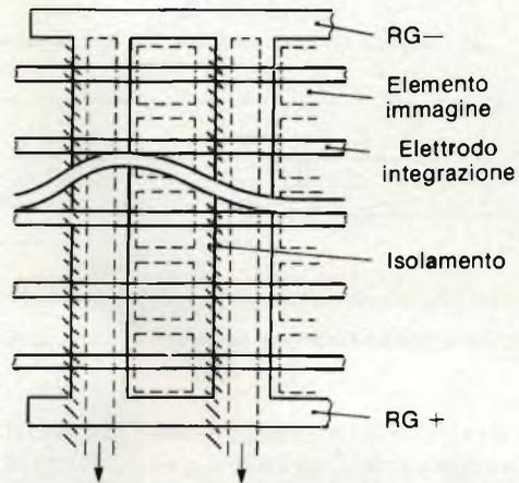
Fig. 2 - Struttura della matrice del sensore RGS.
