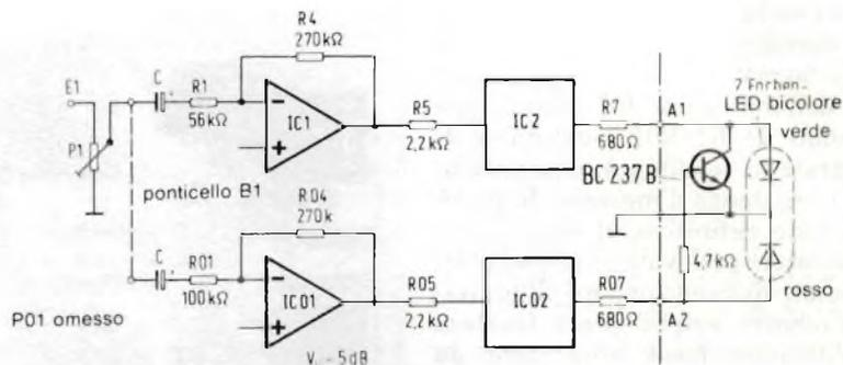
Fig. 3. Ecco una soluzione particolarmente elegante: vengono indicati separatamente due livelli che differiscono tra loro di 5 dB: perciò la luce verde significherà "pilotaggio corretto" e la luce rossa indicherà "sovrapiilotaggio". Il transistor e il suo resistore di base dovranno essere montati fuori dal circuito stampato.
