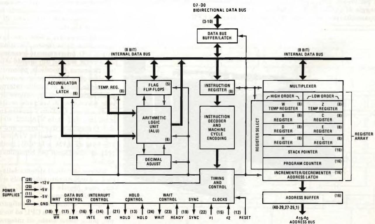
Fig. 2 - Architettura interna della CPU 8080A.
