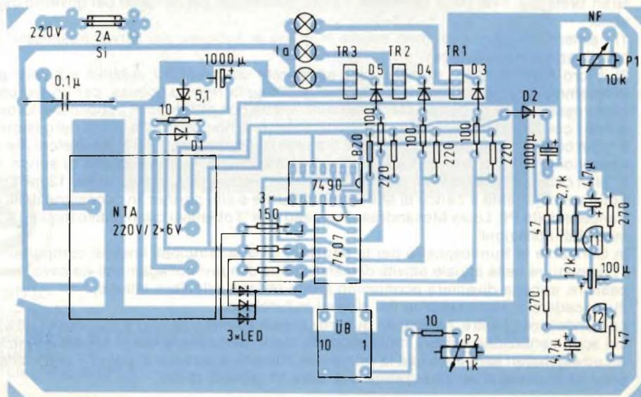
Fig. 2. Disposizione dei componenti sul circuito stampato.
