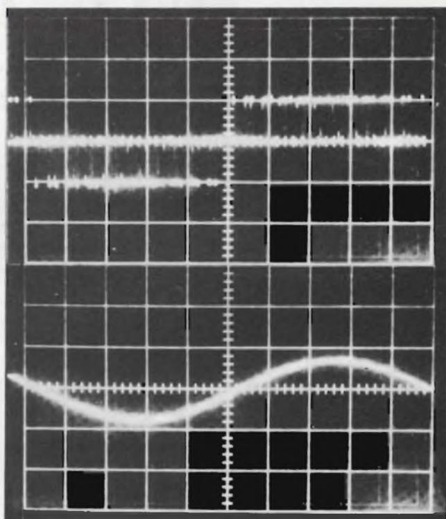
Fig. 5 - Forme d'onda delle tensioni a 50 Hz, da fase a fase, presenti rispettivamente all'ingresso e all'uscita del filtro.
