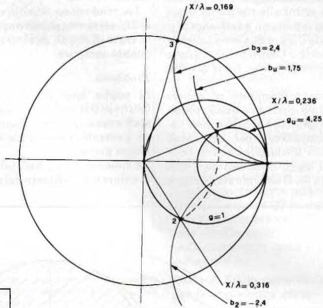
Fig. 6 - Il valore della reattanza presentata da uno stub in corto circuito varia con la sua lunghezza secondo l'andamento  $x = R_0 \operatorname{tg} \beta x$ . Sono da evitare le lunghezze  $x$  prossime a multipli dispari di  $\lambda/4$ , poiché la reattanza, molto variabile con la lunghezza e perciò anche con la frequenza, determina bande passanti molto strette.
