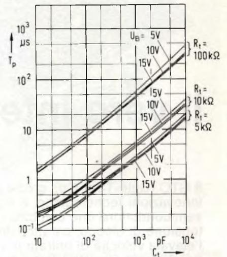
Fig. 3. Diagramma della durata degli impulsi d'uscita T<sub>p</sub>, in funzione della capacità del condensatore C<sub>t</sub>.
