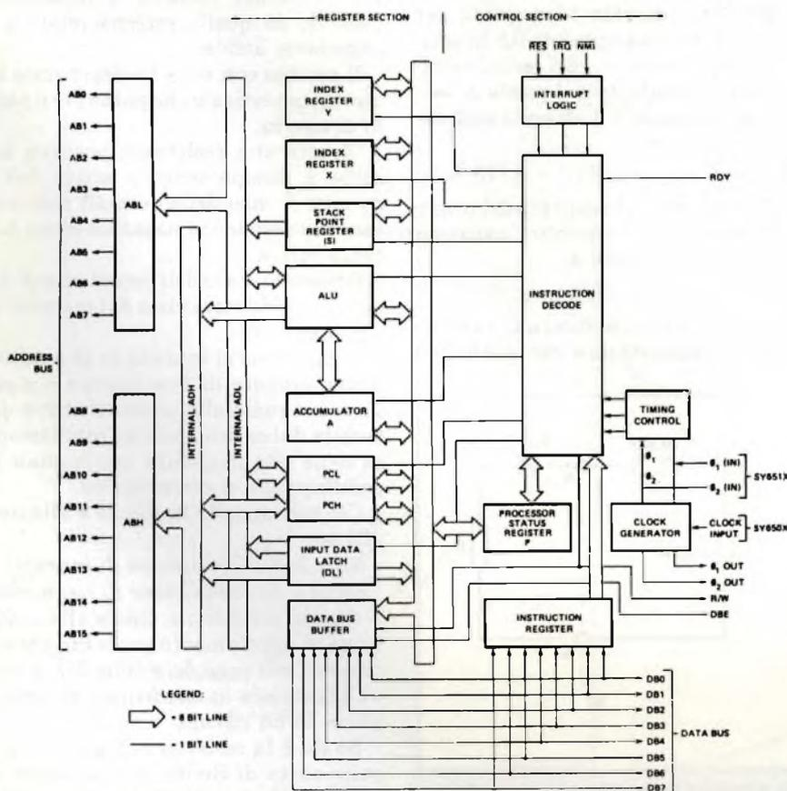
Fig. 1 - Architettura interna della CPU della famiglia 6500.
