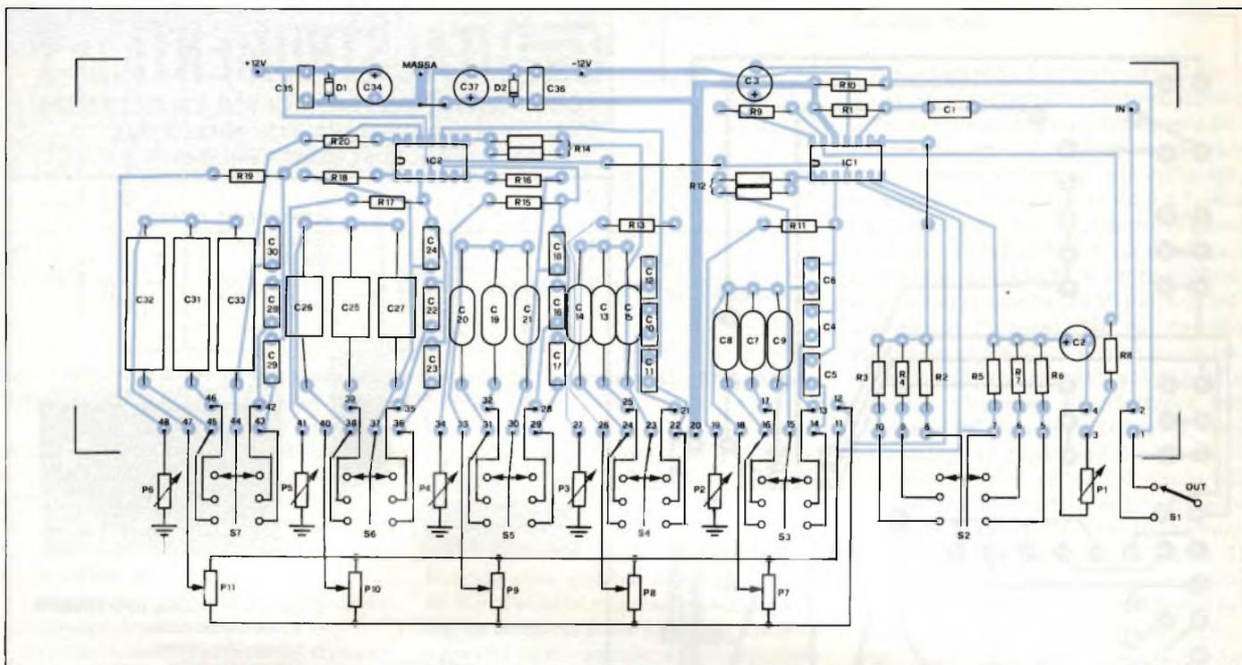
Fig. 9 - Disposizione componenti e collegamenti esterni dell'equalizzatore.
