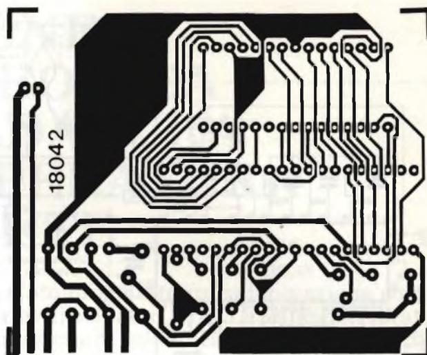
Fig. 2. Circuiti stampati della stazione di saldatura.
