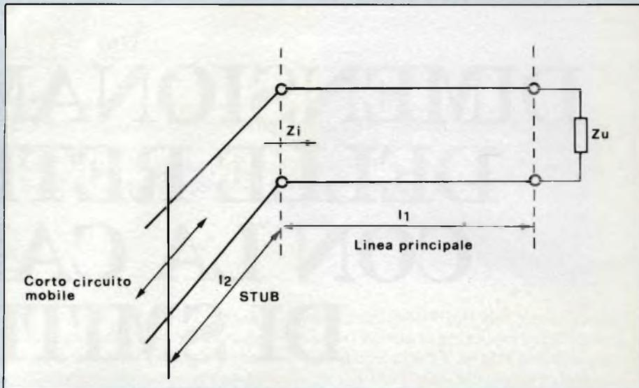
Fig. 3 - Rete di adattamento con semplice stub. Regolando le lunghezze  $l_1$  ed  $l_2$  delle linee principale e ausiliaria è possibile adattare l'impedenza di carico  $Z_u$  non puramente resistiva alla resistenza caratteristica  $R_o$  del cavo.
