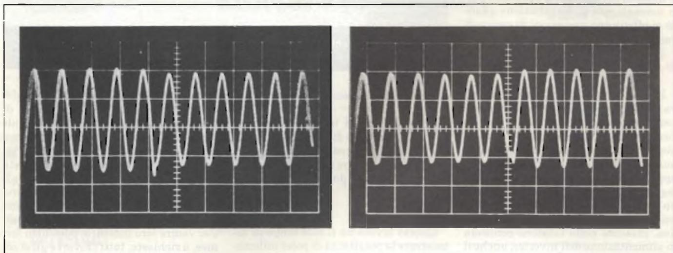
Fig. 12 - Transitorio presente sulla tensione di uscita del gruppo nel caso in cui si passi dal massimo carico al 50% del medesimo. (a) Passaggio da metà carico a carico massimo; (b) da carico massimo a metà carico. Scala verticale: 100 V/divisione.
