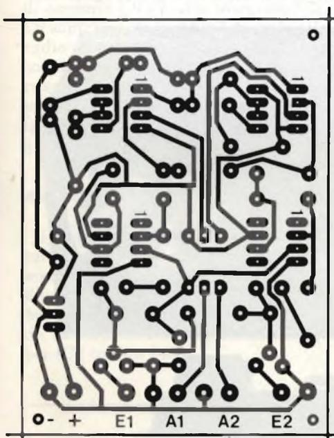
Fig. 4. Circuito stampato per la costruzione dell'indicatore del valore di picco.
