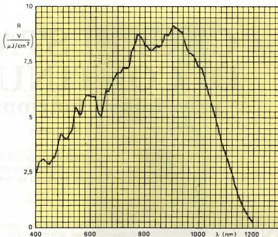
Fig. 11 - Curva di risposta spettrale del sensore RGS.
