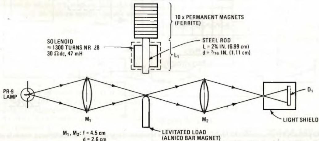
Il circuito (a) è in grado di tenere sospesa fino a 2,5 mm dalla superficie di riferimento, una sfera di acciaio di 2,54 mm di diametro. Il sistema ottico (b) definisce la distanza dell'oggetto. Il valore definitivo della distanza si ottiene agendo sui magneti permanenti.
