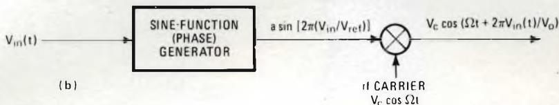
Un semplice sommatore (a) può realizzare un generatore di forme d'onda rettangolari o sinusoidali. (b) Scegliendo opportunamente le soglie di intervento dei comparatori è possibile ottenere in uscita una forma d'onda sinusoidale. Il circuito può quindi essere impiegato per modulare in fase e frequenza una portante a radio frequenza.
