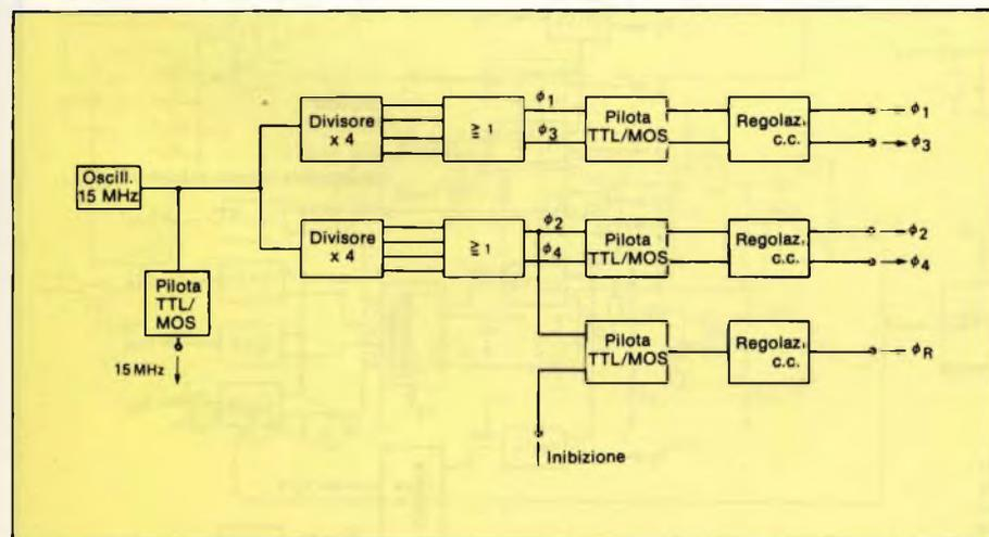
Fig. 3 - Schema a blocchi del generatore che produce gli impulsi Ø di trasferimento all'esterno delle cariche-immagine prodotte all'interno del chip.
