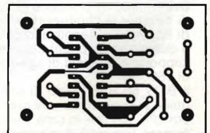
Fig. 5. Basetta stampata adatta al montaggio del piccolo circuito.
