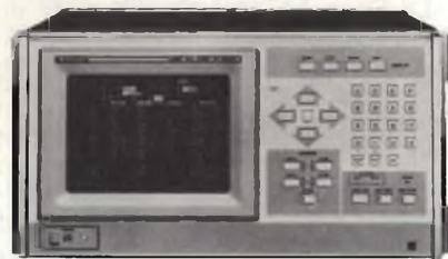
Logic analyzer a 32 canali
