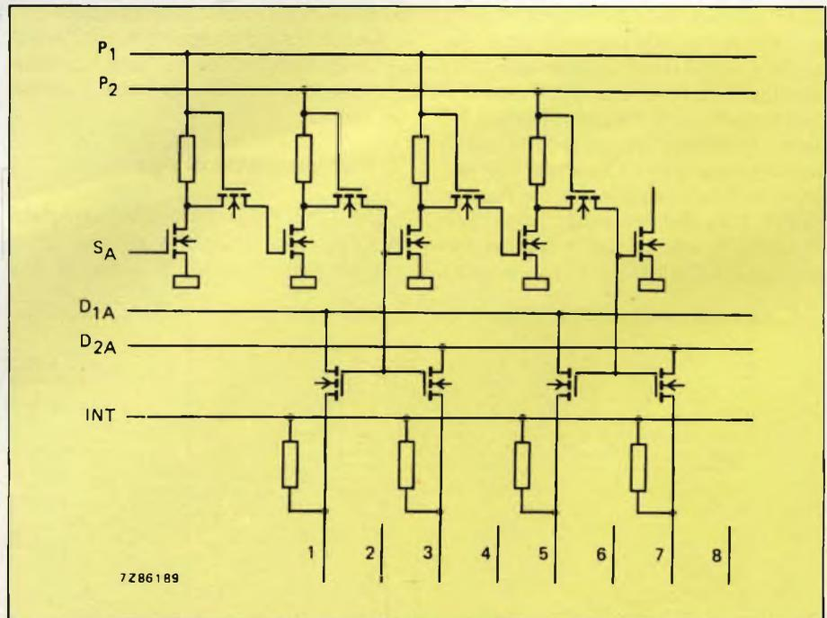
Fig. 3 - Circuito di indirizzamento di riga (registro A).
