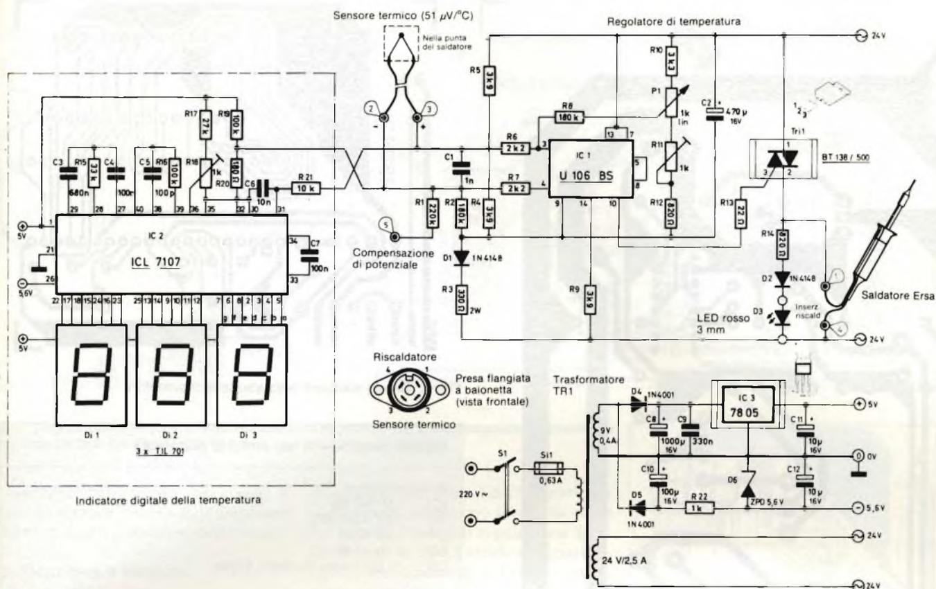
Fig. 1. Schema elettrico della stazione di saldatura elettronica.
