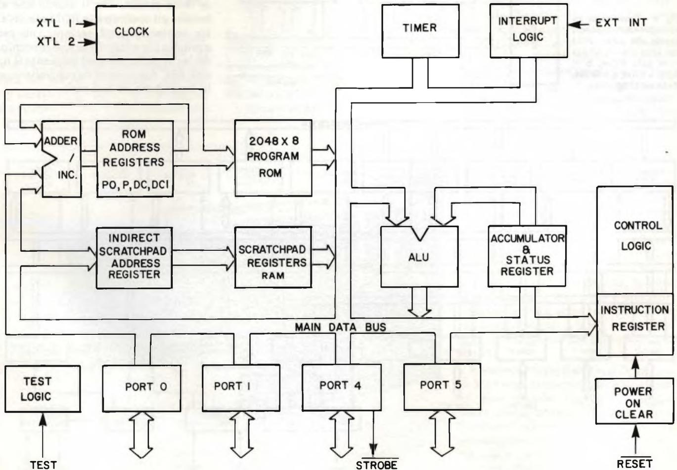
Fig. 9 - Architettura interna del single chip 3870.
