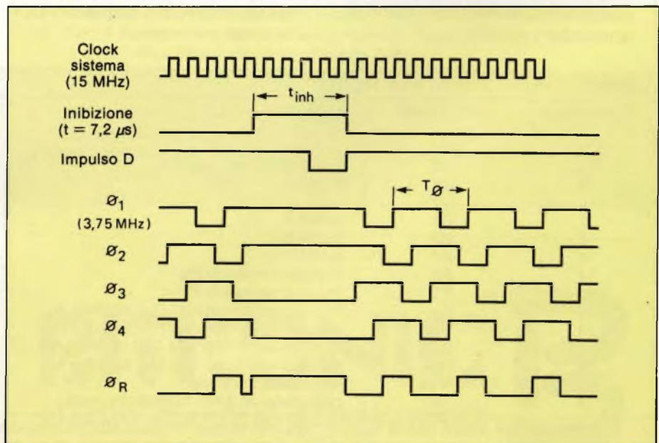
Fig. 8 - Impulsi di temporizzazione per lettura diretta.
