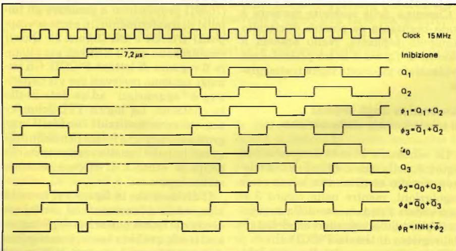
Fig. 5 - Andamento degli impulsi forniti dal circuito di figura 4.
