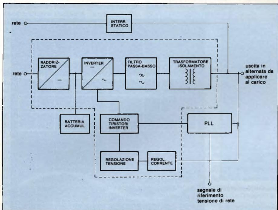
Fig. 1 - Schema a blocchi di un gruppo di continuità convenzionale.
