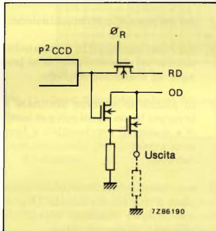
Fig. 7 - Uscita a source follower del P<sup>2</sup>CCD.
