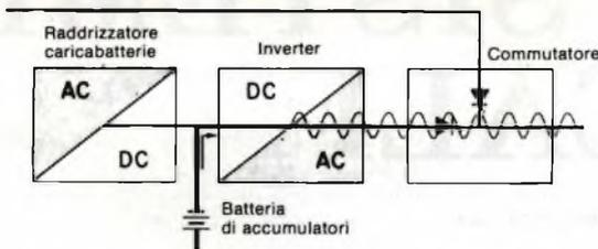
Fig. 2 - E' venuta a mancare la tensione della rete. L'invertitore viene alimentato dalla tensione continua fornita dagli accumulatori.
