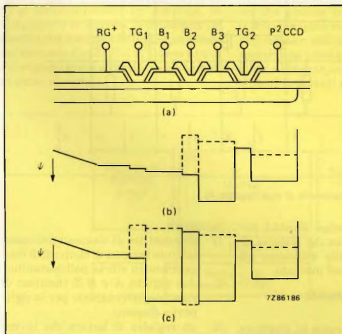
Fig. 5a - Struttura del buffer; (b) contorno del potenziale nel caso di lettura diretta; (c) contorno del potenziale nel caso di lettura interfacciata.
