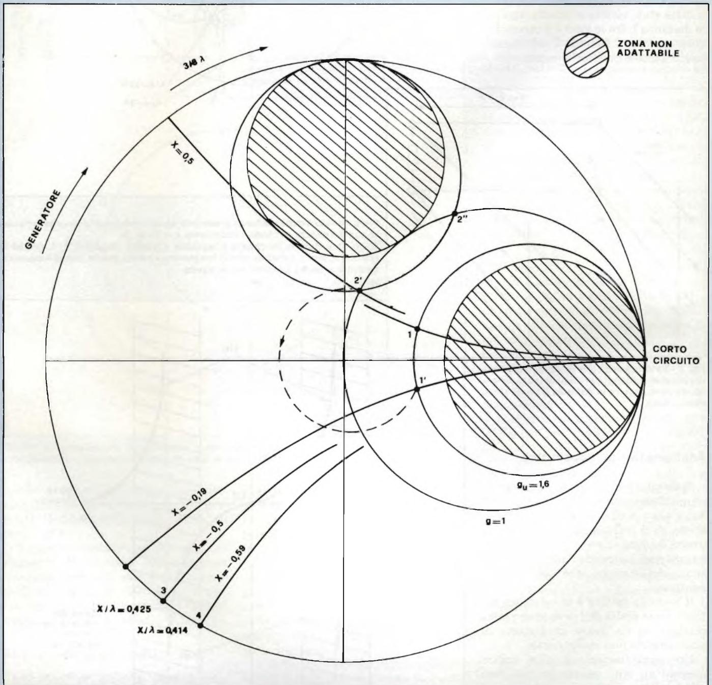
Fig. 7 - L'adattamento a doppio stub visto sulla carta di Smith.
