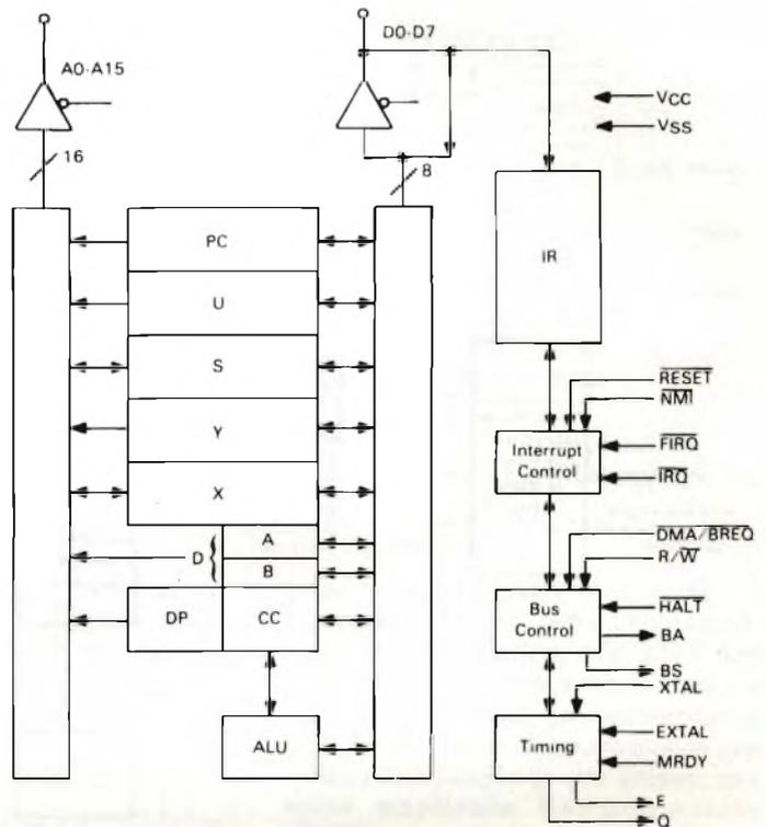
Fig. 3 - Architettura interna della CPU 6809.
