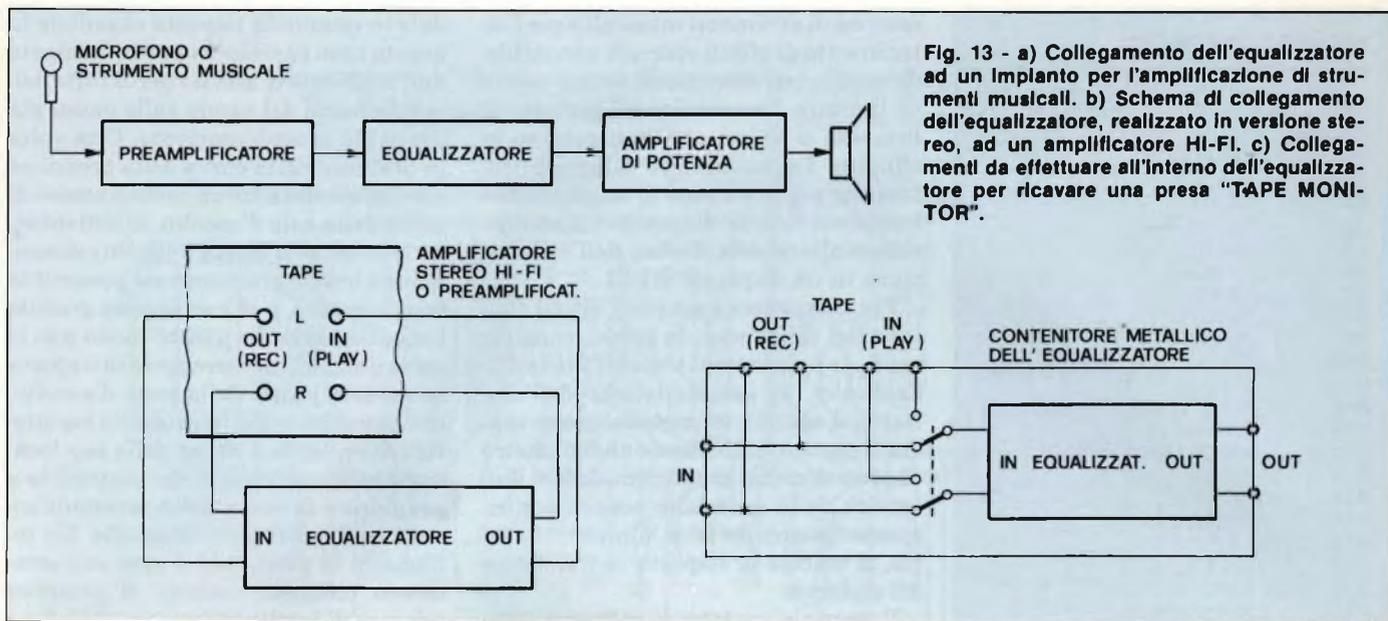
Fig. 13 - a) Collegamento dell'equalizzatore ad un impianto per l'amplificazione di strumenti musicali. b) Schema di collegamento dell'equalizzatore, realizzato in versione stereo, ad un amplificatore HI-FI. c) Collegamenti da effettuare all'interno dell'equalizzatore per ricavare una presa "TAPE MONITOR".
