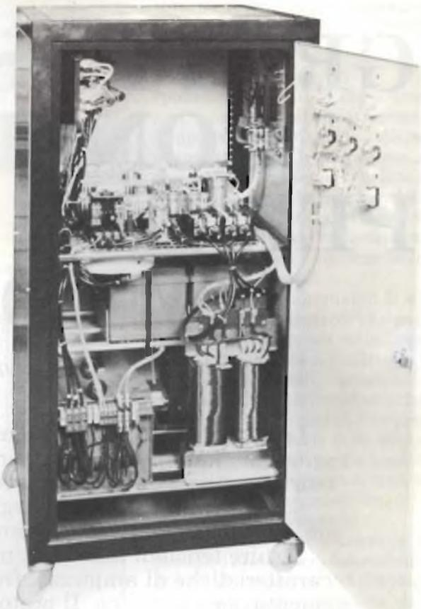
dai cosiddetti *gruppi statici di alimentazione* nei quali la tensione della rete, opportunamente raddrizzata, viene utilizzata in parte per mantenere permanentemente a piena carica una batteria di accumulatori, ed in parte per alimentare un invertitore che provvederà a ricostruire una tensione alternata (monofase o trifase) avente le stesse caratteristiche di quella della rete.
