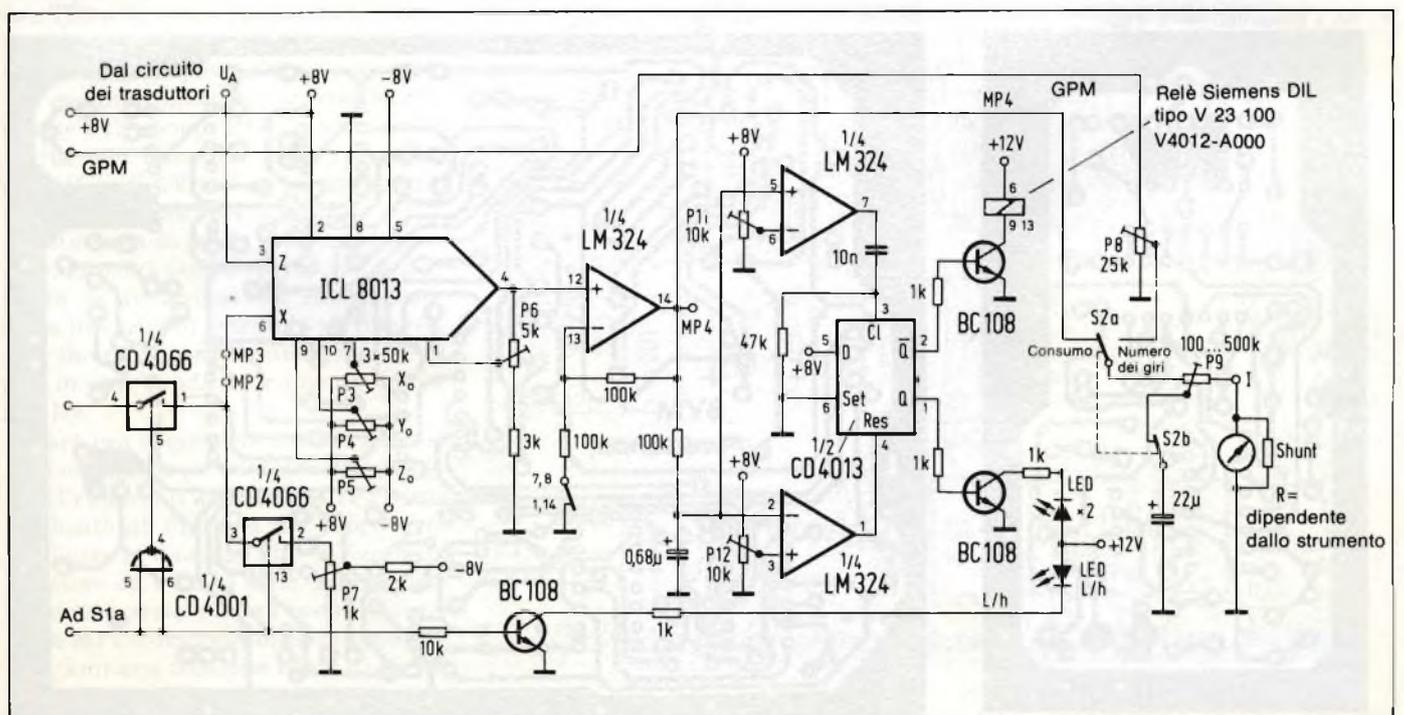
Fig. 5. Schema completo del moltiplicatore analogico ICL 8013.
