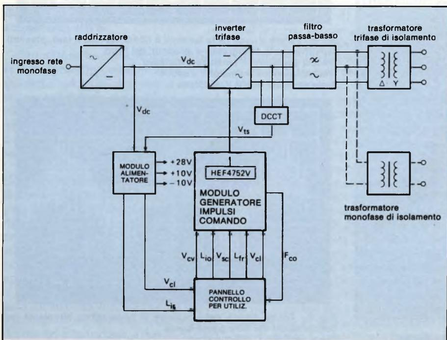
Fig. 2 - Schema a blocchi di un gruppo di continuità basato sull'impiego dell'integrato dedicato HEF4752V. Questo integrato è in grado di fornire treni di impulsi di comando agli "interruttori" (tristori o transistori) dell'inverter; i treni d'impulsi sono modulati in ampiezza (sistema PWM), e fanno pertanto circolare nel carico correnti con andamento sinusoidale.
