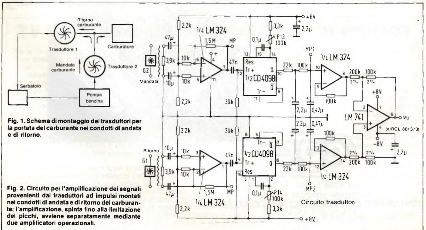
Fig. 1. Schema di montaggio dei trasduttori per la portata del carburante nei condotti di andata e di ritorno.
