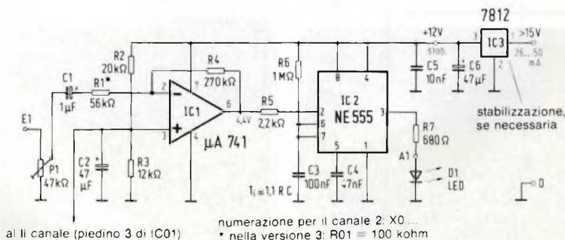
Fig. 1. Regolatore di livello, amplificatore, multivibratore monostabile e visualizzatore compongono questo indicatore dei picchi di segnale
