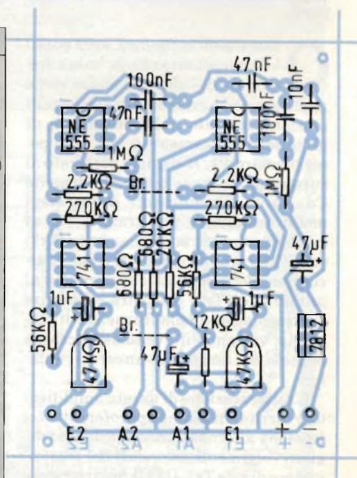
Fig. 5. Disposizione dei componenti sul circuito stampato di fig. 4.
