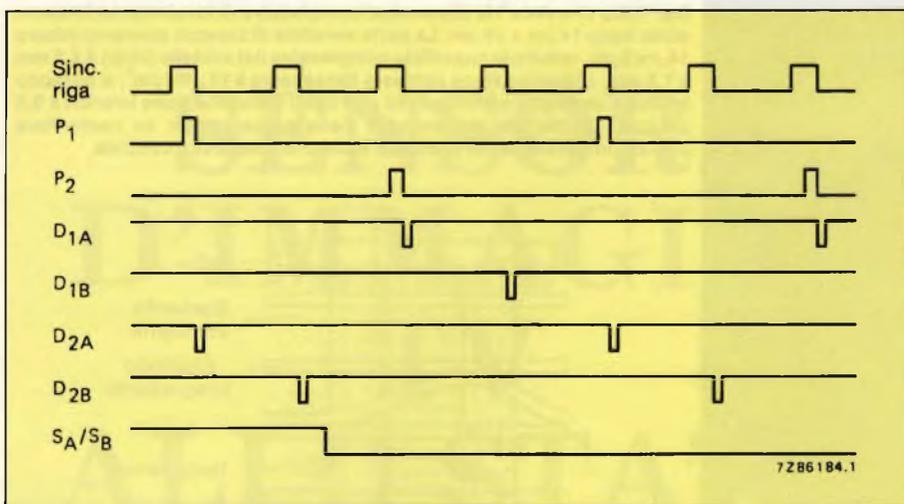
Fig. 4 - Segnali di temporizzazione necessari all'indirizzamento della riga.
