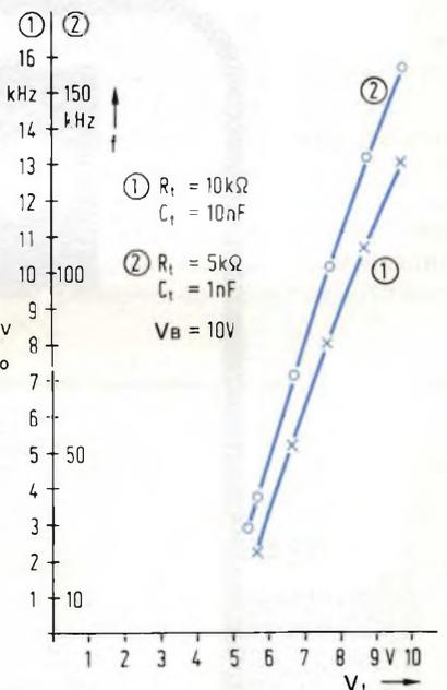
Fig. 4. Due curve ricavate da misure, che mostrano l'andamento della frequenza in funzione della tensione di pilotaggio.
