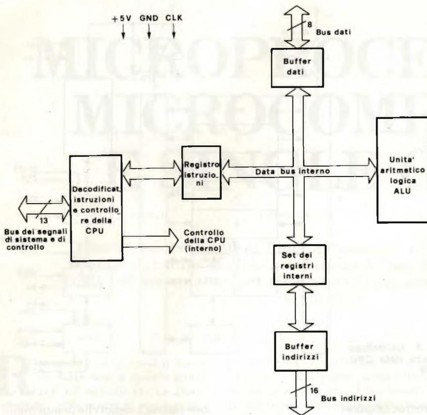
Fig. 4 - Architettura interna della CPU Z80A.
