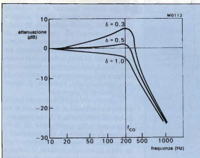
Fig. 3 - Curva di risposta del filtro (a sezione L) alle tensioni alternate di piccola ampiezza.
