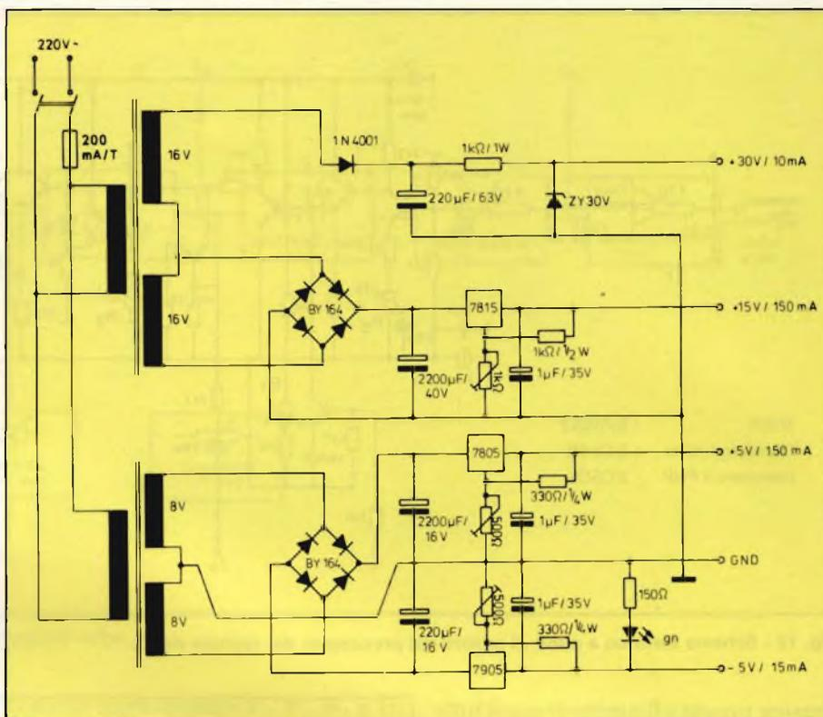
Fig. 14 - Sistema di alimentazione delle piastre.
