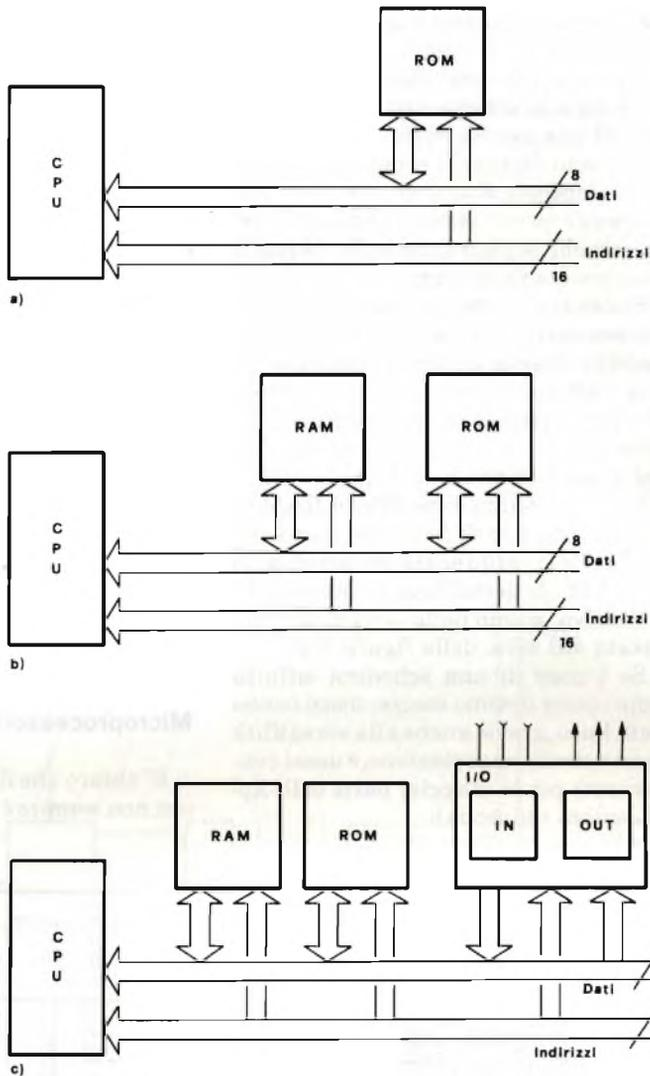
Fig. 5 - Crescita di un microsistema, aggiungendo alla sola CPU i vari chip di supporto (a = la sola ROM; b = ROM e RAM; c = ROM, RAM ed I/O).
