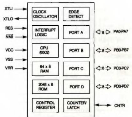
Fig. 6 - Dispositivi incorporati nel single chip 6500/1.
