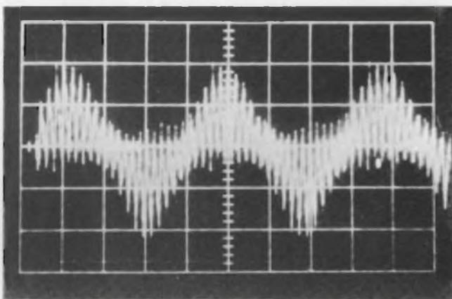
Fig. 6 - Forme d'onda della corrente di ondulazione circolante nei condensatori del filtro passa-basso.
