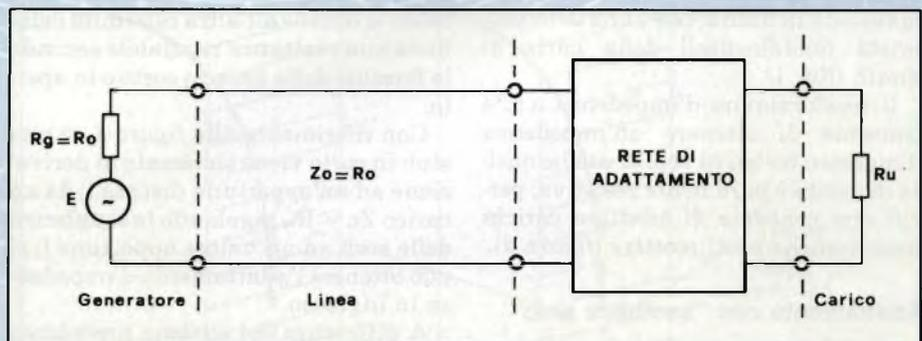
Fig. 1 - La rete di adattamento interposta fra il cavo e il carico consente di ottenere il massimo trasferimento di potenza dal generatore al carico ed evita la formazione sulla linea di onde stazionarie.
