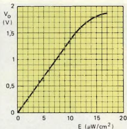
Fig. 9 - Tipica caratteristica di trasferimento del sensore RGS. T = 2856 K.
