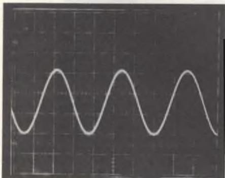
Fig. 2. Segnale presente all'ingresso ed al terminale di source (15 kHz).
