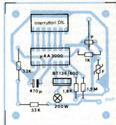
Fig. 4 - Disposizione dei componenti sul circuito stampato. Gli interruttori S1...S6 potranno consistere, a scelta, in semplici ponticelli di filo, oppure in una serie di interruttori DIL.
