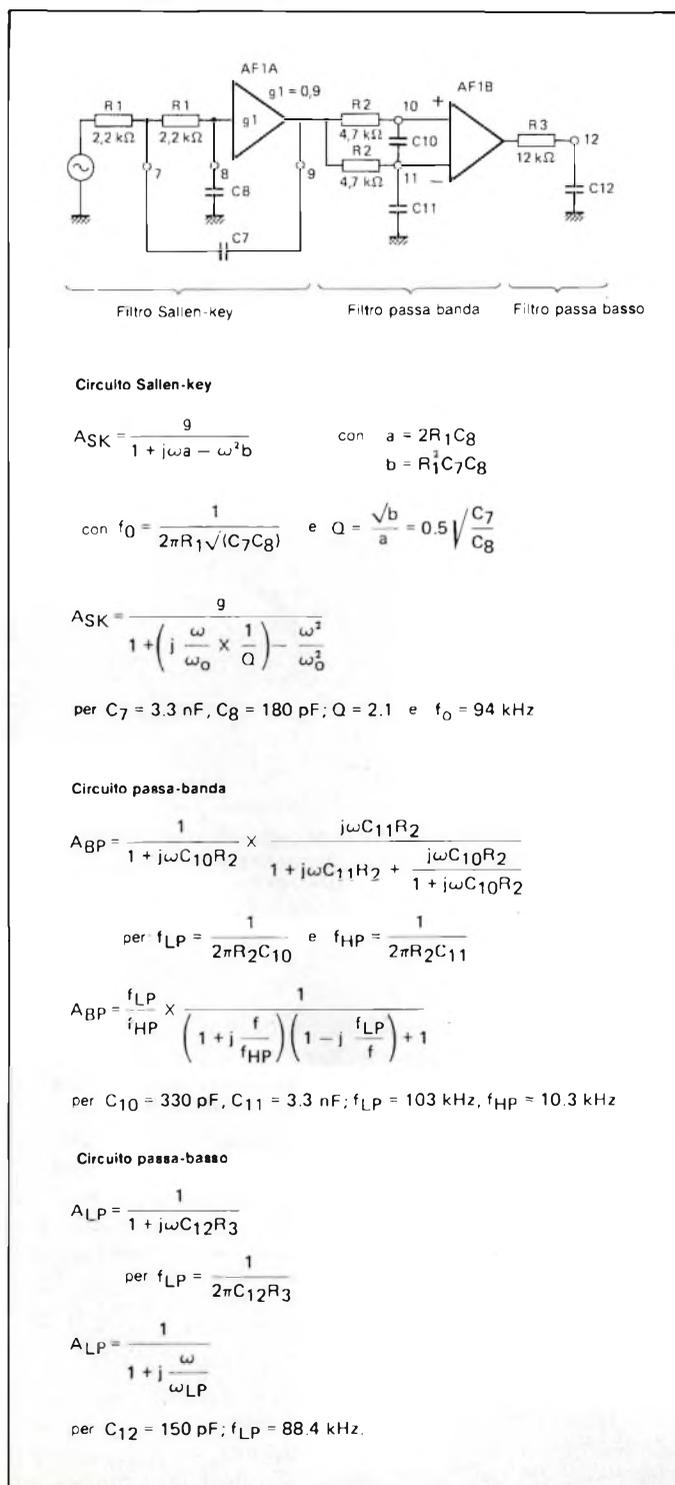
**Fig. 2 - Filtro attivo per l'accordo del segnale della frequenza intermedia nel TDA 7000.** Sono indicate anche le formule utilizzate per il dimensionamento del circuito rispettivamente Sallen-Key, del circuito passa-banda e del circuito passa-basso.
