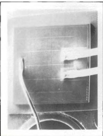
Fig. 4 - I contatti degli elettrodi vengono saldati sul chip mediante ultrasuoni (a sinistra, il contatto del gate, a destra il contatto della source).
