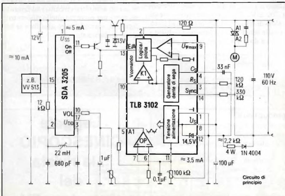
Fig. 6 - Sistema di controllo dei giri di un motore a parzializzazione di fase (TLB 3102) attivato mediante telecomando a raggi infrarossi (SDA 3205).
