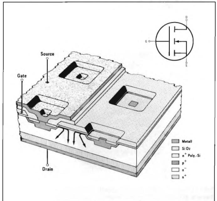
Fig. 1 - Simbolo e struttura del chip di un transistor SIPMOS. Questi transistori vengono costruiti utilizzando la tecnologia planare del silicio.
