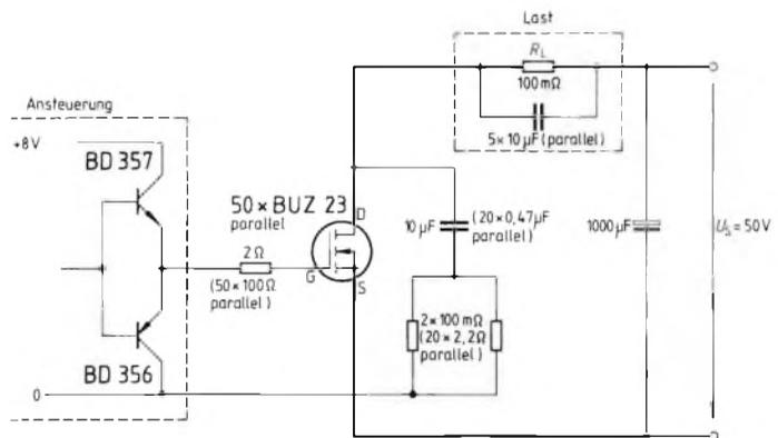
Fig. 1 - Schema dell'interruttore statico di potenza da 500 A realizzato con 50 SIPMOS BUZ 23.
