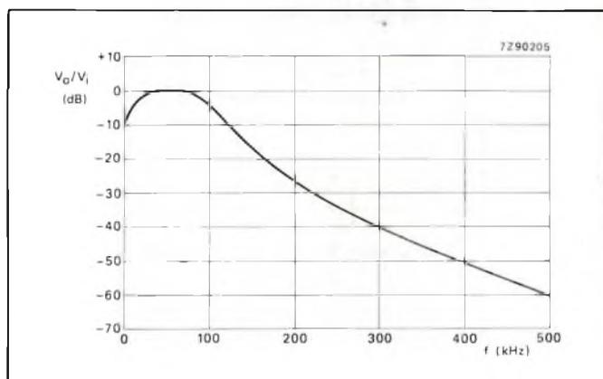
**Fig. 3 - Curva di risposta del filtro attivo i.f.**
