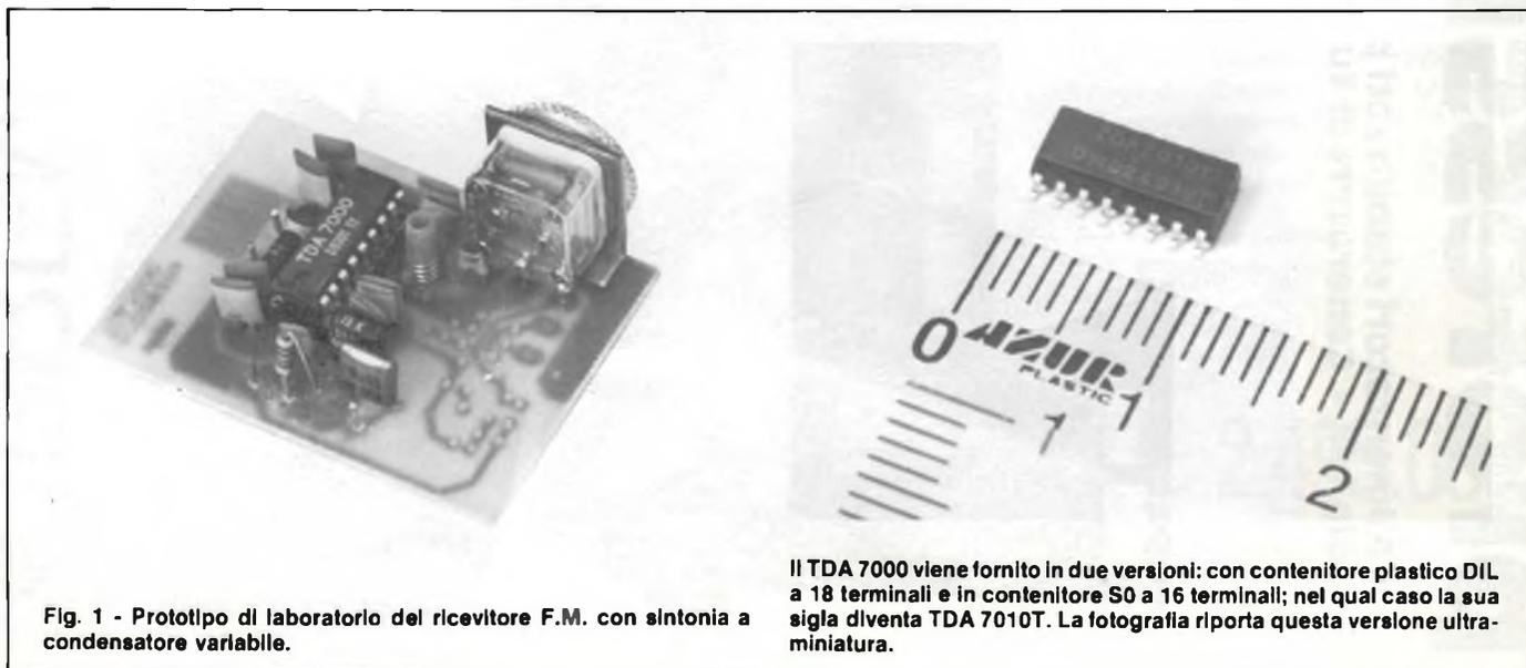
Fig. 1 - Prototipo di laboratorio del ricevitore F.M. con sintonia a condensatore variabile.
