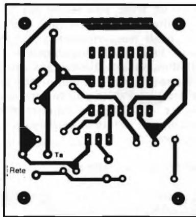
Fig. 3 - Piste di rame del circuito stampato
