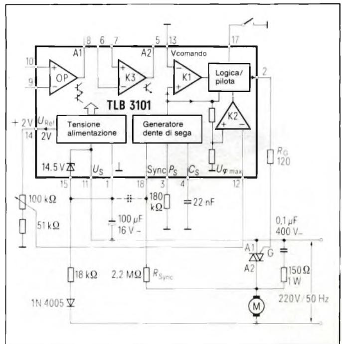
**Fig. 2 - Circuito per la sincronizzazione della corrente e ripetizione dell'impulso di innesco.**
