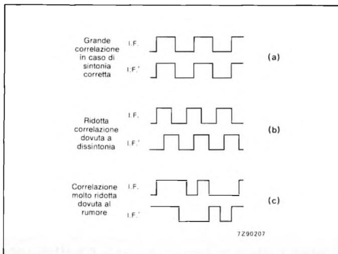
**Fig. 7 - Meccanismo di funzionamento del sistema di taclitazione a correlazione.**
