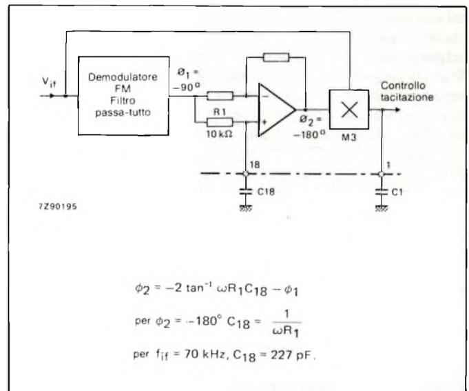
**Fig. 8 - Struttura di principio del correlatore incorporato nel TDA 7000.**
