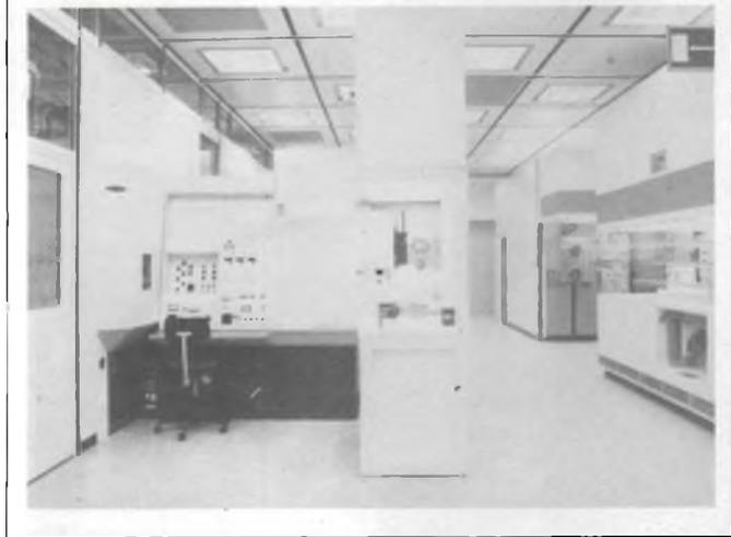
Fig. 5 - Gli ambienti dove vengono preparati i chip non devono contenere pulviscolo atmosferico.
