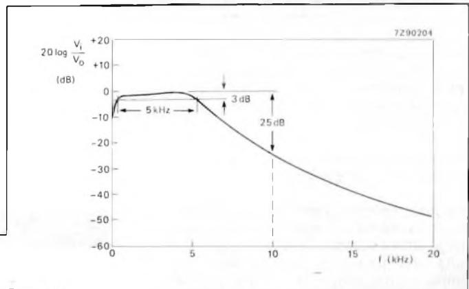
Fig. 9 - Curva di risposta (solo una metà) della i.f. del ricevitore F.M. a banda stretta di figura 9.
