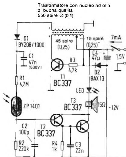
**Nuova versione del contatore di Geiger Mueller.** Il tubo contatore ZP 1401 è la versione, sensibile ai raggi alfa, dello ZP 1400. D1 deve essere un diodo veloce che possa resistere ad una tensione di 1000 V. Questa versione, che utilizza un'alimentazione di 1,5 V, è particolarmente adatta per un apparecchio portatile.
