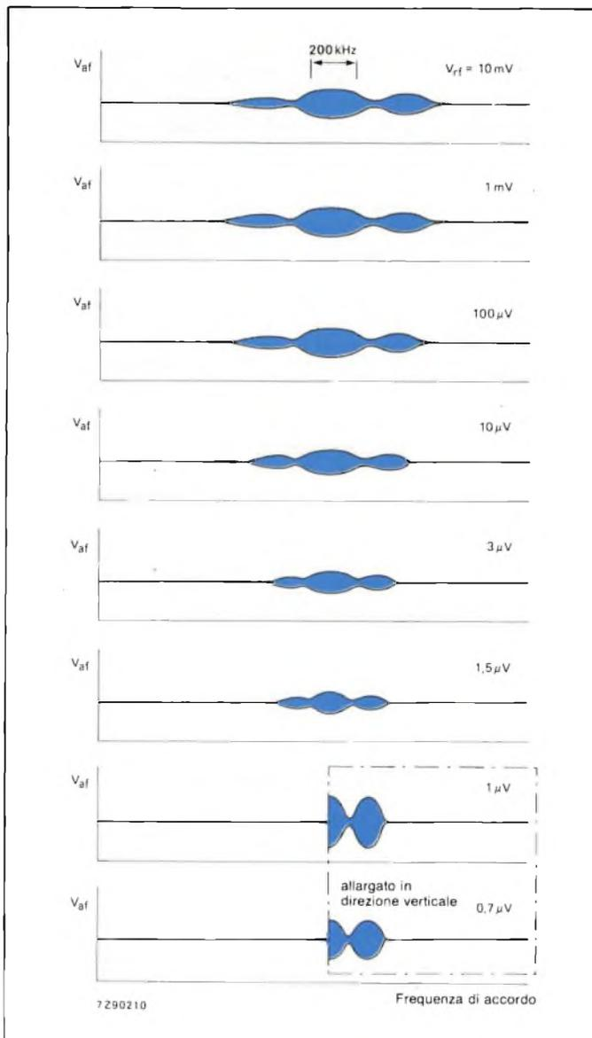
**Fig. 6 - Segnale audio di uscita di un tipico radiorecettore portatile in funzione della frequenza di sintonia per differenti livelli del segnale d'ingresso d'antenna. La frequenza e l'ampiezza del segnale modulante sono, in questo caso, fisse.**
