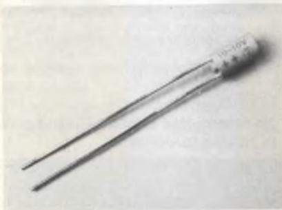
*Condensatore ad elettrolita solido che trova largo impiego nel campo delle telecomunicazioni, computer, apparecchiature audio e video, autoradio e autonica.*
