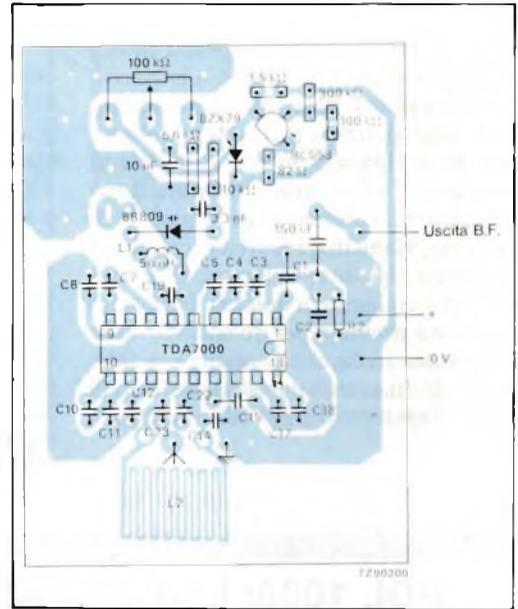
Fig. 6 - Struttura del circuito stampato visto dalla parte dei componenti nel ricevitore di fig. 7. La struttura del rame dello stampato è identica a quella riportata in figura 3.
