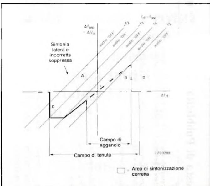
Fig. 10 - Risposta del circuito FLL con anello chiuso. La pendenza della retta che si ha in corrispondenza di una corretta sintonizzazione è tale che una deviazione di  $\pm 75$  kHz del segnale a radiofrequenza ( $f_r$ ), produrrà una deviazione di  $\pm 15$  kHz del segnale  $f_r - f_{osc}$ , e cioè del segnale a frequenza intermedia.
