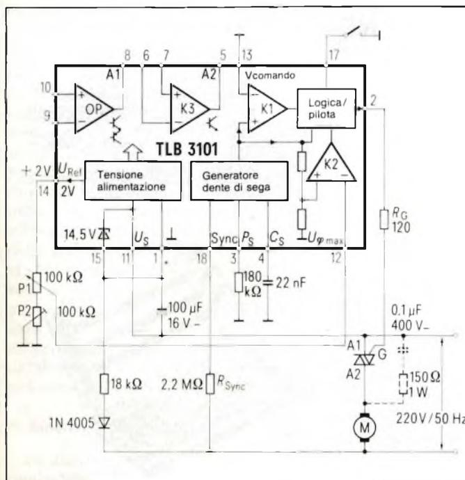
**Fig. 1a - Sistema di regolazione della potenza da rete mediante parzializzazione di fase realizzato con il TLB 3101. Questo circuito è il più semplice in quanto per la regolazione della potenza nel carico (in questo caso, un motore) viene utilizzato un numero ridotto di componenti. In questo e nei circuiti che seguono, il triac da impiegare dipenderà dalla potenza del motore. Così, potrà essere impiegato un TXD 10K 60 ( $I_{Teff} = 8$  A) oppure un TXC 10K60 ( $I_{Teff} = 4$  A).**
