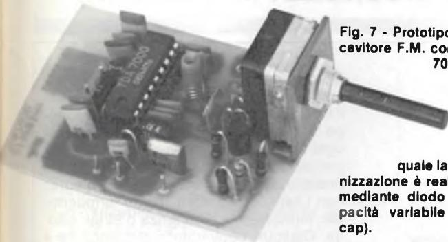
Fig. 7 - Prototipo di ricevitore F.M. con TDA 7000 nel
