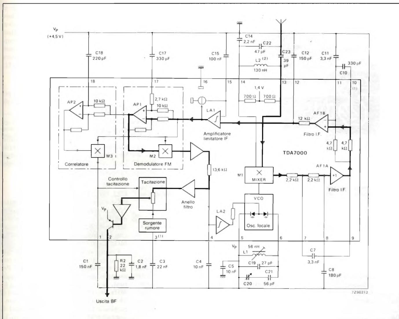
Fig. 2 - Schema elettrico del TDA 7000 e componenti esterni del ricevitore con sintonia a condensatore. 1) Questi terminali non vengono utilizzati nella versione in contenitore SO (TDA 7010T). AP = filtro passa-tutto. 2) Nel prototipo di laboratorio, fig. 1, la bobinetta L2 è ricavata dal rame dello stampato. L1 = Toko MC108 N. 514 HNE 150013S13. L2 = Toko N. 2A-15BT-R01.
