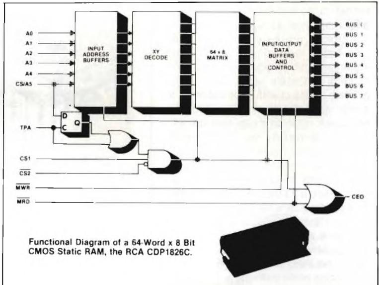
Il tempo di accesso tipico è di 500 ns. Il chip funziona in uno dei 3 modi: read, write o deselect. Nell'ultimo modo il dispositivo può ridurre il consumo a valori di assorbimenti di corrente da standby. I dati vengono mantenuti con tensioni di alimentazione che possono scendere fino a 2 V.
