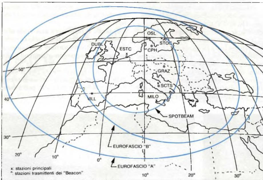
Fig. 6 - Aree di copertura delle antenne trasmettenti dell'OTS-2.
