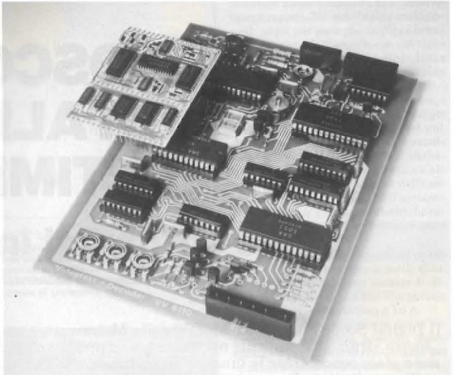
Questa foto indica uno degli obiettivi che si vuole raggiungere con l'introduzione dei componenti SMD e delle macchine per il montaggio automatico: ridurre del 50% (e anche di più) le attuali dimensioni delle piastre a circuito stampato montate nelle apparecchiature elettroniche. La foto indica le dimensioni assunte da una piastra di un decodificatore di segnali Videotext realizzata con componenti SMD.
