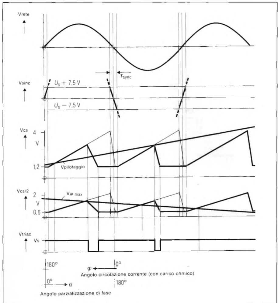
vole sfasamento tra tensione e corrente. Per evitare quindi che il triac lavori su una sola semionda dell'alternata della rete si provvede a collegare il resistore di sincronizzazione ( $R_{sync}$ ) con l'anodo A2 del triac come indicato in figura 2.
