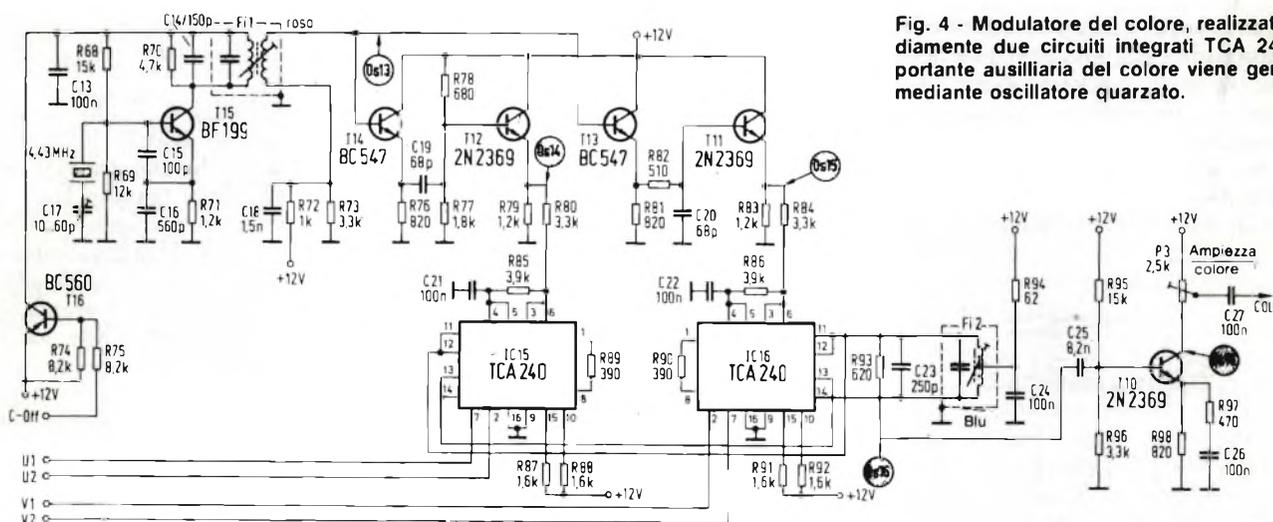
Fig. 4 - Modulatore del colore, realizzato mediante due circuiti integrati TCA 240. La portante ausiliaria del colore viene generata mediante oscillatore quarzato.
