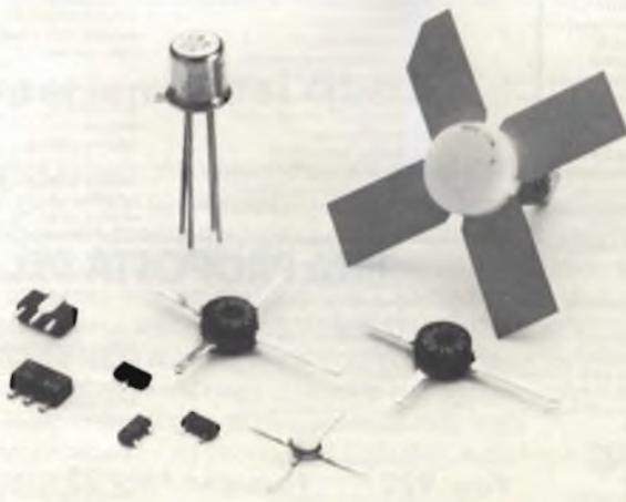
Transistori per alta frequenza studiati per l'impiego in sistemi di alta frequenza a larga banda.
