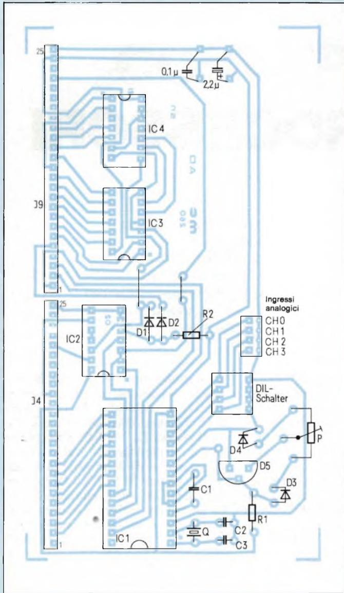
Fig. 4 - La disposizione dei componenti sulla scheda. Data l'elevata sensibilità delle entrate analogiche, è opportuno cortocircuitare quelle non utilizzate: a questo servono gli interruttori DIL, che possono essere omessi su tutte le entrate sono in funzione.
