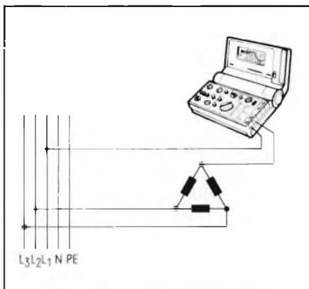
Fig. 4 - Il multimetro M 2050 permette di misurare la corrente di spunto di un motore trifase collegato a un triangolo a tensione anche se la misura deve essere effettuata sul conduttore "caldo".
