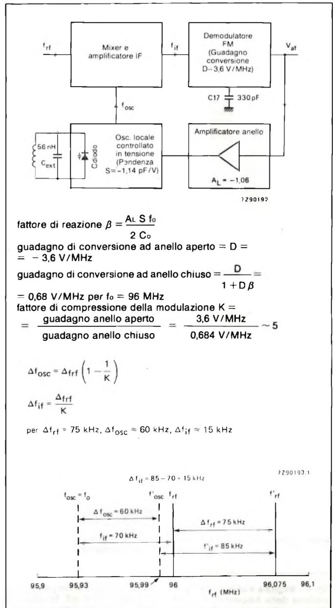
Fig. 5 - Sistema adottato per comprimere la variazione di frequenza (Δf) del segnale a frequenza intermedia. Il sistema è basato su un anello di controllo di frequenza FLL. C<sub>o</sub> = C<sub>ext</sub> + C<sub>dilpersa</sub> + C<sub>diodo</sub> con anello aperto = 49 pF con f<sub>o</sub> = 96 MHz
