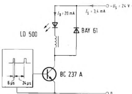
**Fig. 1 - Schema del circuito di alimentazione di un LED mediante una tensione a 24 V. Questo circuito di adattamento è a basse perdite. Via via che aumenta la tensione di alimentazione la durata dell'impulso di comando (in questo caso 6 μs) tenderà a diminuire.**
