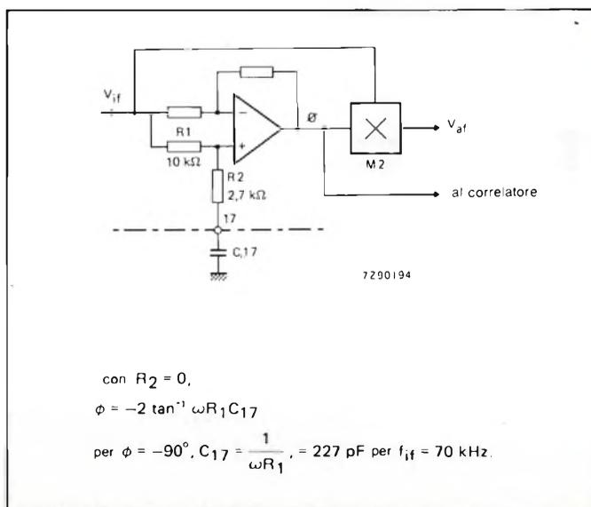
**Fig. 4 - Circuito sfasatore (filtro passa-tutto) richiesto dal demodulatore F.M..** Il resistore  $R_2$  è stato aggiunto per migliorare le prestazioni del filtro passa-tutto nei confronti della forma d'onda del segnale i.f. limitato in ampiezza. Siccome ciò influisce sull'angolo di fase, occorrerà aumentare nella misura del 50% anche il valore di  $C_{17}$ , e cioè, per  $f_{if} = 70$  kHz,  $C_{17}$  sarà 330 pF.
