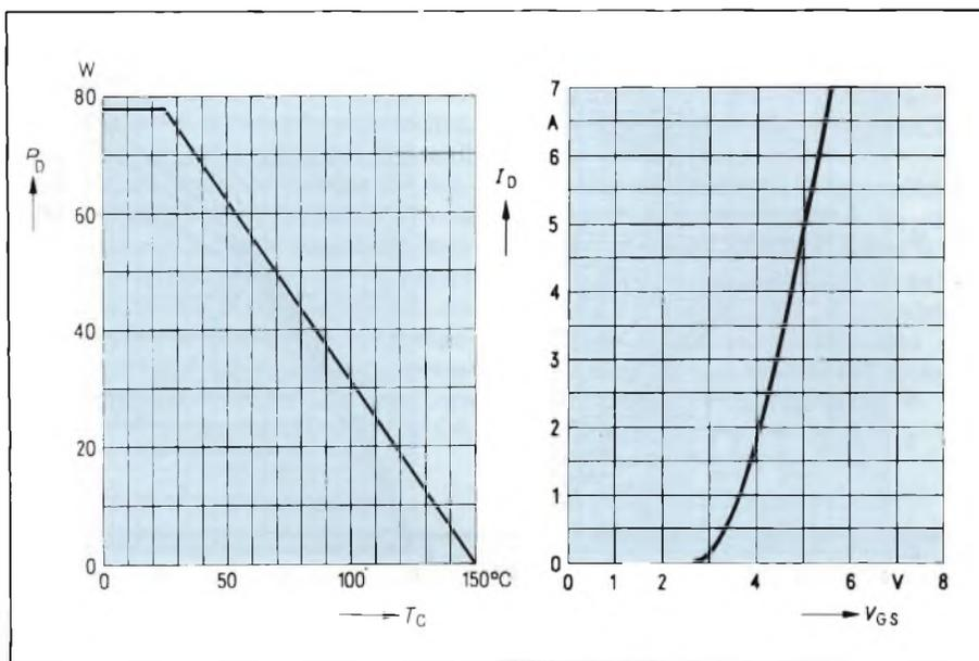
Fig. 4 - Curva tipica di trasferimento del BUZ44A che indica l'andamento tra la corrente di drain (I<sub>D</sub>) in funzione della tensione tra gate e source (V<sub>GS</sub>), misurata con una tensione tra drain e source di 25 V e la temperatura della giunzione di 25° C. La curva è stata rilevata con tensioni ad impulsi della durata di 80 ms. A sinistra: curva di dissipazione in funzione della temperatura del contenitore.
