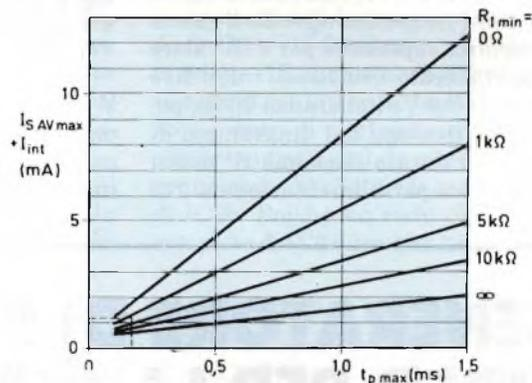
Fig. 8 - Grafico per la determinazione della resistenza  $R_v$ , in serie alla tensione di rete. Allo scopo, sarà necessario ricavare da questo diagramma la corrente massima  $I_{R AV}$  (equivalente ad  $I_{S AV}$  mass. +  $I_{int}$ ).
