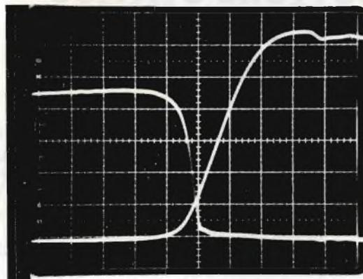
**Fig. 4 - Corrente di collettore e tensione emettitore/collettore del BUV 54 in fase di bloccaggio. Corrente di collettore: 1 A/div. Tensione emettitore-collettore: 50 V/div. Base dei tempi: 100 ns/div.**
