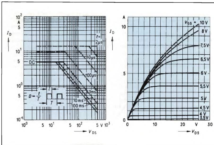
Fig. 5 - Curve caratteristiche del BUZ44 che mostrano l'andamento della corrente di drain ( $I_D$ ) in funzione della tensione tra drain e source con la tensione tra gate e source ( $V_{GS}$ ) data come parametro. A sinistra: aree di funzionamento sicuro ( $I_D = f(V_{DS})$ ).
