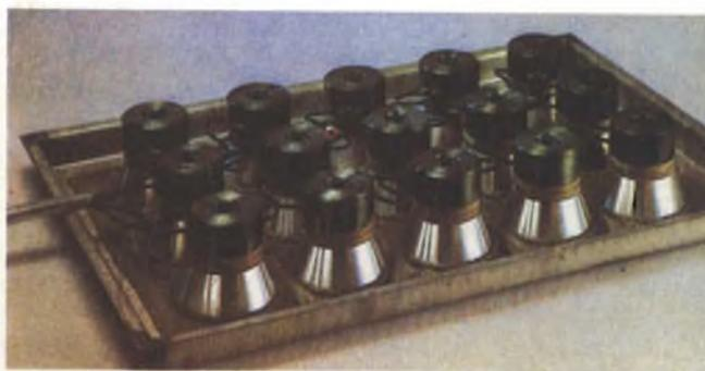
Fig. 9 - Parete di fondo di una vasca di pulitura ad ultrasuoni con trasduttori a sandwich.
