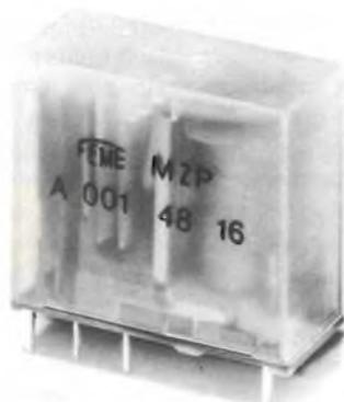
Relé da 16 A con un contatto di scambio o 1 NA o 1 NC, con doppia piedinatura in uscita o reticolo standard 2,5 mm.
