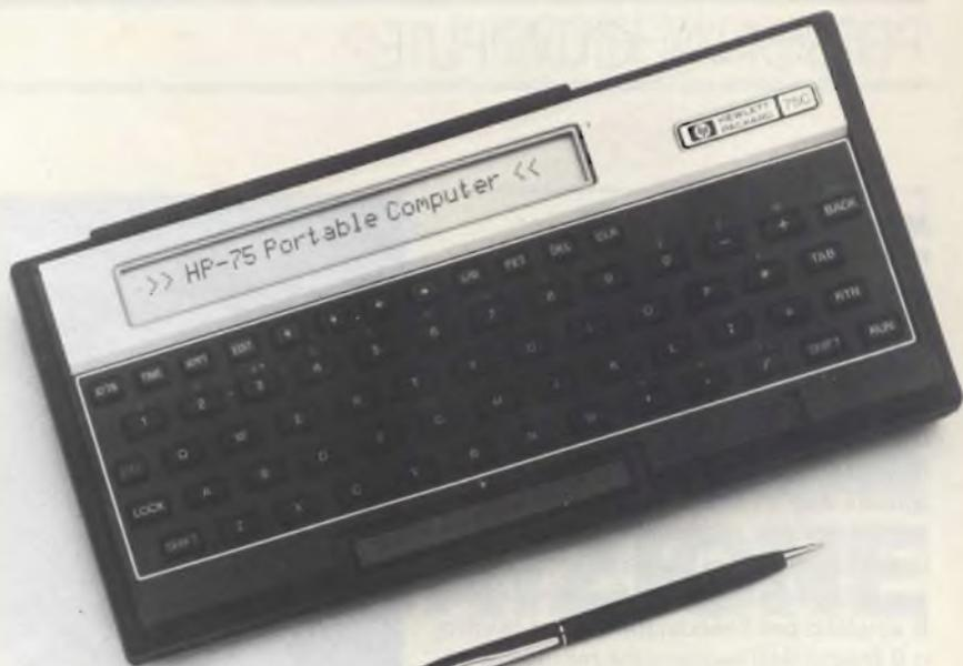
IL (Hewlett-Packard Interface Loop) incorporata, l'HP-75C può gestire un sistema completamente alimentato a batterie comprendente memorie di massa, stampante e strumentazione di massa, stampante e strumentazione di misura.
