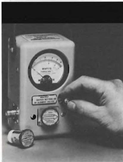
Misuratore di potenza RF munito di un amplificatore interno con 7 portate.
