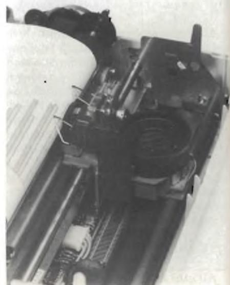
Fig. 8 - Carrello della stampante Siemens PT 88 e relativo sistema di inchiostatura a getto.
