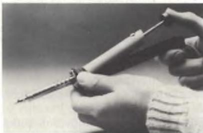
Saldatore/dissaldatore elettrico con punte facilmente intercambiabili.
