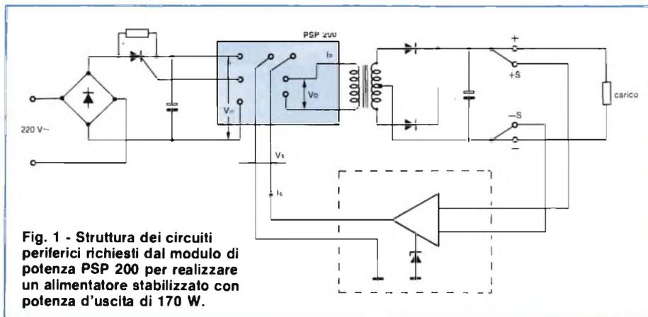
Fig. 1 - Struttura dei circuiti periferici richiesti dal modulo di potenza PSP 200 per realizzare un alimentatore stabilizzato con potenza d'uscita di 170 W.
