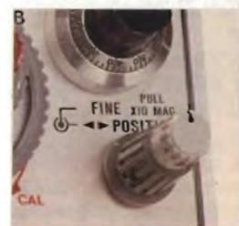
**Fig. 5 - Estruendo la manopola piccola del comando FINE di posizione orizzontale viene attivata la funzione di espansione X10 della base dei tempi.**
