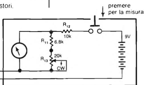
milliamperometro da  $100 \mu\text{A}$  con resistenza di Shunt da  $1 \text{ k}\Omega$
