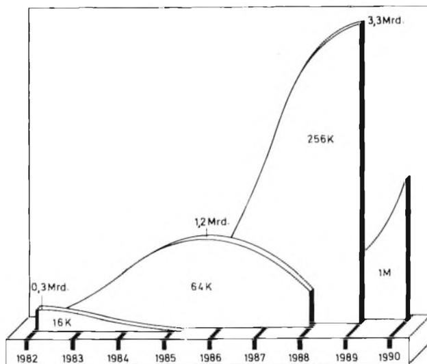
**Fig. 2 - Cicli di produzione delle memorie RAM dinamiche.**
