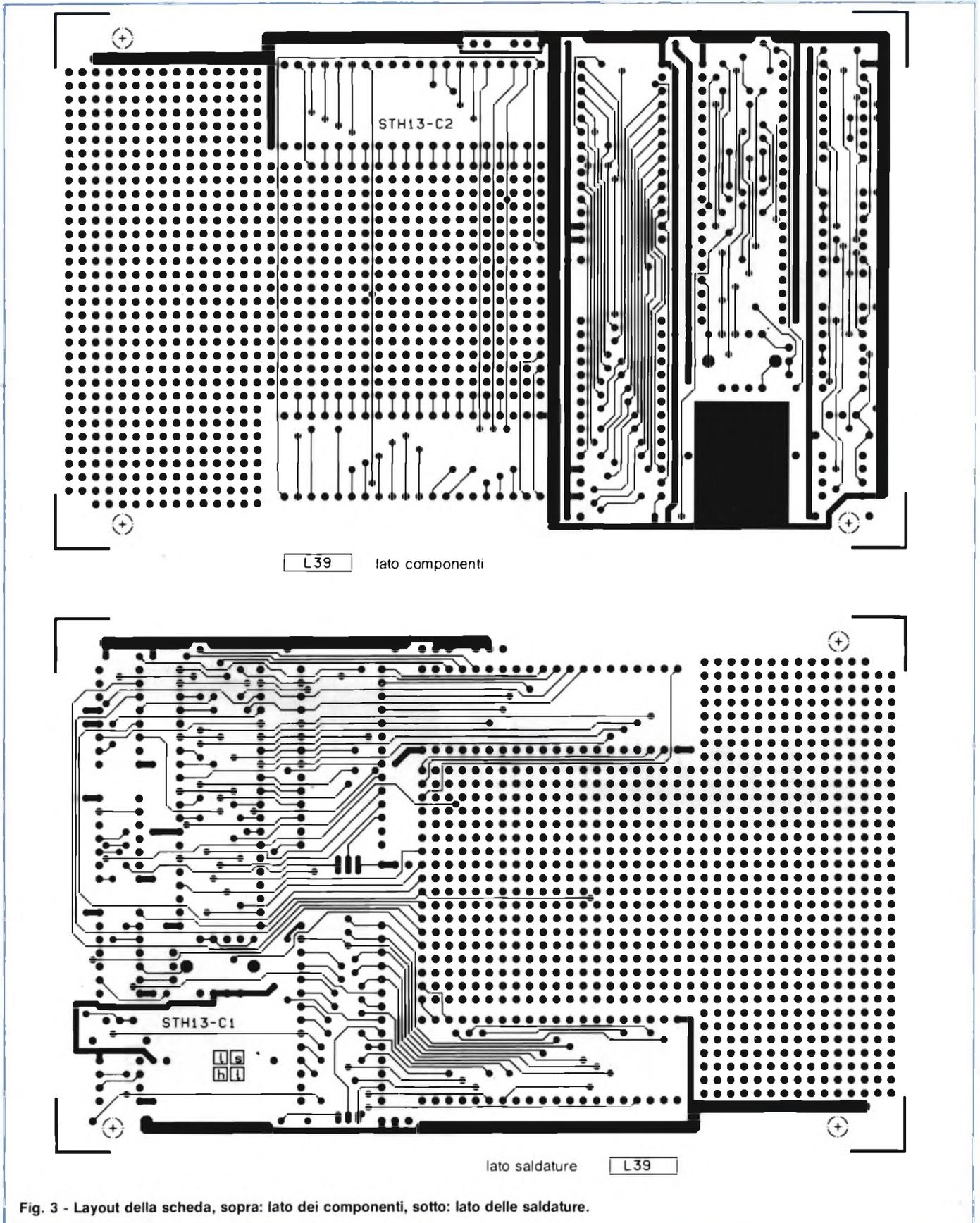
Fig. 3 - Layout della scheda, sopra: lato dei componenti, sotto: lato delle saldature.
