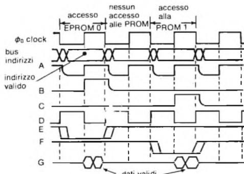
to da una leggera "dilatazione" dei tempi di accesso, che di norma passano da 50 a 100 ns circa: l'adozione di questo dispositivo resta ad ogni modo sostanzialmente vantaggiosa per i sistemi portatili e a batteria.
