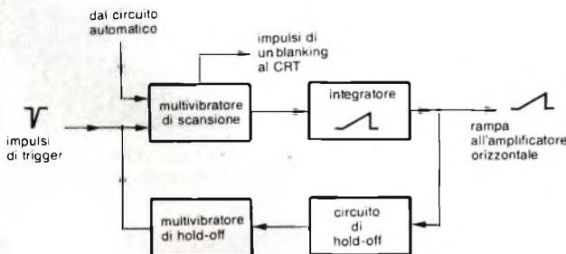
**Fig. 1 - Schema a blocchi del circuito della base dei tempi; esso produce sia la tensione a rampa per lo spostamento lineare della traccia sia l'impulso per sopprimere il ritorno della traccia stessa (blanking).**
