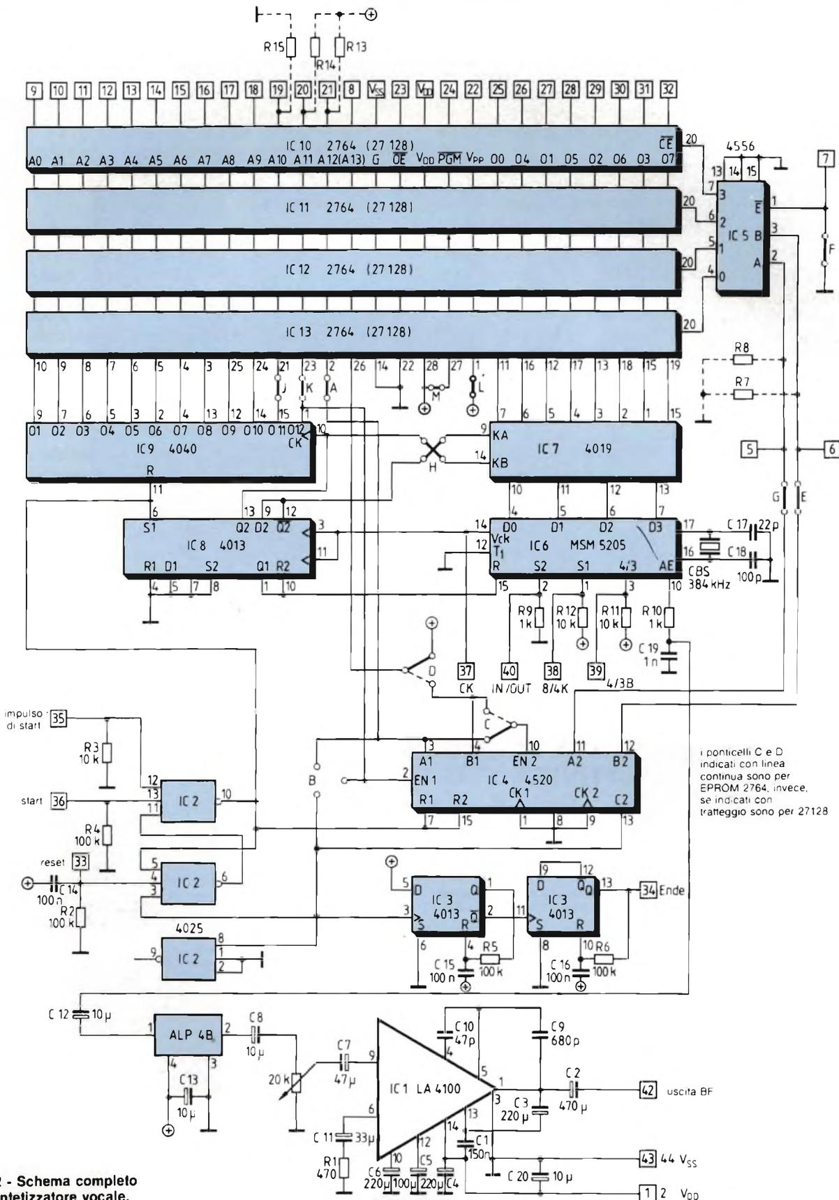
Fig. 2 - Schema completo del sintetizzatore vocale.
