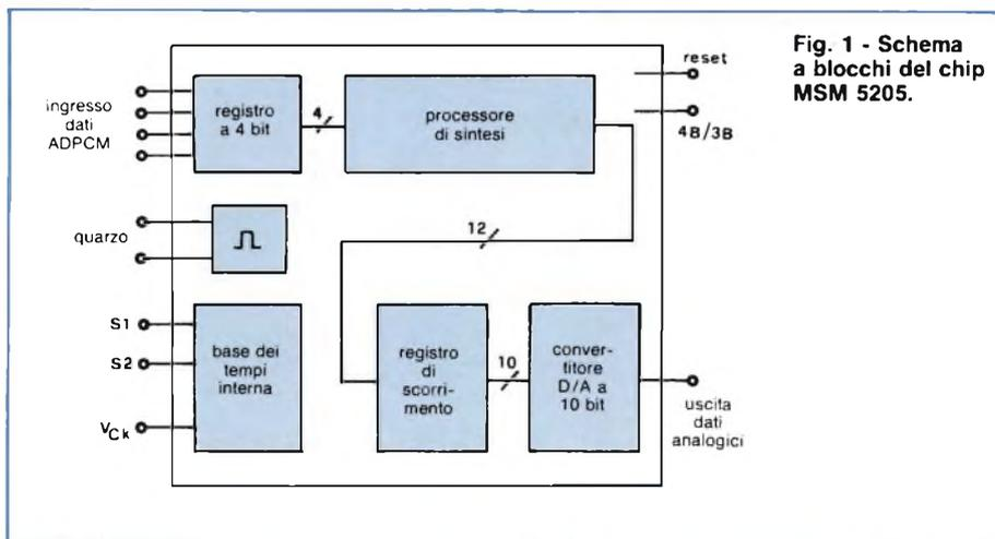
Fig. 1 - Schema a blocchi del chip MSM 5205.
