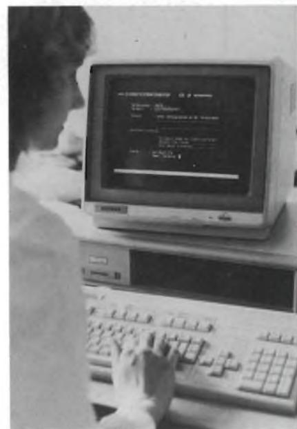
contiene i listati di tutte le segnalazioni pervenute, il terzo costituisce l'archivio per le contromisure da prendere in caso di bisogno e per i luoghi dell'allarme, il quarto infine è riservato ad informazioni supplementari o ad usi dell'operatore. È possibile passare da un livello all'altro direttamente (ossia senza intervalli per la costruzione dell'immagine), premendo un tasto di funzione, onde avere sempre a disposizione un quadro sinottico veloce ed aggiornato.
