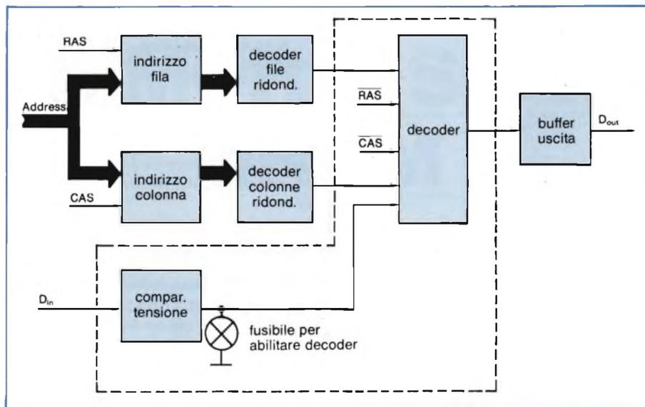
**Fig. 3** - In questa memoria della Siemens con l'aggiunta di pochi blocchi circuitali, è possibile collaudare anche le celle ridondanti; il fusibile viene disattivato per mezzo di un raggio laser in fase di collaudo.
