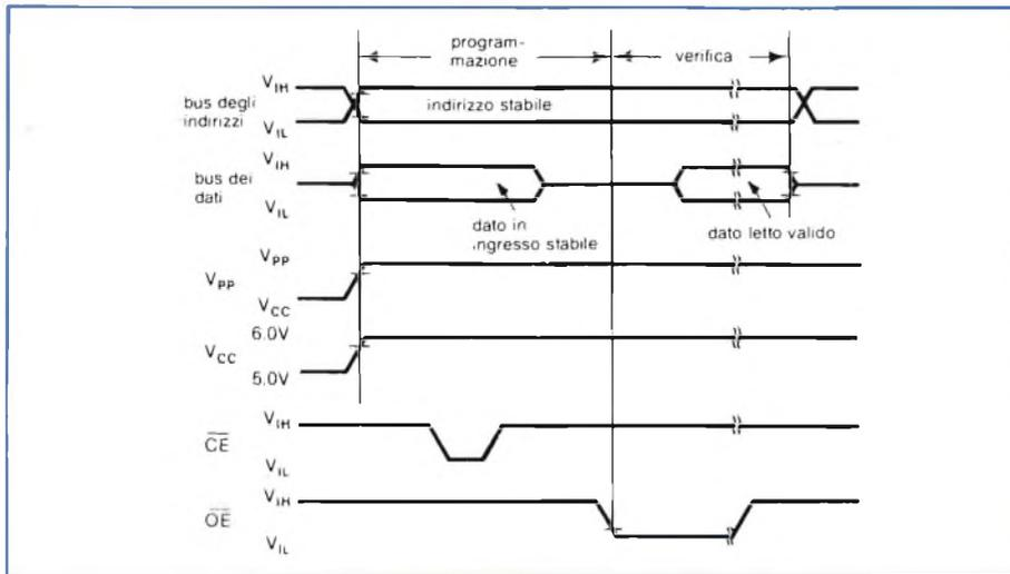
**Fig. 2 -** Tipiche forme d'onda dei segnali di una EPROM 27256. La tabella 1 illustra invece i vari modi di funzionamento della EPROM. Il modo di "identificazione intelligente" fa sì che la 27256 emetta un codice particolare "di prodotto", per cui il chip può essere effettivamente riconosciuto dalle più recenti macchine di programmazione.
