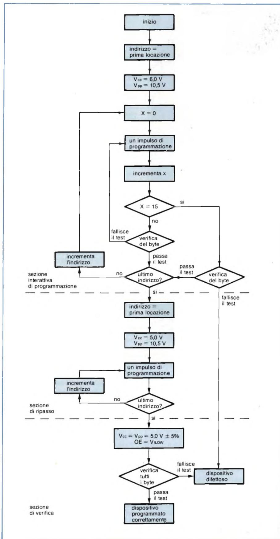
Fig. 2 - Un algoritmo intelligente di programmazione, formato da tre sezioni successive, è stato studiato appositamente per l'Am27C1024, in modo da ridurre enormemente i lunghi tempi di programmazione tipici delle più vecchie EPROM da 2, 4, 8 K. Il software che funziona seguendo questo algoritmo è implementato nelle macchine programatrici più avanzate. Le tre sezioni evidenziate sono: sezione interattiva di programmazione, sezione di ripasso e sezione di verifica.
