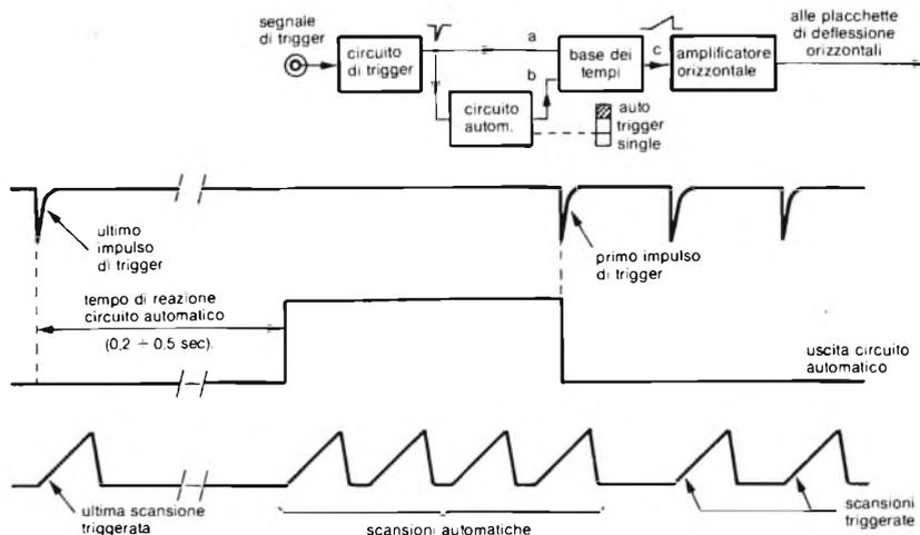
**Fig. 3 - Andamento nel tempo dei segnali presenti nel funzionamento "modo automatico". L'AUTO mode fa in modo che sullo schermo compaia la traccia, anche in assenza del segnale d'ingresso, o di una sua ampiezza insufficiente.**
