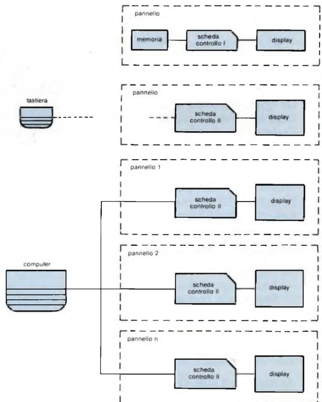
Fig. 3 - Sistemi di comando dei moduli.
