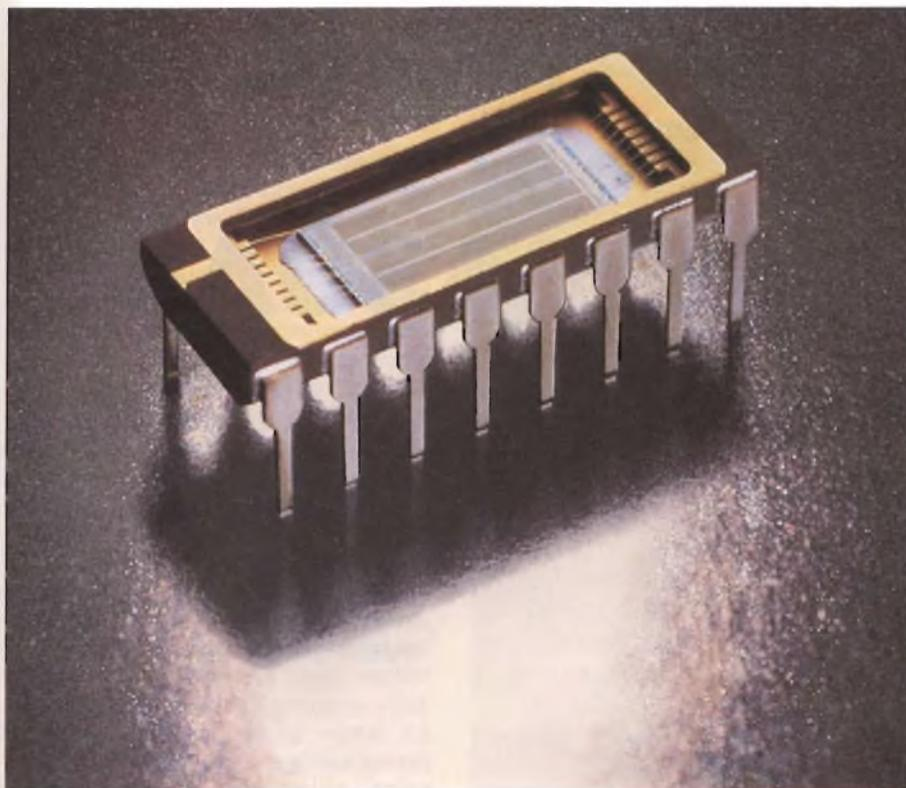
**EPROM da 256 kbit della Siemens. Il chip misura appena 33 mm<sup>2</sup>.**
