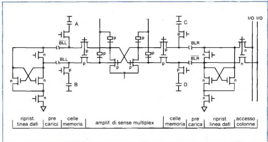
La tecnica di estrazione dei dati merita un accenno particolare: un bistabile a canale P, comandato dal clock (*figura 4*) rimane completamente isolato dalle linee di bit durante il "sensing". Una coppia di condensatori collegati all'amplificatore di "sense" viene attivata onde regolare la soglia ed aumentare il guadagno. L'area della cella è di  $70 \mu\text{m}^2$ , con una capacità di 55 fF.
