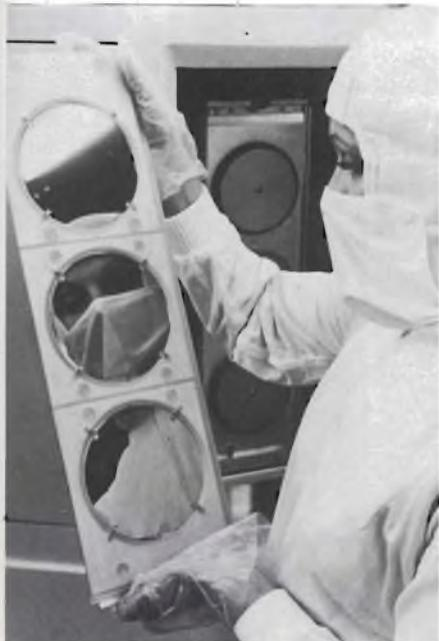
Dischi di silicio purissimo pronti per la produzione dei chip delle memorie DRAM da 256 k nella fabbrica Siemens di Villac (Austria).
