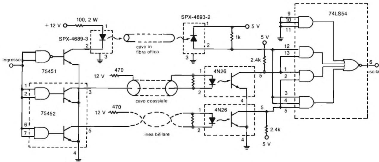
**Fig. B - Un sistema semplice ed efficiente per triplicare una linea di trasmissione di dati, utilizzando tre mezzi diversi (linea bifilare, un cavo coassiale e un cavo in fibra ottica), in modo da renderla affidabile anche in ambienti ad elevato rischio di interruzioni.**
