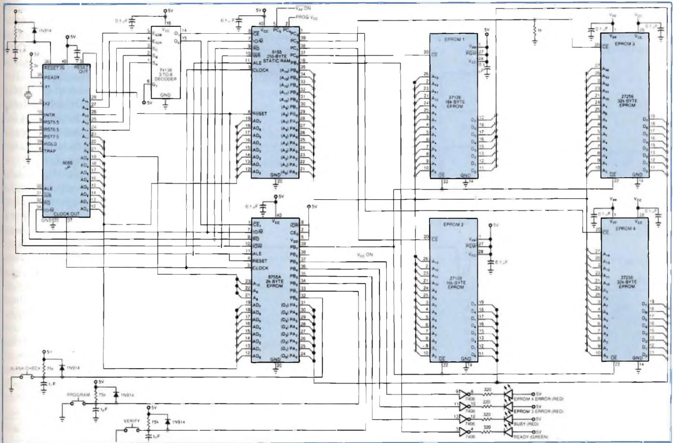
**Fig. 4 - Schema elettrico dettagliato del programmatore dimostrativo.**
