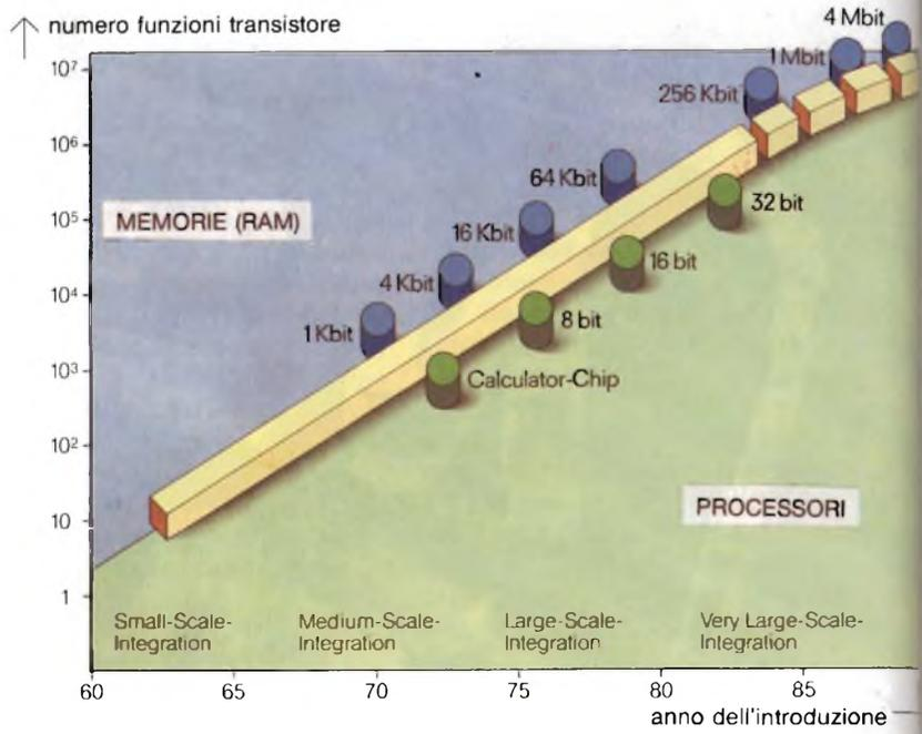
**Fig. 1 - Il numero delle funzioni-transistore per unità di superficie del chip è andato continuamente aumentando: la densità d'integrazione è andata infatti quadruplicandosi ogni tre anni. In base alle attuali conoscenze si prevede che questa curva comincerà ad appiattirsi solo dopo la realizzazione della memoria da 4 Mbit.**
