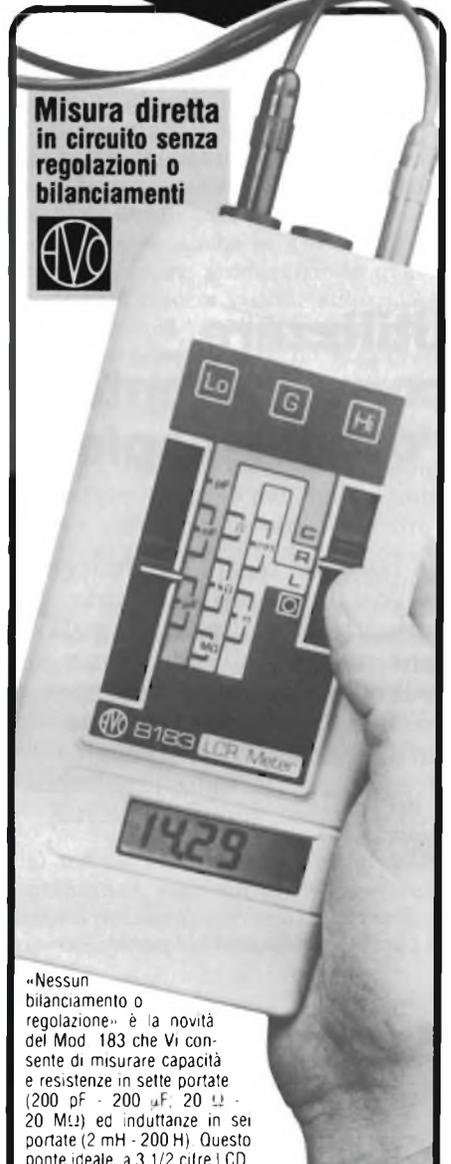
«Nessun bilanciamento o regolazione» è la novità del Mod. 183 che Vi consente di misurare capacità e resistenze in sette portate (200 pF - 200 μF, 20 Ω - 20 MΩ) ed induttanze in sei portate (2 mH - 200 H). Questo ponte ideale, a 3 1/2 cifre LCD, esegue le misure ad 1 KHz oppure a 100 Hz a seconda della portata scelta ed è protetto sino a 250 V c.a./c.c. ai terminali di misura.
