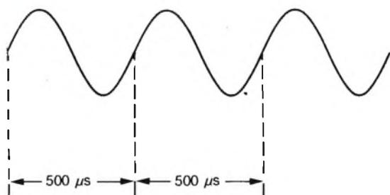
**Fig. 1 - Forma d'onda sinusoidale avente un periodo di 500 μs usata come segnale di prova per l'impostazione della base dei tempi.**
