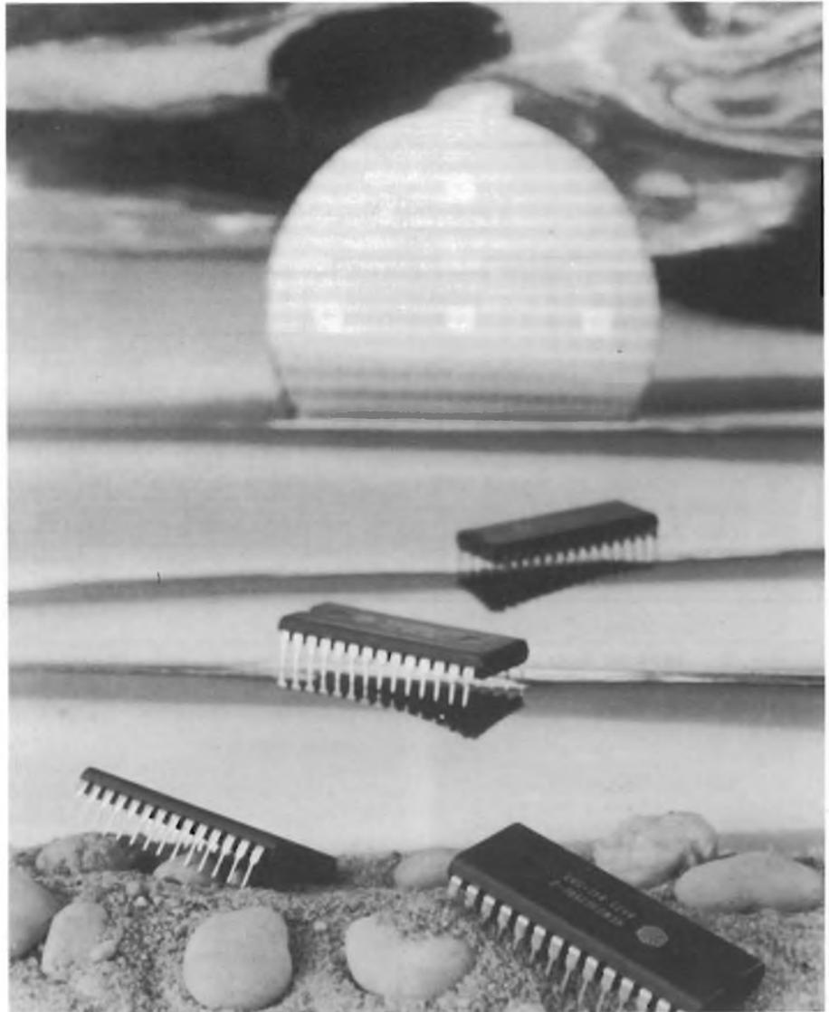
EPROM - cancellabili con raggi ultravioletti. Il terzo strato ospita la gate di controllo per la selezione di parola in programmazione e lettura. La programmazione viene effettuata mediante un'iniezione di cariche, simile a quella usata nelle EPROM, mentre la cancellazione avviene tramite emissione di elettroni sulla gate flottante e verso quella di cancellazione; l'operazione richiede una tensione massima di 30 V e viene effettuata in meno di 1 ms per byte.
