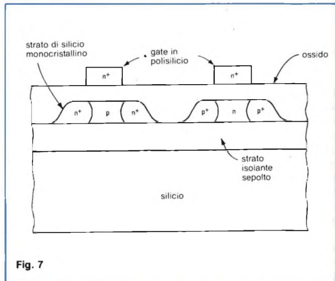
**Fig. 7 - Con la tecnologia SOI (Silicon On Insulator), uno strato isolante "sepolto" aumenta in pratica l'area disponibile per i componenti attivi del chip.**
