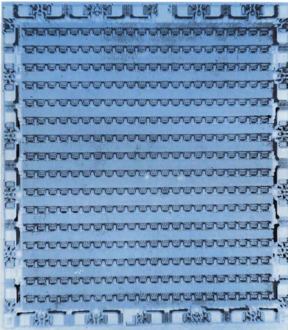
La Philips-Elcoma produce GATE ARRAY in quattro tecnologie e con diverse complessità:
