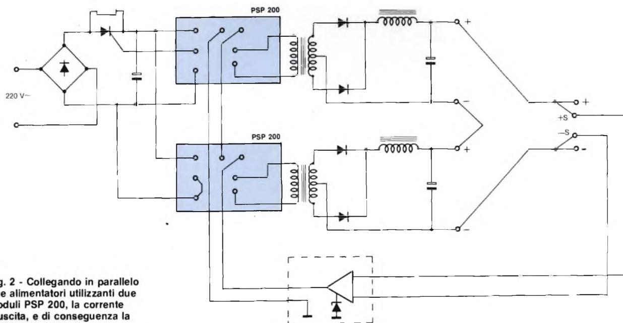
**Fig. 2 - Collegando in parallelo due alimentatori utilizzando due moduli PSP 200, la corrente d'uscita, e di conseguenza la potenza d'uscita vengono raddoppiate.**
