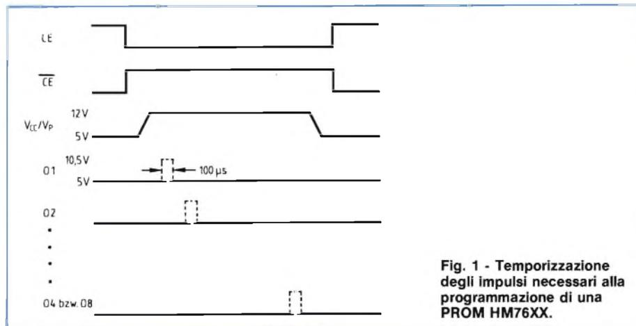
Fig. 1 - Temporizzazione degli impulsi necessari alla programmazione di una PROM HM76XX.
