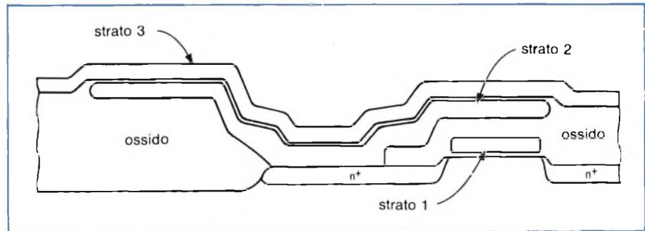
sandwich di polisilicio (figura 6) nei quali transistori di prestazioni non spinte vengono ricavati da un sottile strato di polisilicio depositato sopra un substrato che contiene transistori convenzionali. Alcuni osservatori ritengono però che anche questa tecnologia presenti problemi di affidabilità e richieda per la sua attuazione sofisticati processi tecnologici.
