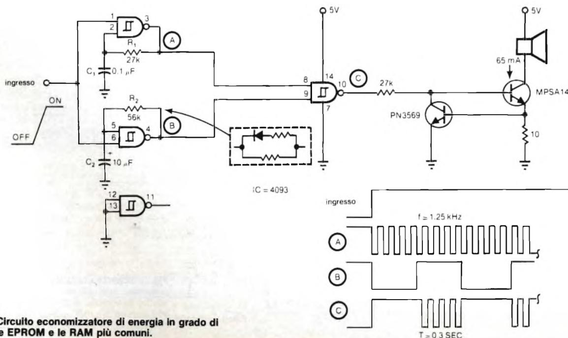
Fig. D - Circuito economizzatore di energia in grado di pilotare le EPROM e le RAM più comuni.
