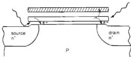
Fig. 3 - Meccanismo di cancellazione di una cella EPROM. Dalla gate flottante si verifica un allontanamento di elettroni determinato dall'alterazione del campo elettrico.
