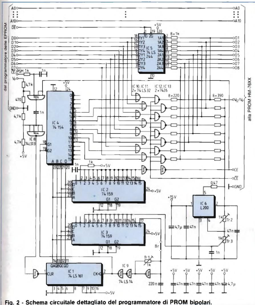
Fig. 2 - Schema circuitale dettagliato del programmatore di PROM bipolari.
