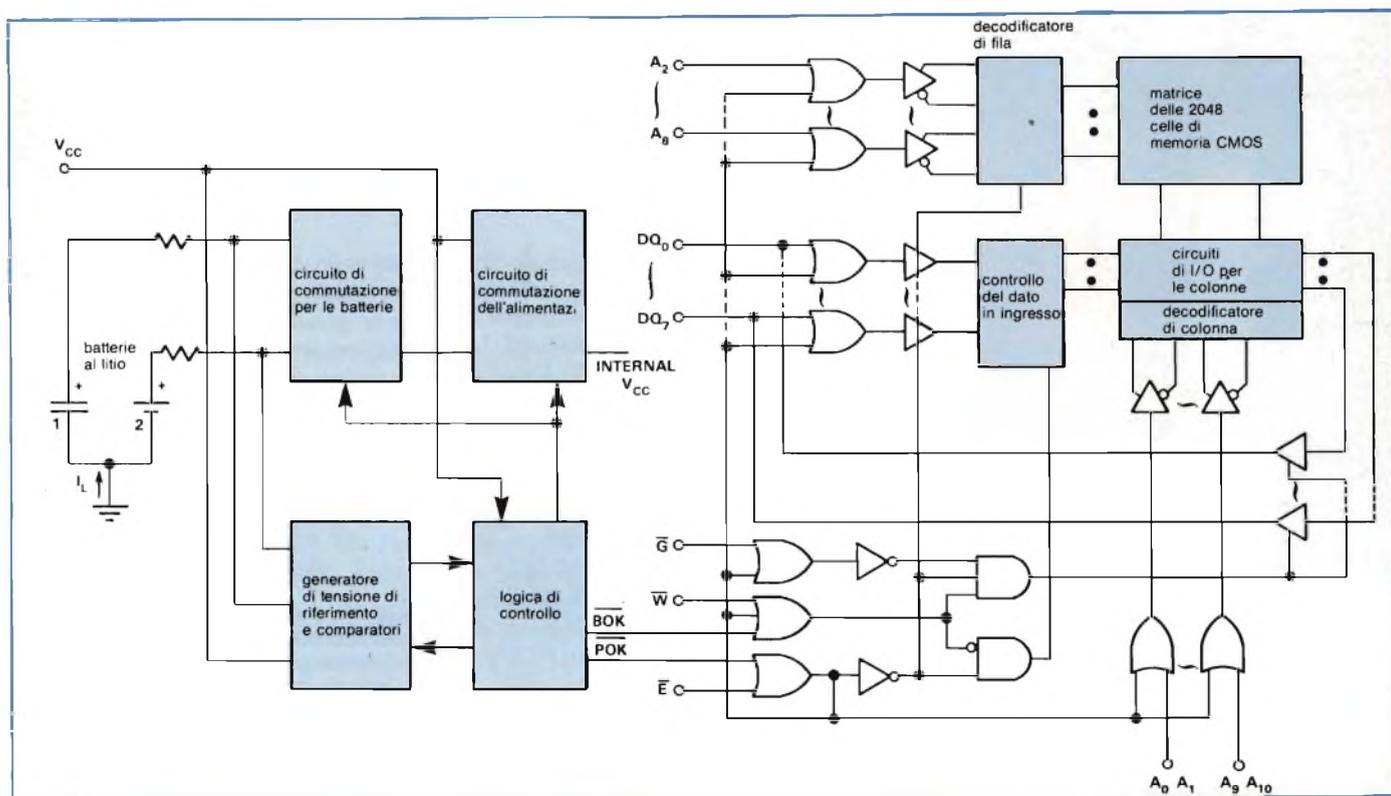
Fig. 4 - Schema a blocchi dettagliato della struttura interna della Zeropower MK48Z02.
