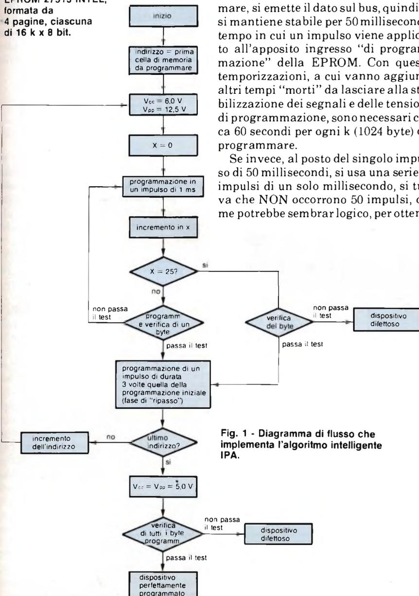
Fig. 1 - Diagramma di flusso che implementa l'algoritmo intelligente IPA.
