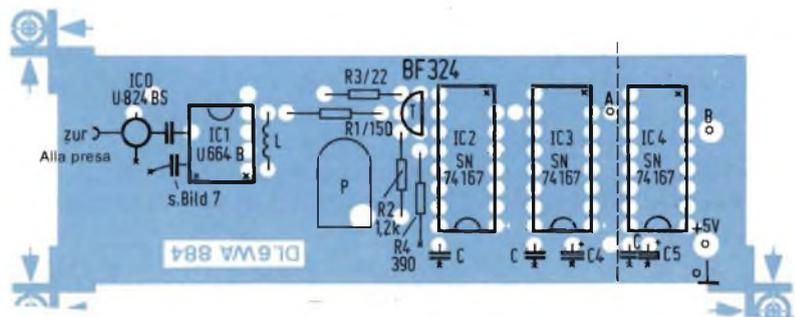
re il relativo componente. I collegamenti di massa dei circuiti integrati IC2, IC3 ed IC4 (quando vengono montati) devono essere anch'essi saldati sulle due facce (piedino 8).
