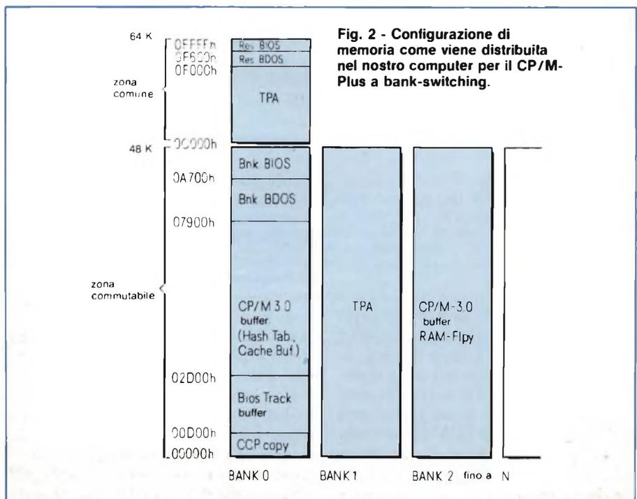
**Fig. 2 - Configurazione di memoria come viene distribuita nel nostro computer per il CP/M-Plus a bank-switching.**
