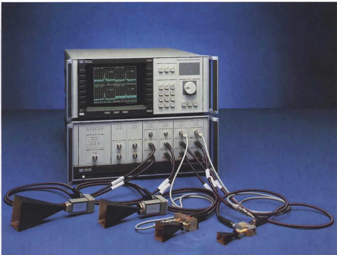
L'HP 71300A è particolarmente adatto per il controllo e l'analisi dello spettro dei segnali con lunghezza d'onda dell'ordine del millimetro.
