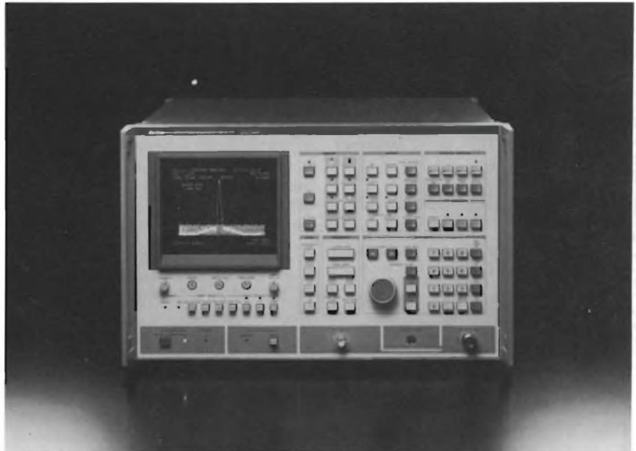
**Analizzatore di spettro MS611A ANRITSU** per prestazioni elevate (da 50 Hz a 2 GHz); possiede una dinamica di 90 dB; può misurare livelli di segnale compresi tra -135 a +25 dBm; la risoluzione va da 10 Hz a 3 MHz. L'oscillatore locale è a sintesi di frequenza. Lo strumento può essere controllato dall'esterno tramite un'interfaccia GP-IB standard. Tutte le funzioni sono comandate da microprocessore. Tutte le condizioni di misura sono visualizzate sullo schermo.
