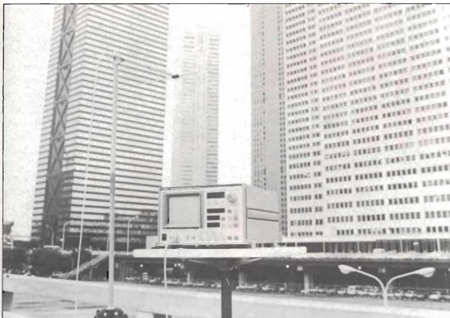
**Esempio d'impiego dell'analizzatore di spettro MS610A per la misura dell'intensità di campo di segnali utili e di quelli disturbanti (rumore). In un microprocessore interno sono memorizzate le curve caratteristiche di alcune antenne che l'ANRITSU fornisce come accessori.**
