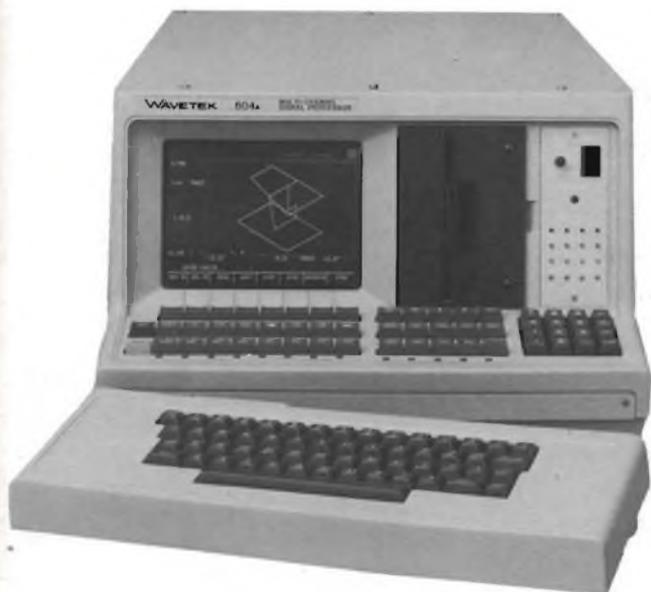
**Analizzatore di spettro a 4 canali, Wavetek tipo 804A. Opera dalla continua a 40 kHz. Ha un computer incorporato. Questo strumento può fare le veci di 4 analizzatori di spettro FFT in tempo reale, di un analizzatore di forme d'onda a quattro canali, di un calcolatore/controllore e di un word-processor.**
