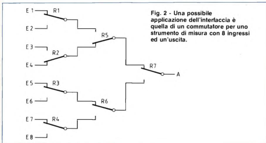
Fig. 2 - Una possibile applicazione dell'interfaccia è quella di un commutatore per uno strumento di misura con 8 ingressi ed un'uscita.
