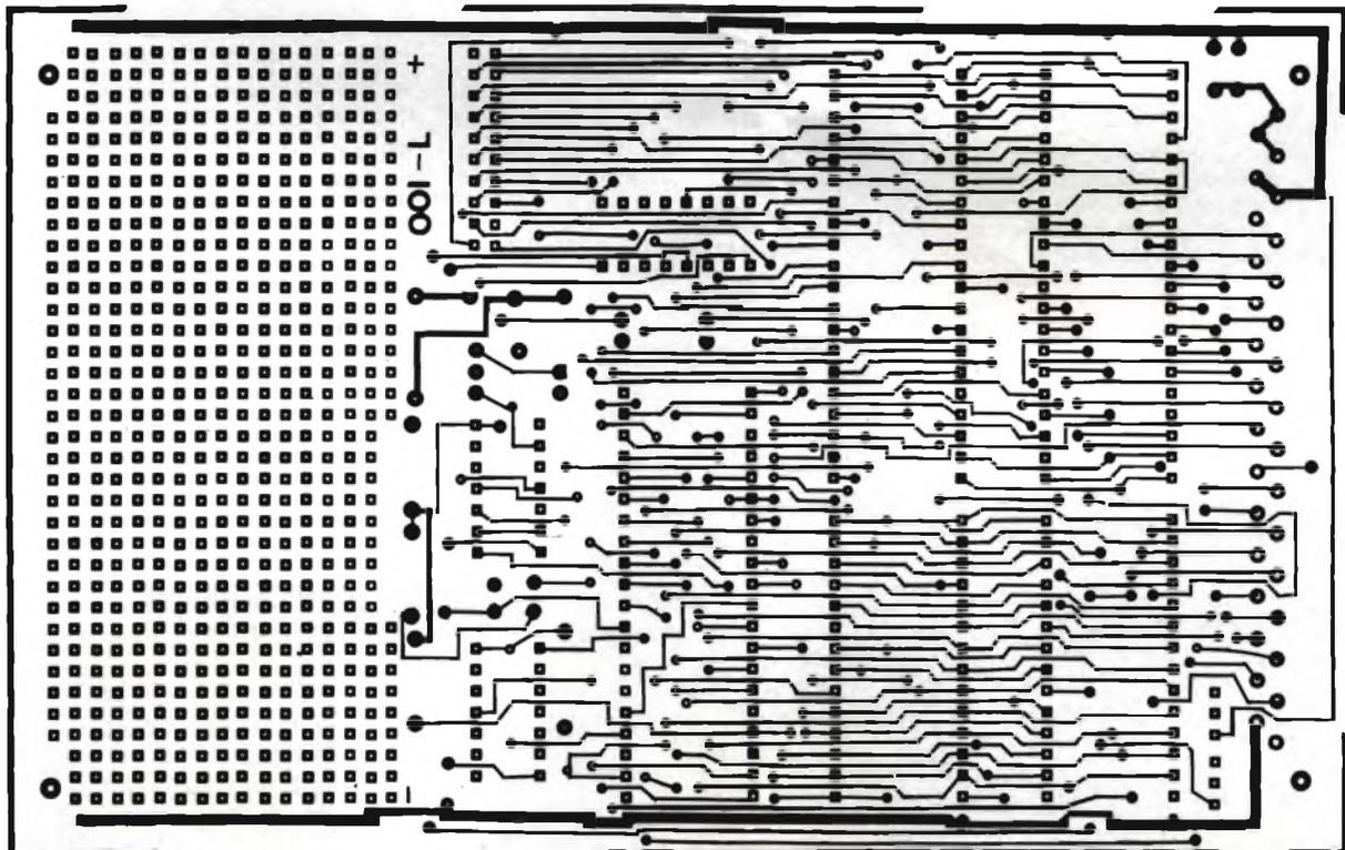
Fig. 3 - Layout della scheda: lato saldature.
