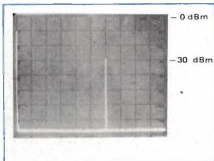
**Fig. 1 - Ecco come appare un segnale di 60 MHz non modulato sullo schermo di un analizzatore di spettro.**
