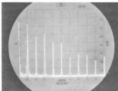
**Fig. 1 - (a sinistra). Segnale d'uscita a 10 MHz di un amplificatore sovrapilotato, osservato all'oscilloscopio. Il taglio delle due semionde indica che l'ampiezza del segnale applicato è tale da superare la zona di funzionamento lineare dei transistori-amplificatori. (a destra). L'analizzatore di spettro indica sia il numero delle armoniche contenute nel segnale distorto d'uscita sia la loro ampiezza.**
