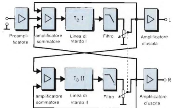
**Fig. 3. Schema a blocchi semplificato. Una retroazione incrociata ed una conversione mono/stereo influenzano positivamente la sonorità.**
