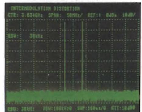
**Fig. 4 -** Il preselettore tracking interno lavorante nella banda da 1,7 GHz a 23 GHz permette di evidenziare fenomeni di distorsione di seconda armonica e di intermodulazione di terza armonica inferiore a - 100 dB di segnali d'ingresso aventi un livello inferiore a - 10 dBm.
