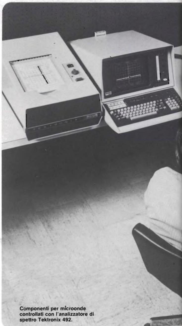
Componenti per microonde controllati con l'analizzatore di spettro Tektronix 492.
