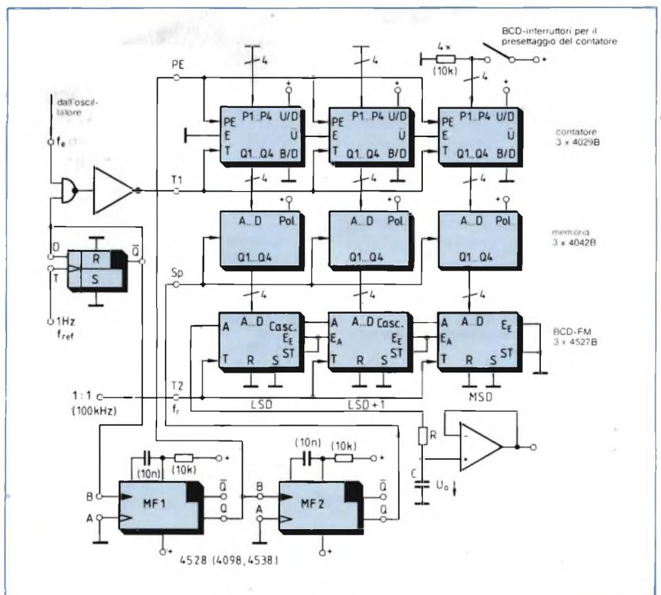
Fig. 1 - Schema funzionale del discriminatore di frequenza digitale.
