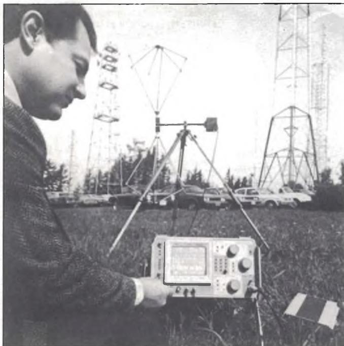
**Esempi d'impiego dell'analizzatore di spettro Tektronix 496/496P per il controllo di segnali VHF/UHF irradiati da un trasmettitore.**
