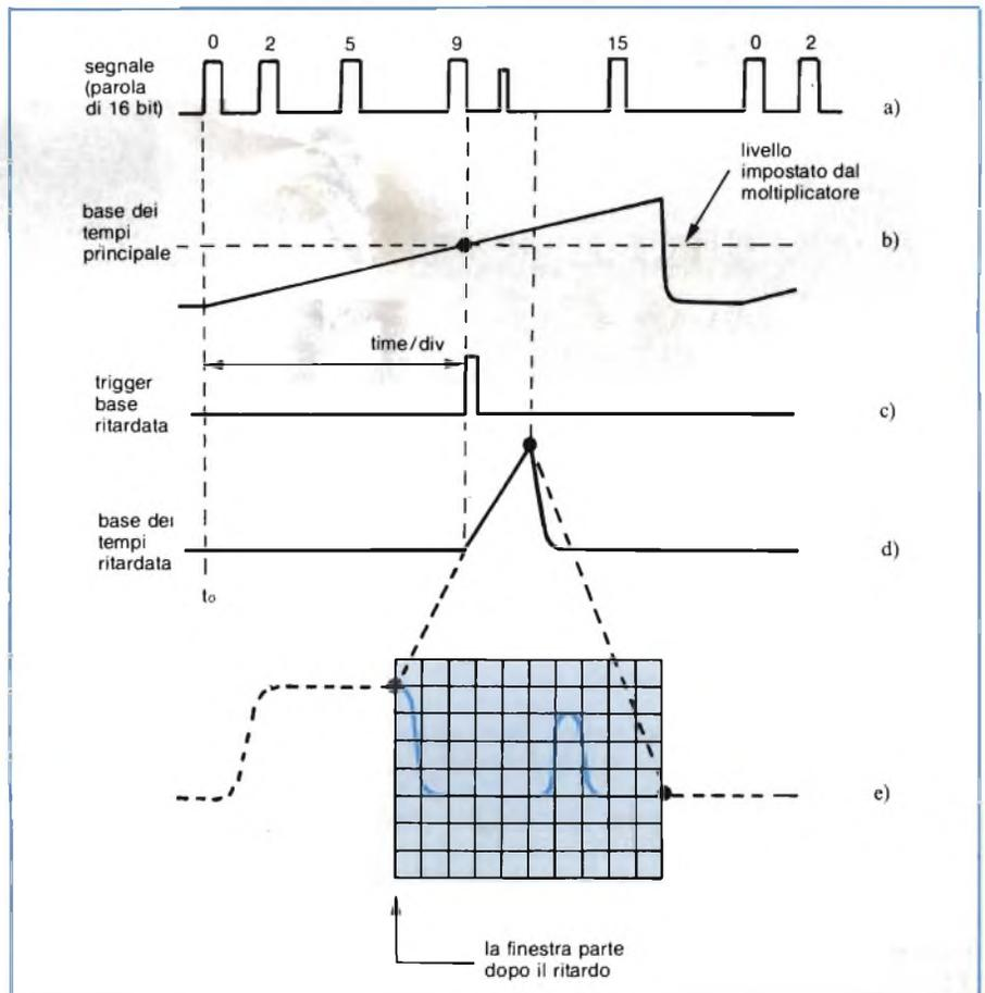
**Fig. 2 - Schema a blocchi della base dei tempi ritardata. I circuiti riguardanti quest'ultima sono disegnati con tratto più marcato.**
