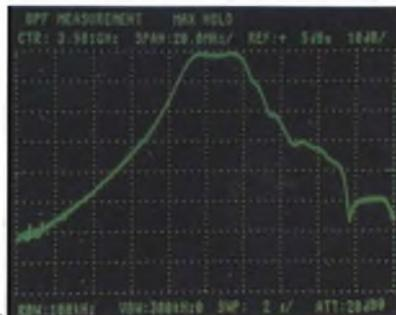
Fig. 5 - a) disposizione degli strumenti richiesti per la misura della banda passante di un filtro passa-banda; b) la banda passante del filtro come appare sullo schermo dell'analizzatore di spettro.
