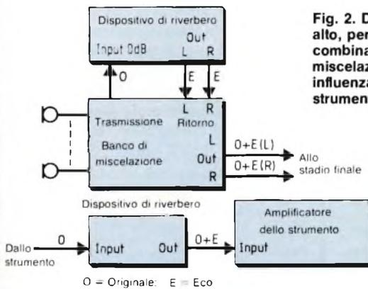
**Fig. 2. Due esempi pratici. In alto, per ottenere effetti in combinazione con un banco di miscelazione, in basso, per influenzare la sonorità degli strumenti.**
