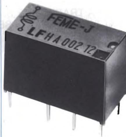
Due contatti di scambio biforcati e dorati possono commutare carichi da 100 mW fino a 24 W. Le ridotte dimensioni di 20,2 mm x 9,8 mm x 11,4 mm in altezza e la piedinatura a 8 pin-dip rendono il relé LF intercambiabile con i principali concorrenti già presenti sul mercato. Un congruo stock di magazzino è disponibile per consegne immediate.
