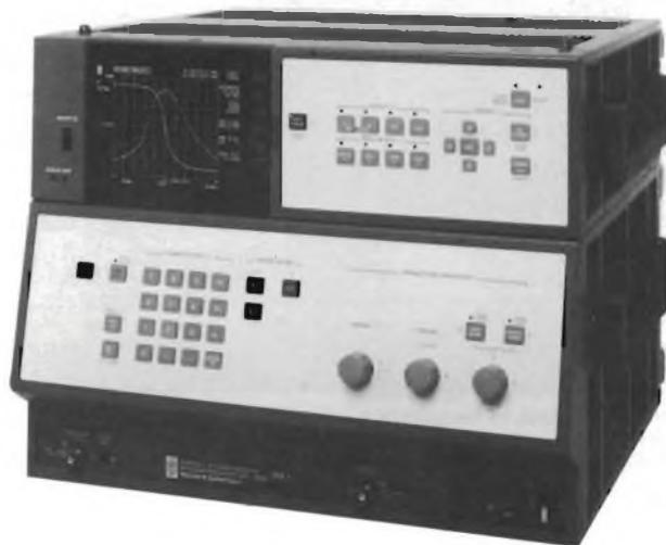
memorizzare maschere di tolleranza e predisposizioni complete dello strumento di frequente impiego.
