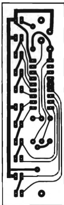
Fig. 11. Circuito stampato per l'indicatore del livello d'uscita.
