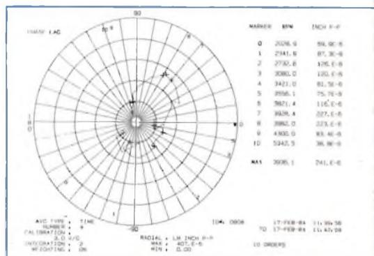
**Fig. 1 - Esempio di diagramma polare presentato sullo schermo dell'analizzatore 5810A.**
