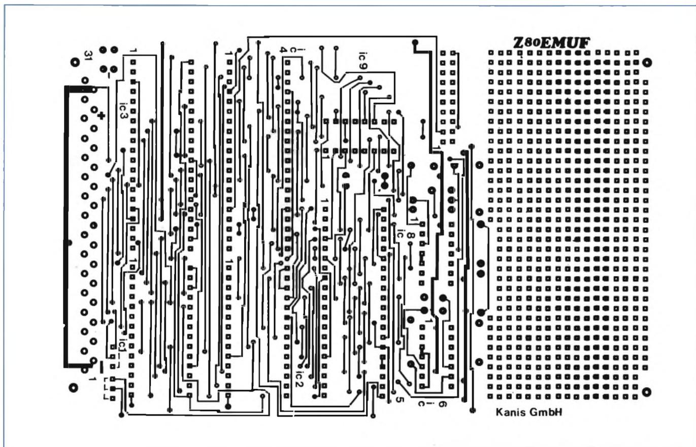
Fig. 4 - Layout della scheda: lato componenti.
