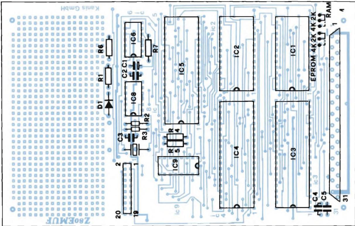
Fig. 2 - La disposizione dei componenti sull'ECC-80.
