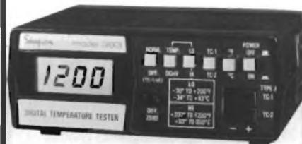
**Termometro digitale Mod. 383** a termocoppie; a doppio ingresso (commutabile); misura anche in differenziale; uscita per registratore; da  $-34^{\circ}\text{C}$  a  $+650^{\circ}\text{C}$ , precisione  $\pm 0,2\%$
