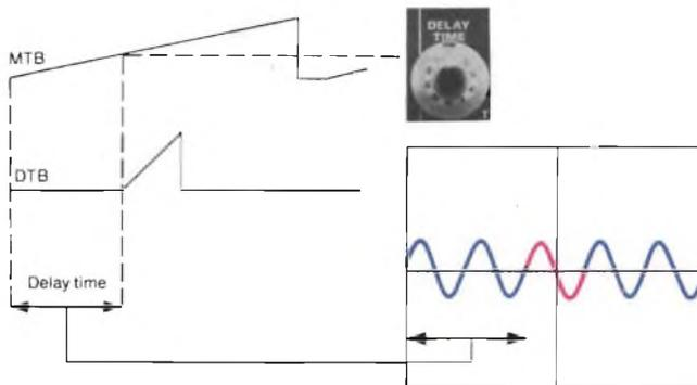
**Fig. 1 - Il diagramma mostra la rampa della base dei tempi principale e quella della base ritardata; quest'ultima parte nel punto stabilito dall'impostazione del potenziometro "DELAY TIME" posto sul pannello frontale.**
