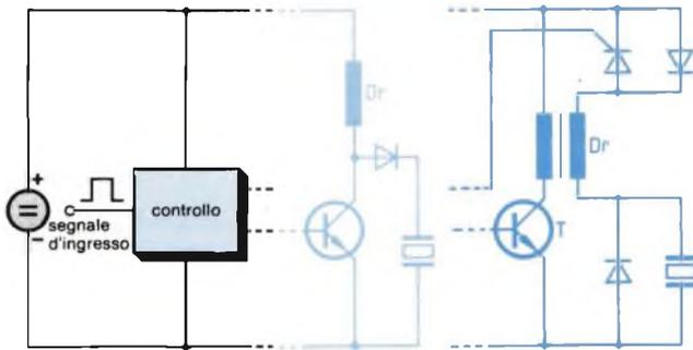
**Fig. 2 - La parte sinistra mostra uno schema comprendente la produzione dell'alta tensione, la carica e scarica dell'attuatore e il controllo logico del transistor. La parte destra mostra invece il principio della scarica con trasformatore di tensione (nel testo si parla più opportunamente di "induttanza" o reattore) e il sistema di recupero di energia.**
