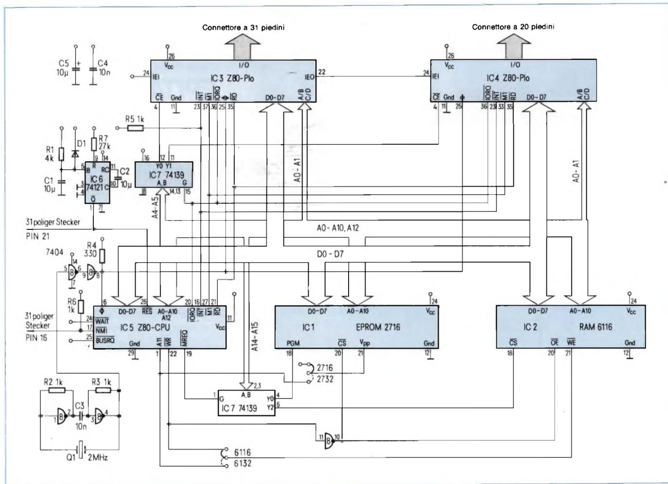
Fig. 1 - Circuito completo dell'ECC-80. Può venir munito a piacere di uno o due PIO e di RAM e ROM di diverse capacità.
