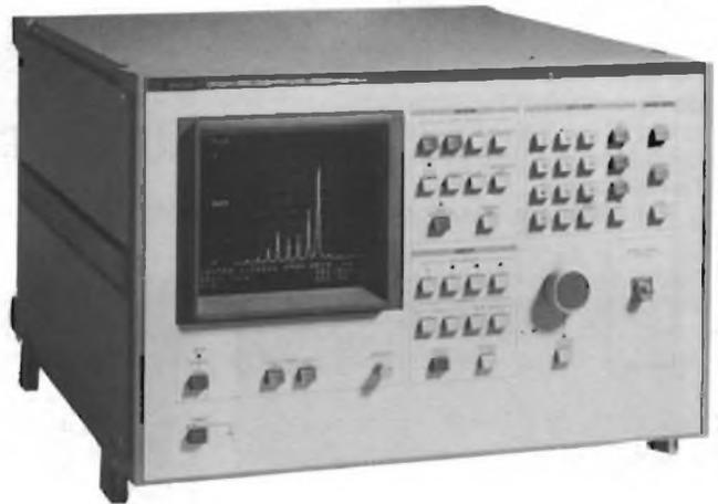
**Analizzatore di spettro ottico tipo MS96A della ANRITSU (da 0,6 a 1,6  $\mu\text{m}$ ): dinamica: da 0 a 60 dBm, precisione  $\pm 1$  nm; risoluzione selezionabile da 0,1 a 10 nm. Stampante incorporata. Programmabilità completa tramite interfaccia IEEE-488.**
