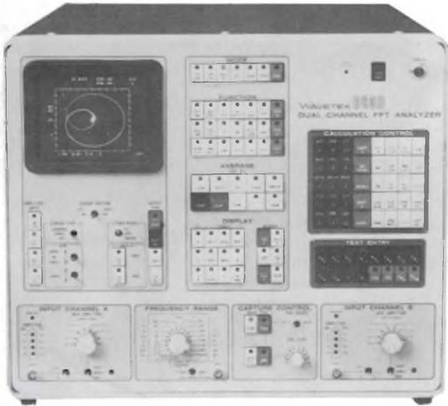
**Analizzatore di spettro a due canali Wavetek tipo 660B.** Lavora dalla continua a 100 kHz, con 400 righe (due canali) oppure 800 righe (un canale). Consente 14 modi di analisi e la memorizzazione delle curve e dell'impostazione dei comandi sul pannello. Particolarmente adatto per il controllo di fenomeni vibratorii nel settore dell'acustica e della meccanica.
