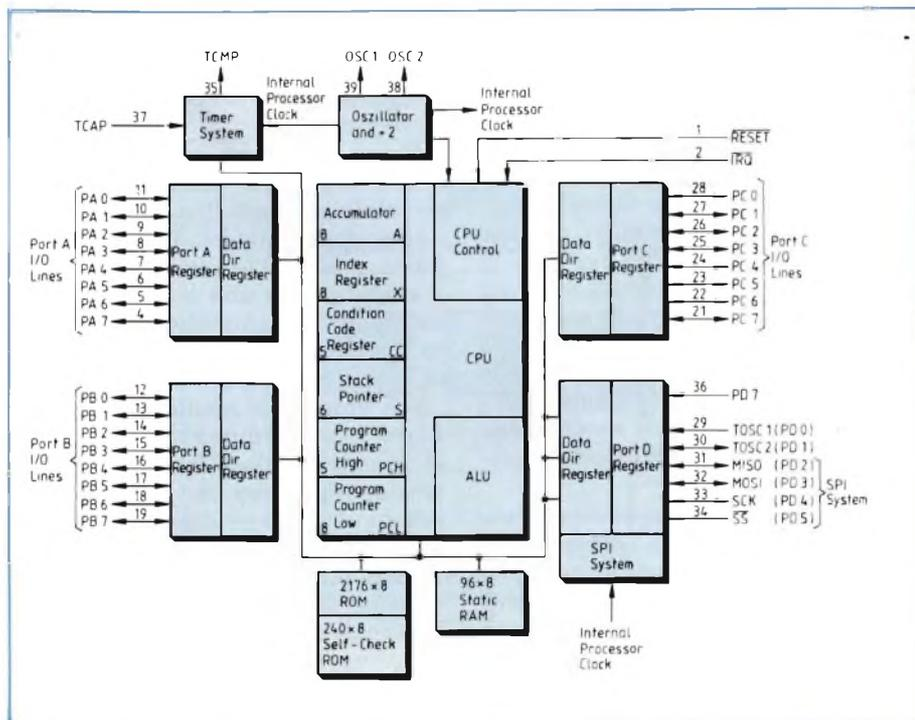
Fig. 1 - Schema a blocchi del microcontrollore 6805 D2. Su un integrato trovano posto 2176 bytes di ROM, 96 byte di RAM, 240 byte di ROM di Autotest, 16 byte contenenti i vettori di Interrupt, 32 byte riguardanti I/O.
