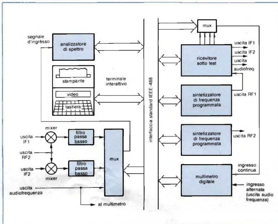
L'uso dell'analizzatore di spettro è determinante, poiché fornisce informazioni su diversi parametri contemporaneamente; nel caso mostrato, la presenza dei sintetizzatori di frequenza
