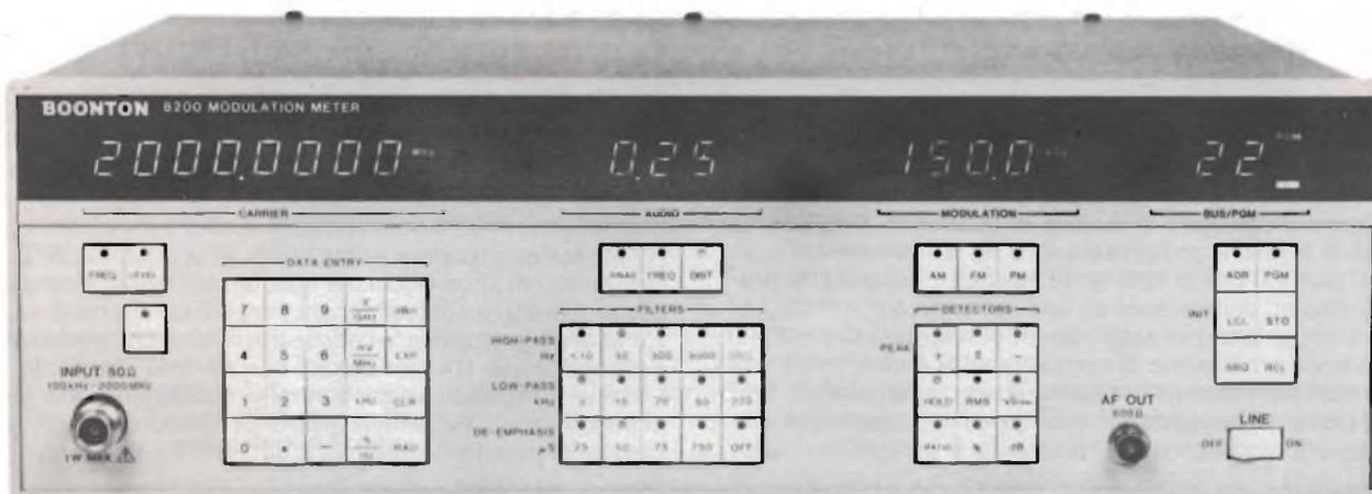
L'analizzatore di modulazione Boonton Mod. 8200 misura, nella gamma da 100 kHz a 2 GHz, la percentuale di modulazione AM ed FM fino all'1 % della lettura, la modulazione di fase sino al 3 %, la frequenza portante con risoluzione di 10 Hz e livelli con 0,1 dB. È inoltre completamente programmabile GP-IB.
