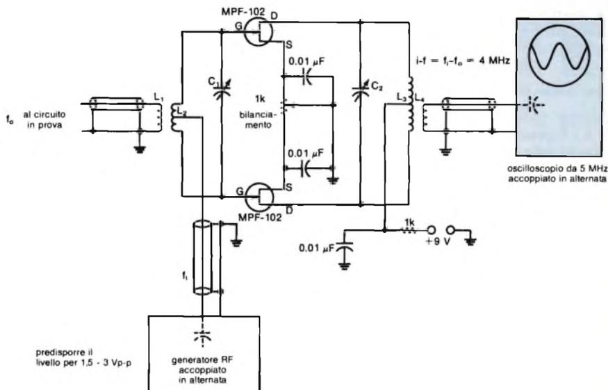
**Fig. B - Un mixer doppio bilanciato a FET può essere utilizzato per ridurre un segnale VHF a una frequenza leggibile con un oscilloscopio con banda passante di pochi megacicli. La bobina L2 e il condensatore C1 debbono essere sintonizzati per la frequenza che interessa convertire ( $f_o$ ). Il link L1 ha di norma un terzo del numero delle spire di L2. Il circuito risonante d'uscita è tarato su 4 MHz circa.**
