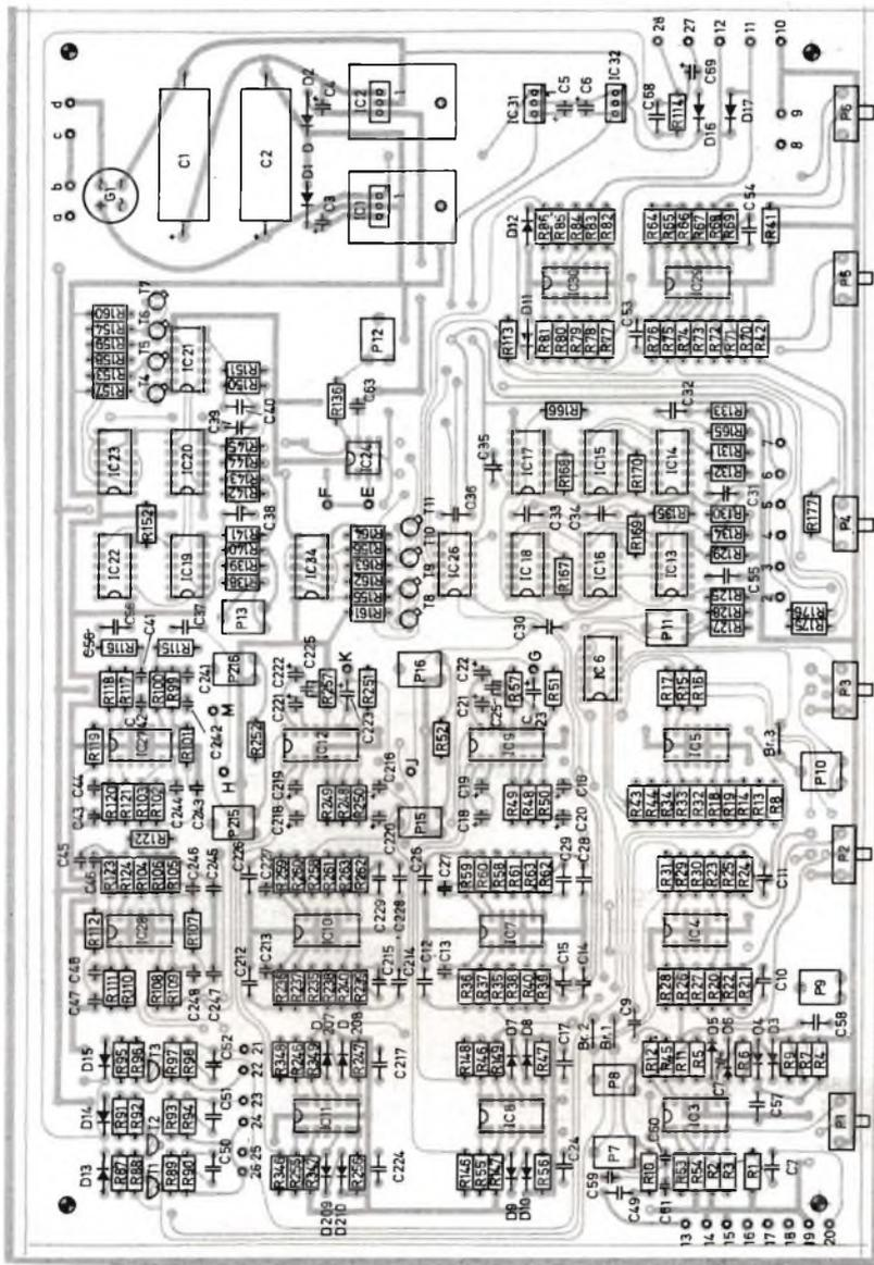
Fig. 10. Disposizione dei componenti in scala 1:2.
