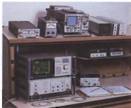
Fig. 4 - L'analizzatore di spettro HP 71000A è particolarmente adatto per analisi di spettro di segnali RF compresi tra 100 Hz e 2,9 GHz. Generalmente viene impiegato con il generatore tracking HP 70350A.
