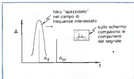
Fig. 2 - Lo stesso segnale di figura 1 studiato con un analizzatore di spettro. Qui è possibile conoscere ampiezza e frequenza delle componenti della forma d'onda vista dall'oscilloscopio.
