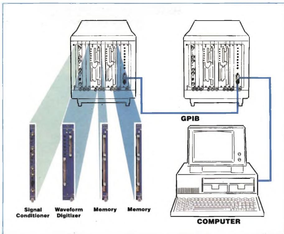
ferenti moduli digitalizzatori a seconda della velocità di campionamento e della dinamica desiderate nonché aggiungere moduli amplificatori e trigger a banda larga e altri moduli a seconda delle esigenze.
