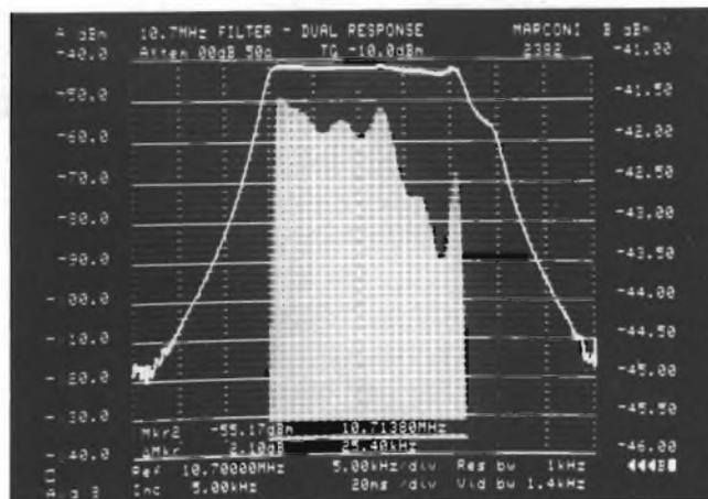
**Fig. 2 - I parametri interessanti alla misura in corso vengono visualizzati sul display assieme alle curve di risposta misurate.** Esiste la possibilità di presentazione in vari colori delle curve e dei risultati delle misure.
