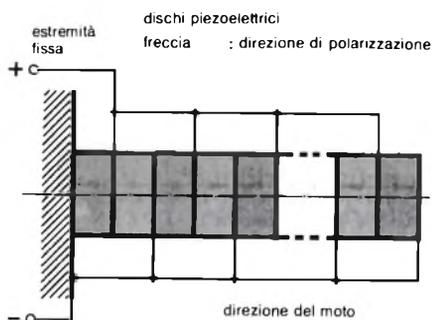
Fig. 1 - Disposizione di principio di un attuatore piezoelettrico.
