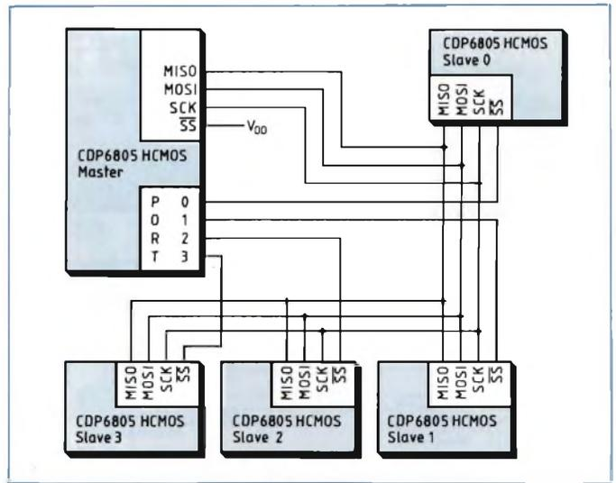
Il Master genera il clock seriale, esso controlla anche il trasferimento sincrono dei dati.
