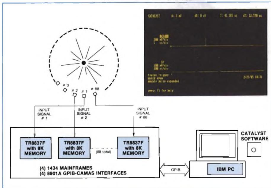
**Fig. 9 - Moduli plug-in richiesti per visualizzare traslitori di fenomeni irripetibili. A destra, il monitor indica che ricorrendo alla funzione di zoom, un impulso solitario, in realtà è formato da due impulsi molto ravvicinati tra loro.**
