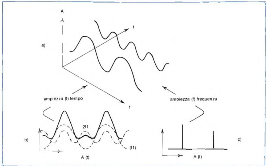
gli analizzatori di spettro vengono impiegati in quello delle telecomunicazioni dove, oltre a studiare la natura dei segnali trasmessi e ricevuti, essi servono a quantizzare in maniera estremamente esatta fenomeni come modulazione, distorsione, modulazione incrociata, frequenza, larghezza di banda e intensità di campo dei segnali, in modo che le apparecchiature possano soddisfare alle norme internazionali ben precise che fissano i valori dei suddetti parametri.
