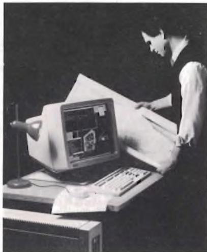
La configurazione base comprende un elaboratore MicroVAX II con 2 MB di memoria centrale; il sottosistema con video grafico QVSS; l'interfaccia di rete locale Ethernet; un monitor monocromo da 19" con risoluzione 1024 x 864 a frequenza 60 Hz; floppy disk drives da 400 Kb RX50; disco rigido Winchester da 31 MB; un "mouse" con tre tasti di funzione ed una tastiera con 15 tasti funzionali speciali.
