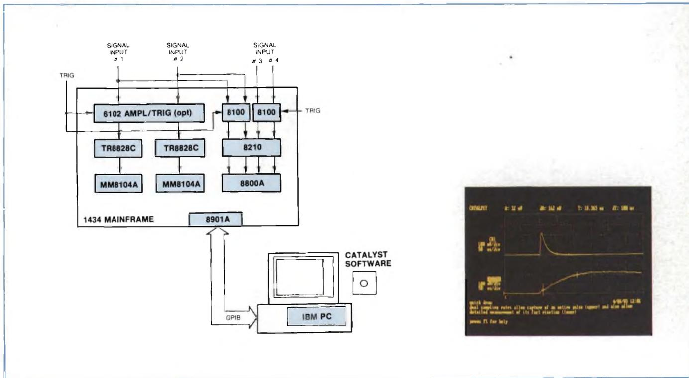
**Fig. 10 - Moduli richiesti per osservare e studiare un transistoro ricorrendo a due differenti velocità di campionamento. Nella figura, in alto, la velocità utilizzata è 200 K campionamenti/s; in basso, è 200 megacampionamenti/s.**
