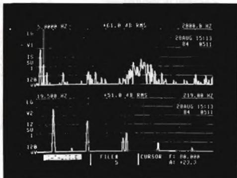
**Fig. 4 - Altro esempio di effetto zoom realizzabile con l'analizzatore 5810A. Il grafico in alto indica un picco "continuativo" in corrispondenza di 1 kHz; l'inserimento della funzione di zoom indica al contrario che il picco "continuativo" è formato in realtà da una famiglia di bande laterali di modulazione, spaziate nella misura di 5 Hz l'una dall'altra.**
