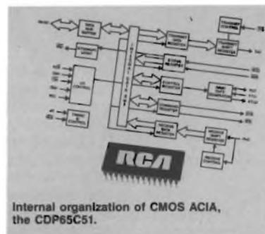
1805A e 1806A della RCA e con Zilog Z80 e 6502. La versione attualmente disponibile, chiamata - 1, funziona con microprocessori che operano in tempi di ciclo di 1 MHz.
