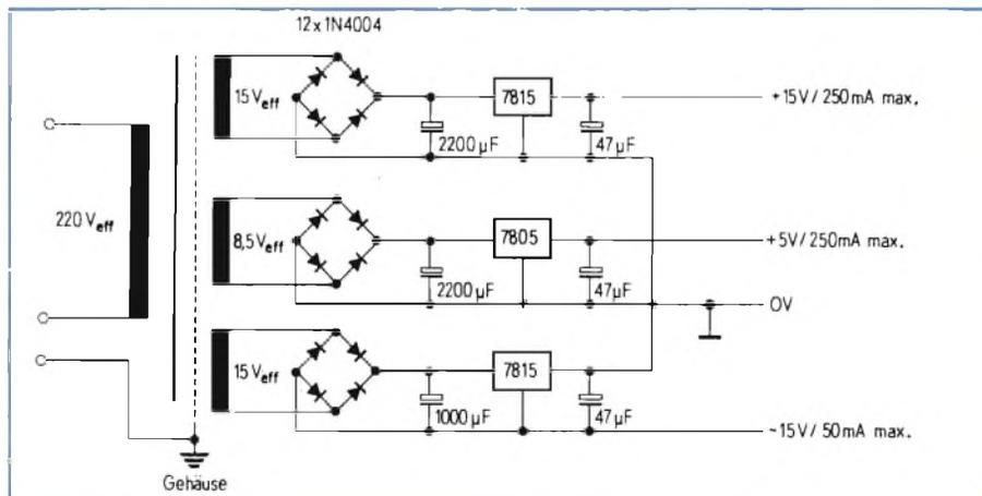
Fig. 7 - Il circuito dell'alimentatore (Gehäuse = contenitore).
