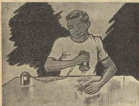
trocalamita. Costruire una elettrocalamita è semplice, e il materiale necessario per la costruzione, possiamo affermare è alla portata di tutti. Occorre in primo luogo procurarsi un nucleo che può essere tagliato da una barra di ferro a sezione rotonda, di circa 1 cm. di diametro e della lunghezza di 5,5 cm. E' possibile usare in sua vece, pure un grosso chiodo. Preparato il nucleo avvolgeremo su di esso un foglio di carta da quaderno.
