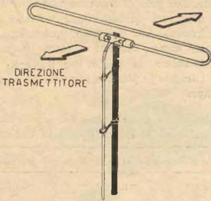
rispondenti al canale N. 5 moltiplicato per 0,95 onde ottenere il valore pratico. Perciò l'antenna per essere adatta a ricevere la frequenza di m. 1,40 dovrà avere una lunghezza di m.  $1,40 : 2 \times 0,95$  uguale a metri 0,665.
