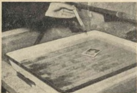
Fig. 13. — Quando la fotografia sarà un po' più scura di come la vorremmo, la toglieremo dal bagno di sviluppo per portarla nella bacinella contenente il bagno di fissaggio.
