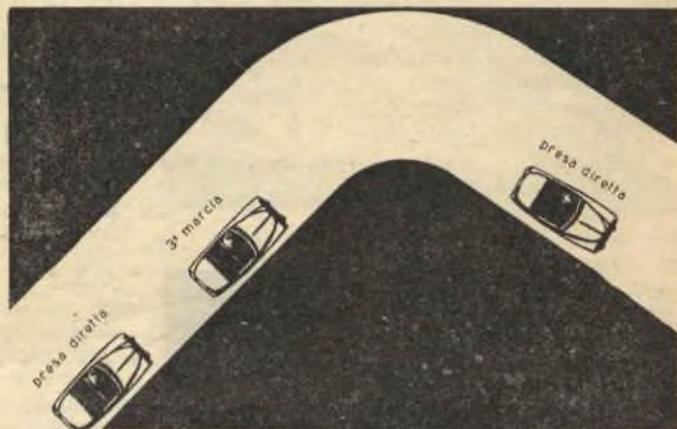
Fig. 4. — Tra i vari sistemi di abbordare una curva, questo è senz'altro quello migliore: il pilota compie la curva con la terza marcia innestata poi ripresa velocità rimette in presa diretta.
