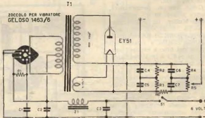
Fig. 4. — Per ottenere tensioni superiori a 300 volt sarà bene usare questo secondo alimentatore a Vibratore.
