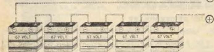
Fig. 3. — Inserendo in serie 5 pile da 67,5 volt si ottiene nel più semplice dei modi l'Alta Tensione necessaria per alimentare il tubo di Geiger-Muller.
