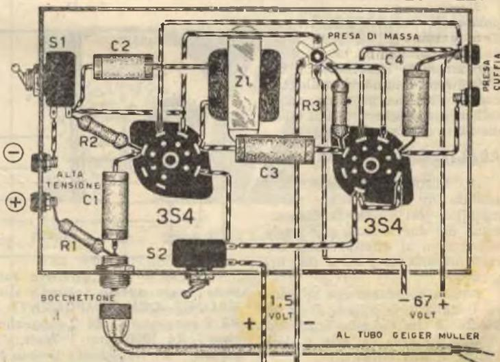
Fig. 2. — Questa è la disposizione pratica di tutti i componenti che costituiscono il Contatore di Geiger-Muller. Le due bocche a sinistra servono per applicare l'Alta Tensione necessaria per alimentare il tubo.
