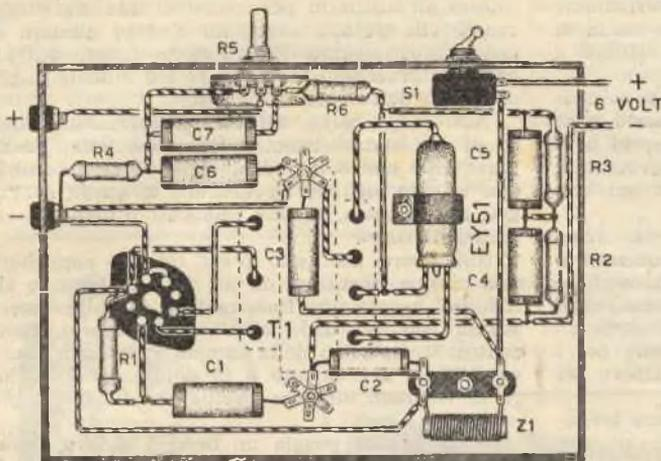
**Fig. 5. — Schema pratico di montaggio dell'alimentatore a vibratore per il Contatore di Geiger-Muller. Il vibratore 1463/6 va innestato nell'apposito zoccolo octal indicato a sinistra nel disegno. Mentre la EY51 va fissata con una fascetta di cartone al telaio.**
