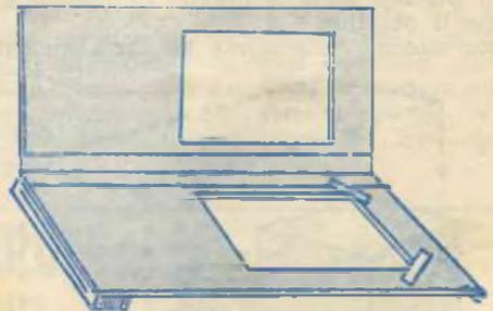
**Fig. 3 -** La funzione di questo telaio, costituito, come si vede, da un rettangolo di cartone piegato in due, ha lo scopo di presentare, ai raggi luminosi, il negativo perfettamente teso. Nelle aperture del telaio si fisseranno due vetri che basterà fermare con qualche tratto di carta gommatata.
