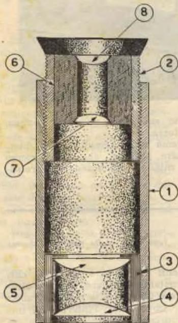
**Fig. 3 - Part. 1: tubo metallico esterno; part. 2: tubo metallico interno mobile; part. 3: tubo di cartoncino nero, portante le lenti più grandi; part. 4: prima lente dell'obiettivo; part. 5: seconda lente dell'obiettivo; part. 6: raccordo di legno portante le lenti dell'oculare; part. 7: lente interna dell'oculare; part. 8: lente esterna dell'oculare.**
