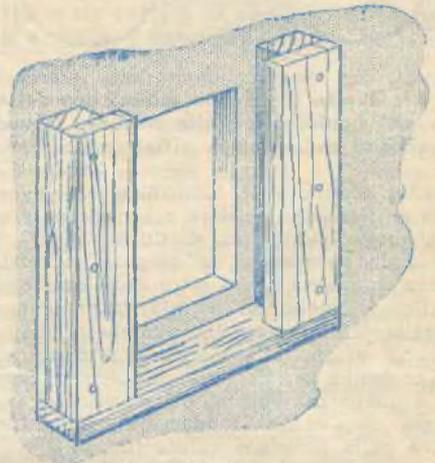
**Fig. 2 -** Nella parte esterna della cassetta, e di fronte alla finestra praticata, si fisseranno queste guide, anch'esse in legno, nelle quali scorrerà il telaio portante il negativo.
