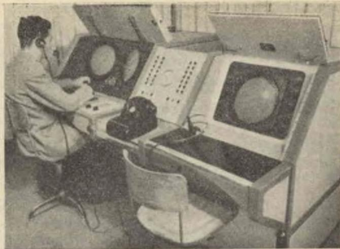
Fig. 2 — La sala di controllo e lettura Radar, si presenta di linee semplici. Il complesso si trova racchiuso in moderni banchi tipo scrivania, dai quali fuoriescono i pomelli di comando e lo schermo del Radar.
