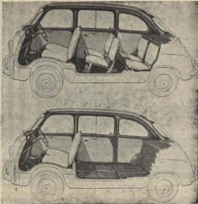
**Fig. 2. — Fiat 600 Multipla nella versione a « 6 posti ». Questa si differenzia dalla versione « 4 posti », per la parte posteriore, nella quale sono sistemati quattro sedili a poltroncina, i quali possono venire ribaltati indipendentemente l'uno dall'altro, a seconda delle necessità di carico.**
