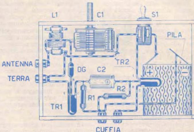
Fig. 2 - Schema pratico o cablaggio
