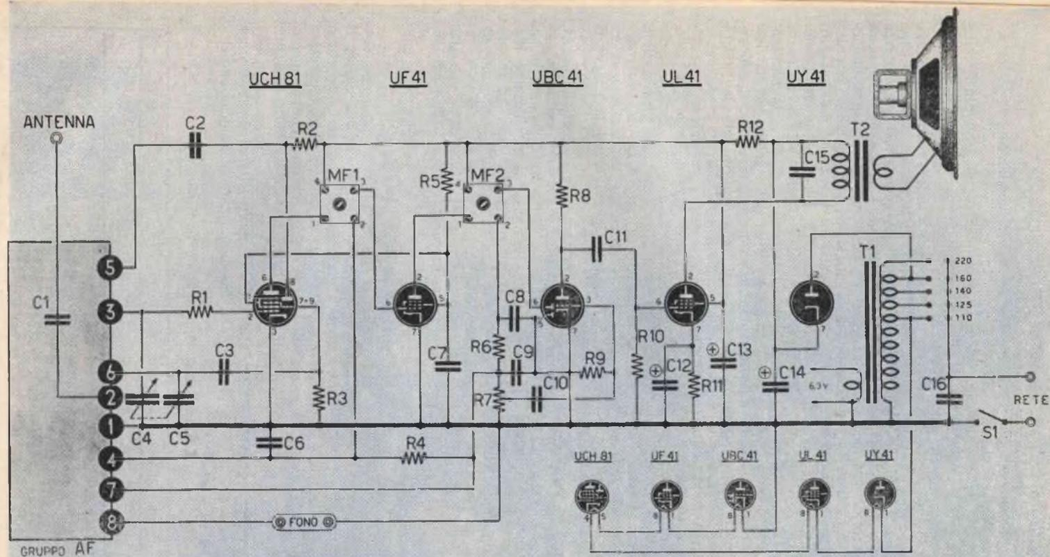
Fig. 1. — Schema elettrico.
