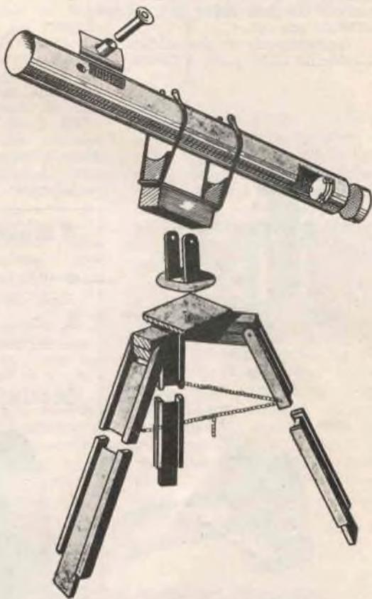
**Fig. 6 - Per l'uso razionale del telescopio si rende necessario il treppiede di sostegno, che, eliminando vibrazioni e spostamenti, ci permetterà una osservazione efficiente e stabile.**
