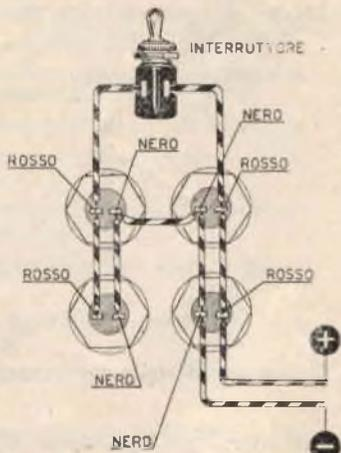
**Fig. 8 - Qualora si intenda realizzare il flash con due potenze distinte, da utilizzare a seconda delle necessità, sfrutteremo l'accorgimento indicato a figura e consistente nell'inserimento o esclusione di una parte dei condensatori mediante un interruttore.**
