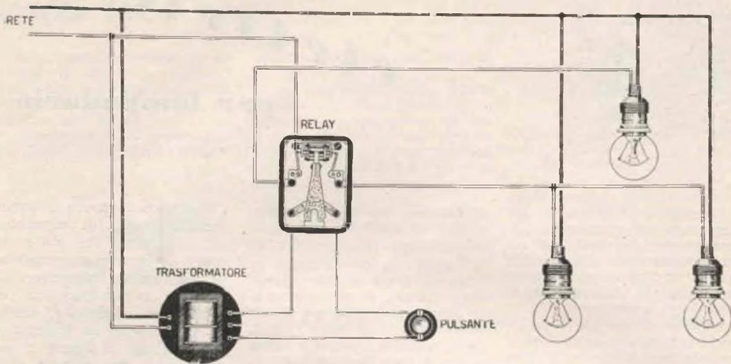
Fig. 2. — Impianto per lampadario con relay.
