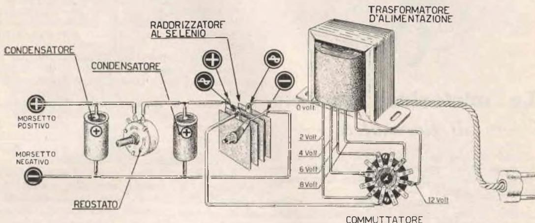
to risultasse superiore a 1,5 amper, troveremo disponibili sul mercato raddrizzatori del tipo per 16 volt - 3 amper e 16 volt - 5 amper. Ogni raddrizzatore è provvisto di 5 linguette, due esterne che vanno collegate fra di loro e dalle quali si preleva il polo NEGATIVO (-), una centrale corrispondente al polo POSITIVO (+), le altre due, poste fra centro e estremo, che si collegheranno alla corrente alternata, o più precisamente ai capi della tensione del trasformatore.
