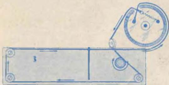
Fig. 3. — Percorso della funicella di trazione.
