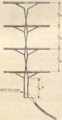
d'onda, anch'esso visibile in figura. Usando l'adattatore faremo uso di qualsiasi tipo di conduttore, trovando sperimentalmente, come abbiamo detto precedentemente al punto 2), il punto d'attacco.
