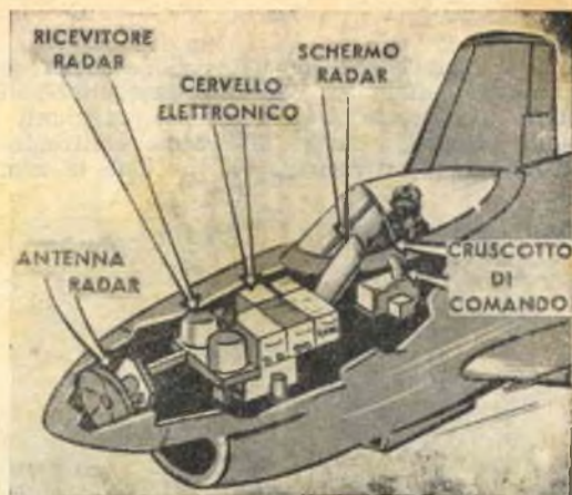
Fig. 4 - Il complesso radar-ricercatore automatico del bersaglio, trova sistemazione nella parte anteriore del velivolo. L'antenna parabolica viene alloggiata sul musone e risulta protetta da una ogiva in materia plastica che completa la linea fusiforme dell'apparecchio. Dietro l'antenna prende posto il complesso trasmettente e ricevente radar, il calcolatore elettronico, il quale ultimo comanda, qualora il velivolo nemico venga a trovarsi nel raggio d'azione, le mitragliere e i razzi.
