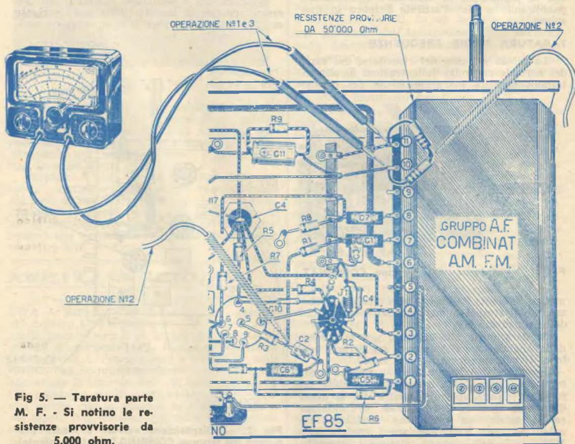
Fig. 5. — Taratura parte M. F. - Si notino le resistenze provvisorie da 5.000 ohm.
