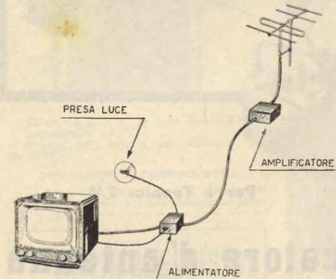
Fig. 1. - Schema sintetico dell'applicazione.
