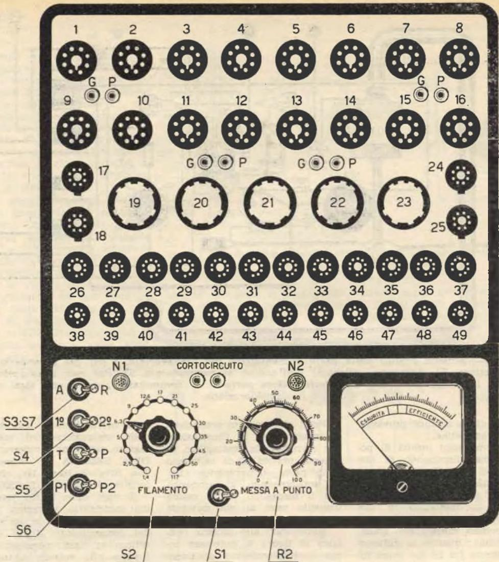
**Fig. 4. — Vista frontale del pannello, completo dei comandi necessari. Il pannello risulta in metallo (preferibilmente in alluminio lucidato o verniciato alla nitro). Gli zoccoli sistemati sul pannello sono contrassegnati da un numero progressivo, che permette l'utilizzazione rapida della tabella n. 2.**
