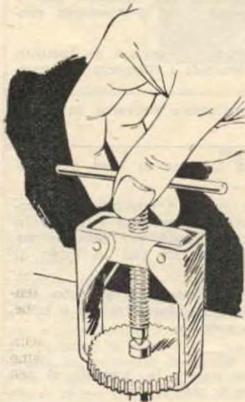
Tutti sanno che cosa sia un estrattore e quale importanza esso assuma nel caso si presenti la necessità di sfilare volani, puleggie e ruote dentate dai rispettivi alberi di rotazione.
