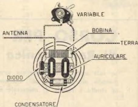
Fig. 2. - Sistemazione componenti all'interno dell'auricolare.
