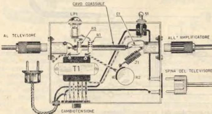
Fig. 4. - Schema pratico alimentatore.
