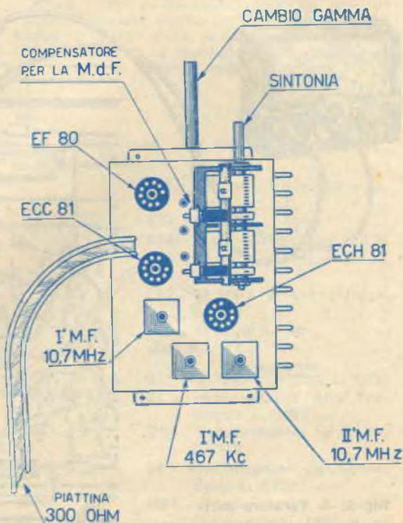
Fig. 2. — Disposizione valvole e Medie Frequenze nel Gruppo COMBINAT (vista in pianta).
