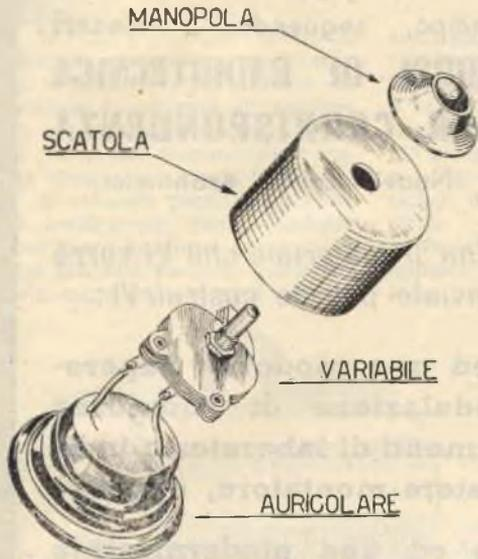
Fig. 3. - Sistemazione condensatore e manopola sul retro dell'auricolare.
