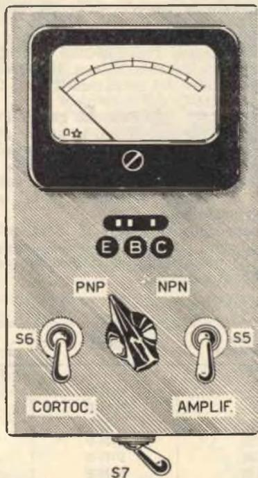
Fig. 3 - Pannello frontale del prova-transistori.
