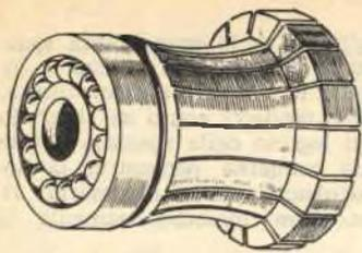
**Collettore inefficiente.** In tali condizioni il collettore non è in grado di stabilire il necessario collegamento con le spazzole, per cui necessiterà procedere alla tornitura del medesimo per la sua rimessa in efficienza.
