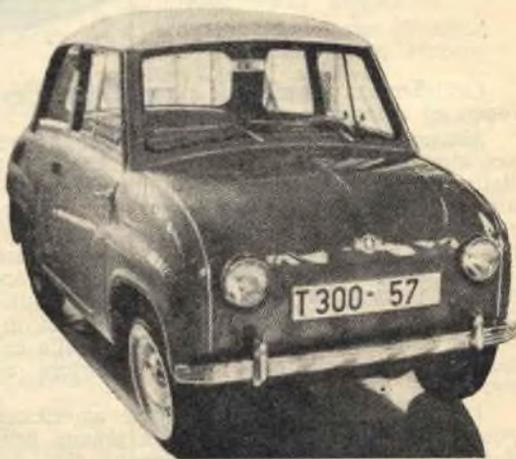
**GERMANIA** - La GOGGOMOBOL è la vettura alla quale arride il maggior successo in Germania. Viene costruita in due diversi tipi. La rappresentata a figura è munita di motore bicilindrico 250 cc. - velocità massima 85 Km/h - consumo 1 litro per 25-26 Km.
