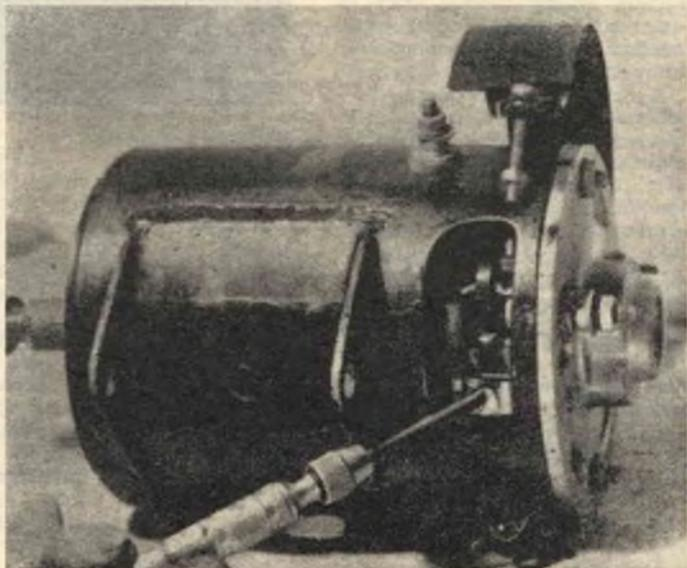
**Per lo smontaggio delle spazzole necessita allentare per prima cosa la fascia che abbraccia la parte posteriore della dinamo e in un secondo tempo svitare la vite che fissa il filo della spazzola al terminale di utilizzazione.**
