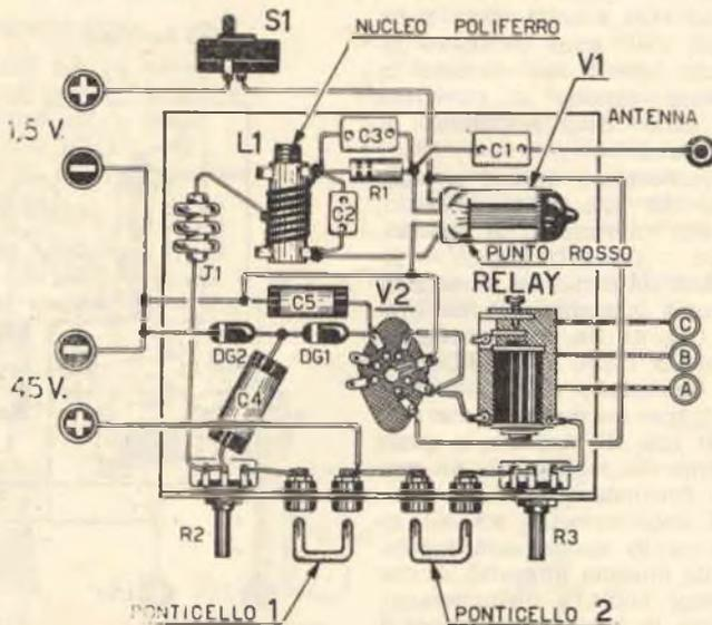
Fig. 8 - Schema pratico di ricevente bivalvole con 1 valvola a gas - 1 valvola 3S4 e 2 diodi di germanio
