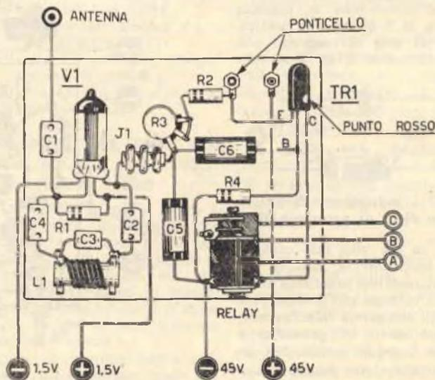
Fig. 10 - Schema pratico di ricevente monovalvolare + 1 transistor
