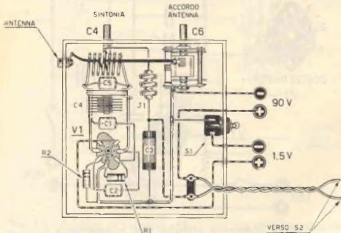
Fig. 21 - Schema pratico del trasmettitore
