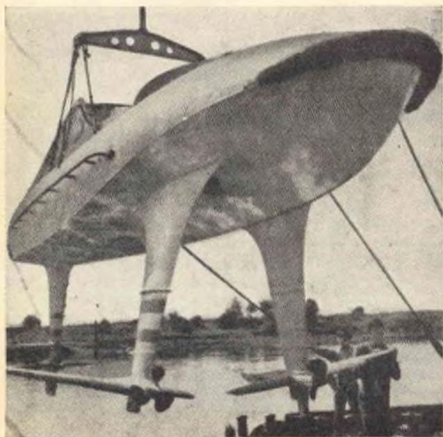
**Fig. 3 - Lo stesso scafo tedesco in bacino di carenaggio. Si notino le alette subacquee e la sistemazione delle eliche.**
