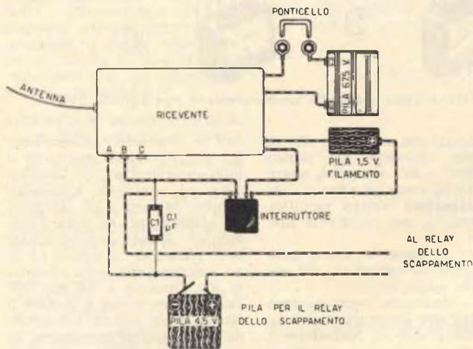
**Fig. 18** - Schema di collegamento delle pile di alimentazione per il funzionamento del ricevitore e dello scappamento. Si rende necessario l'inserimento, in parallelo ai due contatti del relay, di un condensatore a carta (C1) della capacità di 0,1 mF. Per l'inserimento o disinserimento delle pile nel circuito, viene utilizzato un interruttore doppio.
