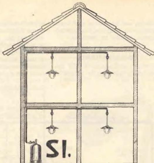
Fig. 10. - Installazione corretta della bombola.
