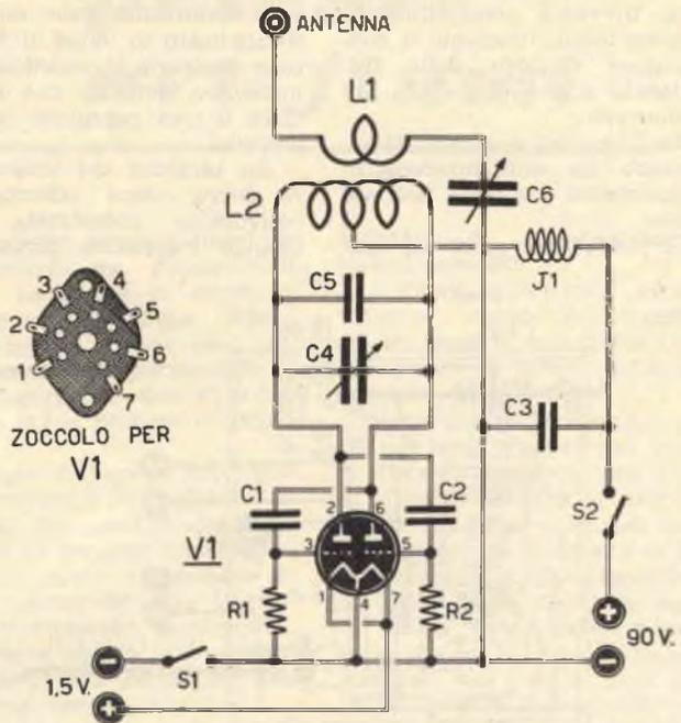
Fig. 19 - Schema elettrico del trasmettitore
