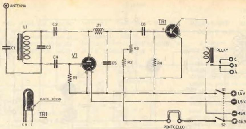
Fig. 9 - Schema elettrico di ricevente monovalvolare + 1 transistor
