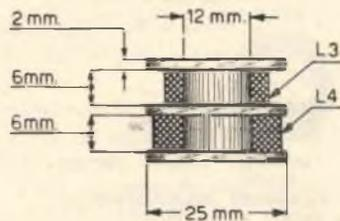
Fig. 13 - Dati costruttivi per bobine L3 - L4
