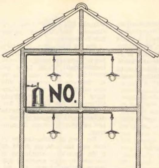
Fig. 9. - Installazione errata della bombola.
