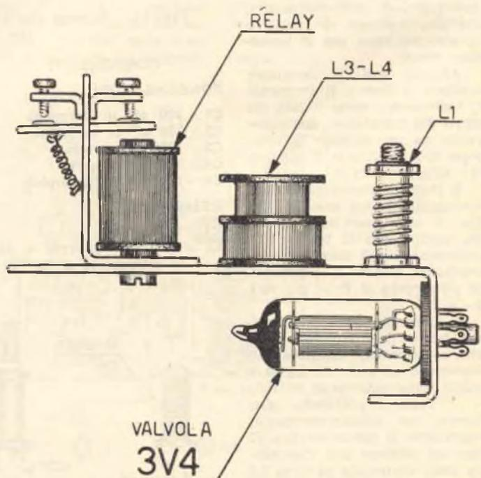
Fig. 15 - Disposizione di fianco dei componenti
