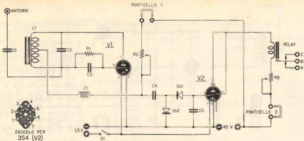
Fig. 6 - Schema elettrico di ricevente bivalvole con 1 valvola a gas - 1 valvola 3S4 e 2 diodi di germanio
