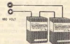
Fig. 22 - Collegamento in serie di due pile da 90 volt
