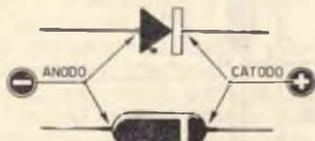
Fig. 7 - Indicazione di polarità per diodi di germanio OA85
