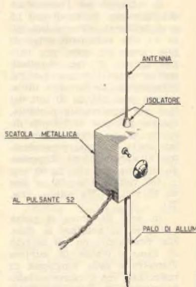
Fig. 24 - Complesso trasmettitore-antenna
