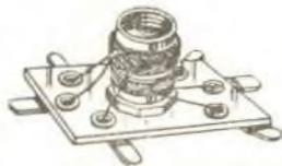
Fig. 7 - Disposizione terminale bobina oscillatrice L2 su basetta.
