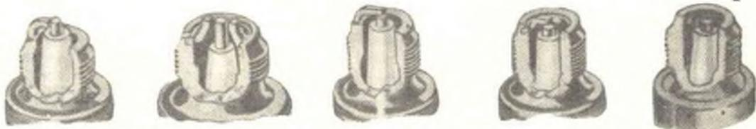
Fig. 3. — Vari esempi di sistemazione dell'elettrodo centrale rispetto quello di massa.
