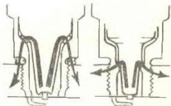
**Fig. 10.** — Dall'esame della figura risulta facilmente comprensibile la differenza esistente fra candela calda e candela fredda. Il percorso di dispersione in una candela calda risulta più elaborato nei confronti di quella fredda.
