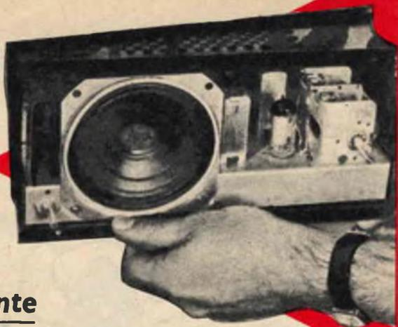
Tal tipo di ricevitore — adatto per le onde medie — risulta quanto mai efficace e potrà essere realizzato con facilità da quanti sperimentarono per il passato ricevitori a diodi al germanio.
