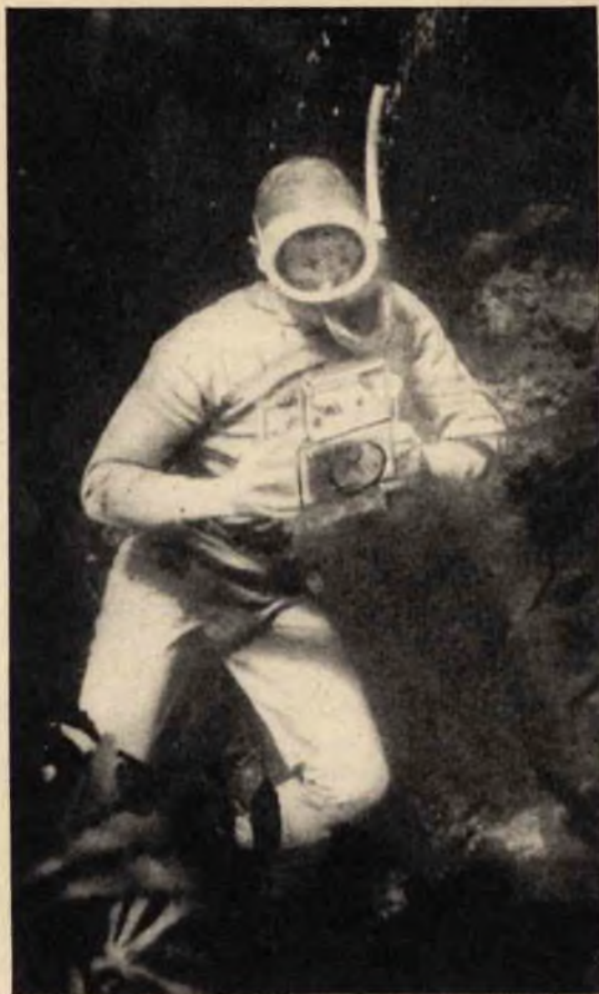
Fig. 6 - Per l'immersione a profondità, il subacqueo indosserà tute a tenuta perfettamente stagna per la difesa dal freddo.
