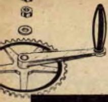
Fig. 3 - Complesso moltiplica-pedale per la trasmissione di moto all'albero.
