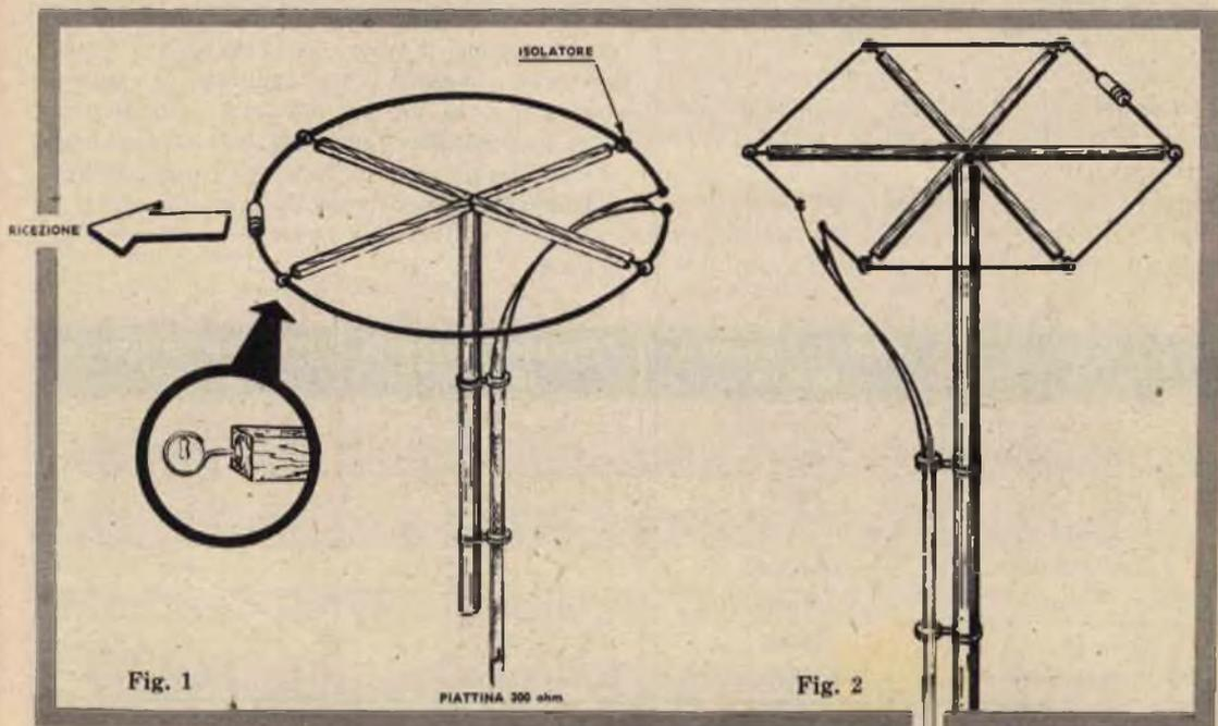
reazionale, cioè in grado di ricevere o trasmettere in un solo senso. Più precisamente l'antenna riceve e trasmette dal punto di congiunzione dei due bracci, congiunzione che si realizza tramite una resistenza del valore di 470 ohm - 1 watt (fig. 3).
