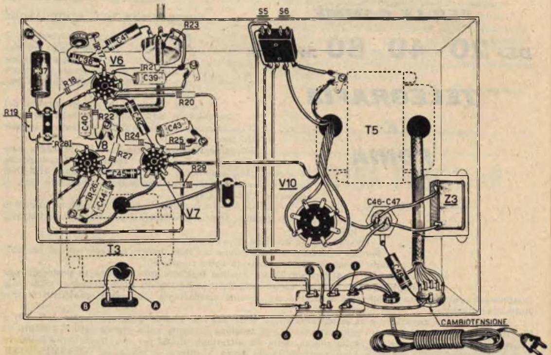
Fig.8 - Schema pratico del modulatore. A sinistra in basso: le prese A e B dovranno collegarsi con le corrispondenti A e B del trasmettitore (vedi figura 9).
