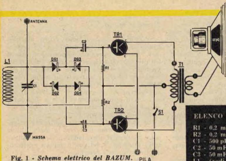
Fig. 1 - Schema elettrico del BAZUM.
