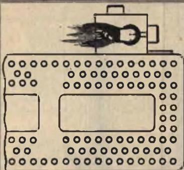
Fig. 14 - La fiamma pilota sul bruciatore deve venire disposta di lato, in modo da evitare che la fiamma del bruciatore stesso possa colpire la termocoppia.
