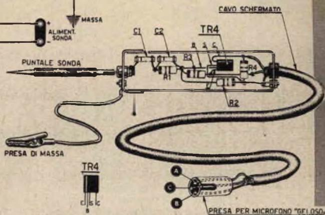
Fig. 4 - Schema pratico della sonda
