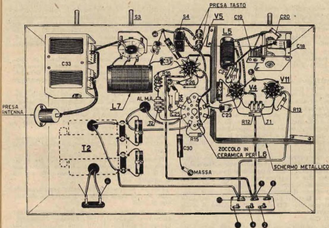
Fig. 9 - Schema pratico del trasmettitore. Da notare la schermatura della parte oscillatrice. Lo zoccolo octal centrale serve all'inserimento della bobina L6.
