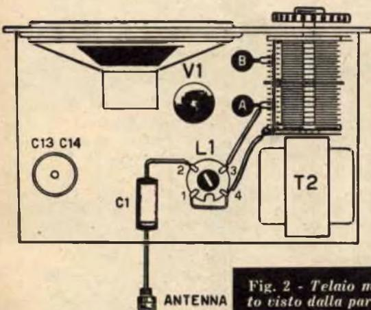
**Fig. 2 - Telaio montato visto dalla parte superiore.**
