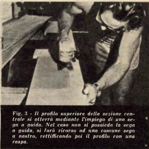
**Fig. 3 -** Il profilo superiore della sezione centrale si otterrà mediante l'impiego di una sega a guida. Nel caso non si possieda la sega a guida, si farà ricorso ad una comune sega a nastro, rettificando poi il profilo con una raspa.
