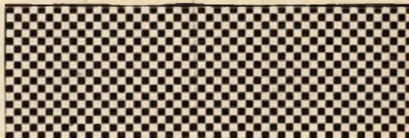
Fig. 1 - Lo specchio B dovrà risultare raschiato a scacchiera in maniera di avere un quadro sì e uno no e superficie argentata. La soluzione migliore resta la raschiatura a scacchiera, ma pure una raschiatura a strisce permetterà un risultato di poco inferiore.
