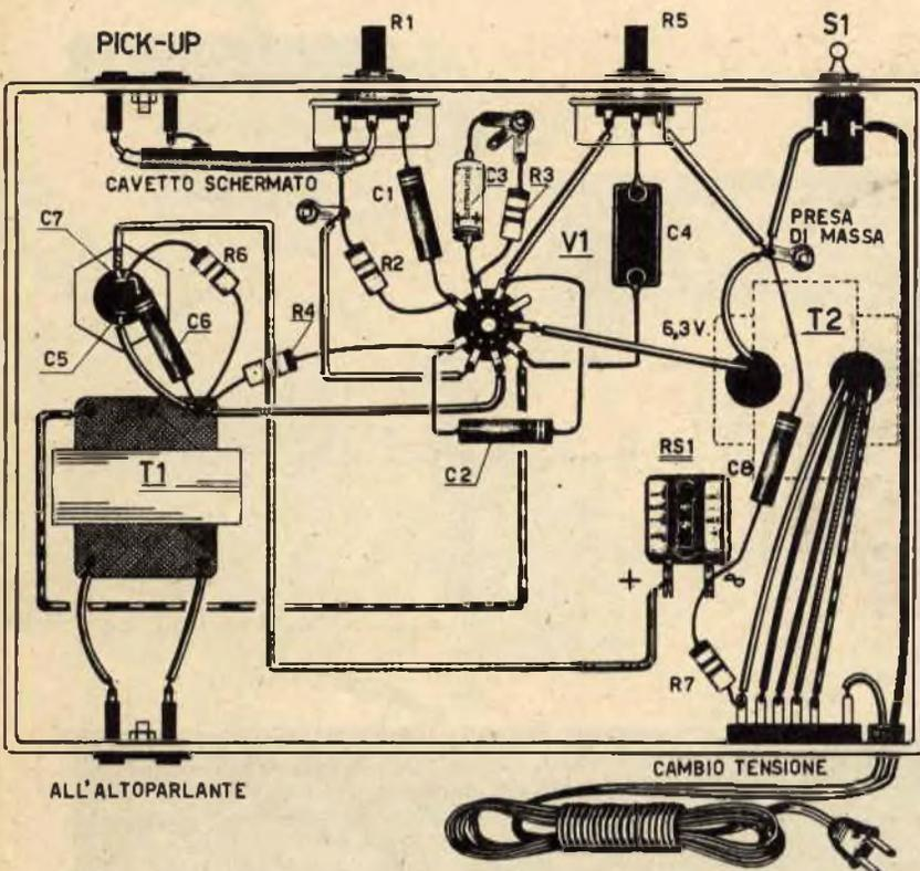
legamento tra il centro del potenziometro di volume R1 e la presa pick-up dev'essere effettuato con filo schermato. Se questo inconveniente non fosse scongiurato del tutto si dovrà schermare anche il condensatore C1.
