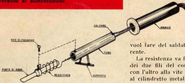
lunghezza più adatta da assumere a seconda che si desideri un saldatore a riscaldamento immediato oppure un saldatore normale da banco da poter mantenere acceso per un'ora e più.
