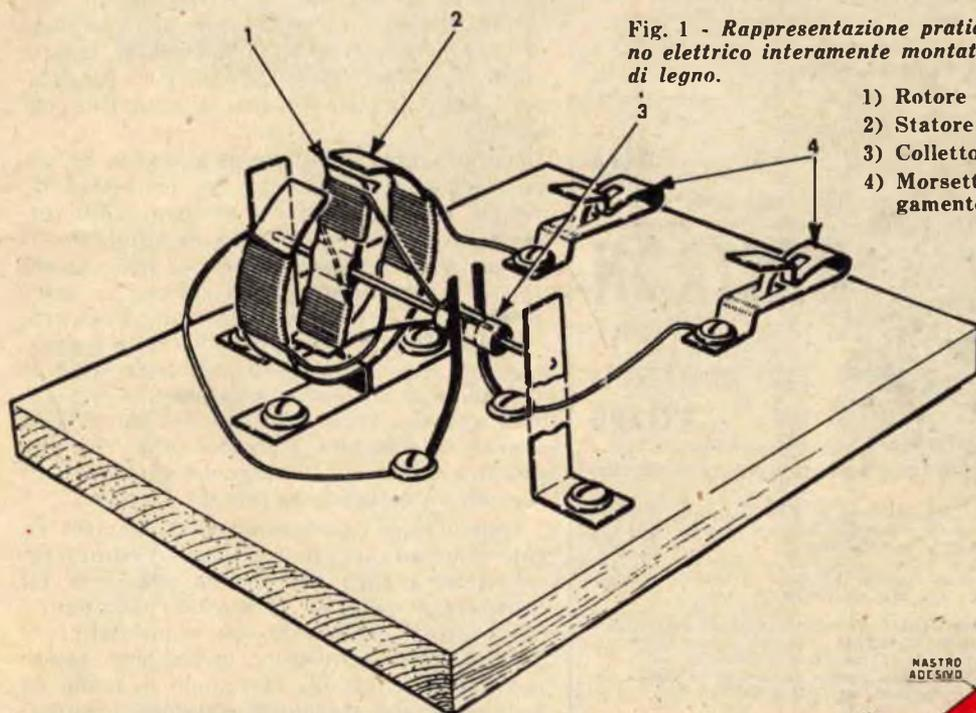
Fig. 1 - Rappresentazione pratica del motorino elettrico interamente montato su tavoletta di legno.
