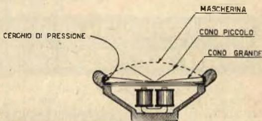
Fig. 4 - Altoparlante di fig. 3 visto in sezione.
