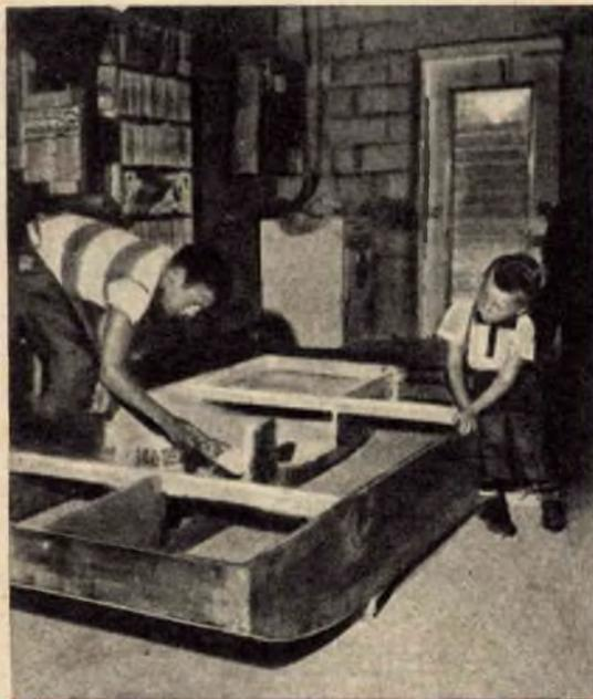
**Fig. 8** - La verniciatura interna dello scudo si esegue prima della sistemazione dei sedili sui regoli di sostegno. A un primo strato di fondo in cementite, faranno seguito due mani di smalto di buona qualità.
