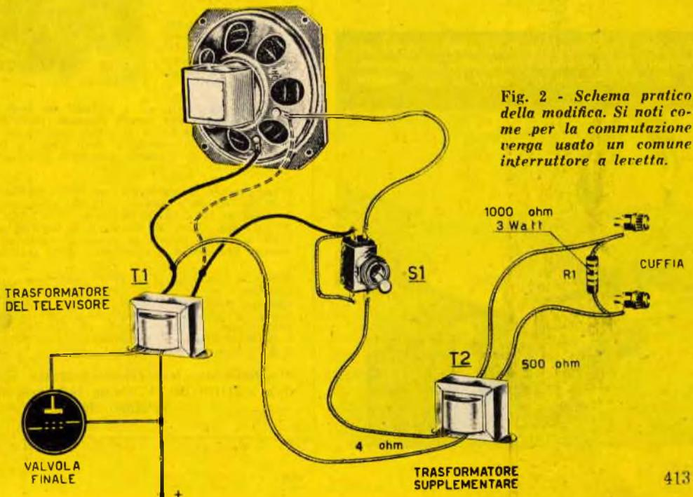
Fig. 2 - Schema pratico della modifica. Si noti come per la commutazione venga usato un comune interruttore a levetta.
