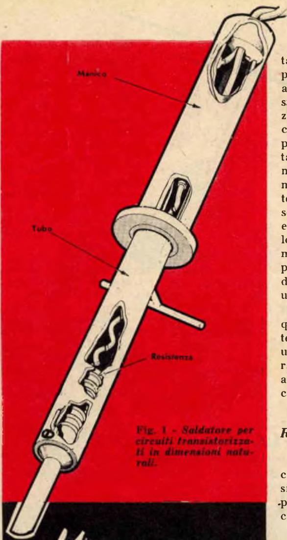
Fig. 1 - Saldatore per circuiti transistorizzati in dimensioni naturali.
