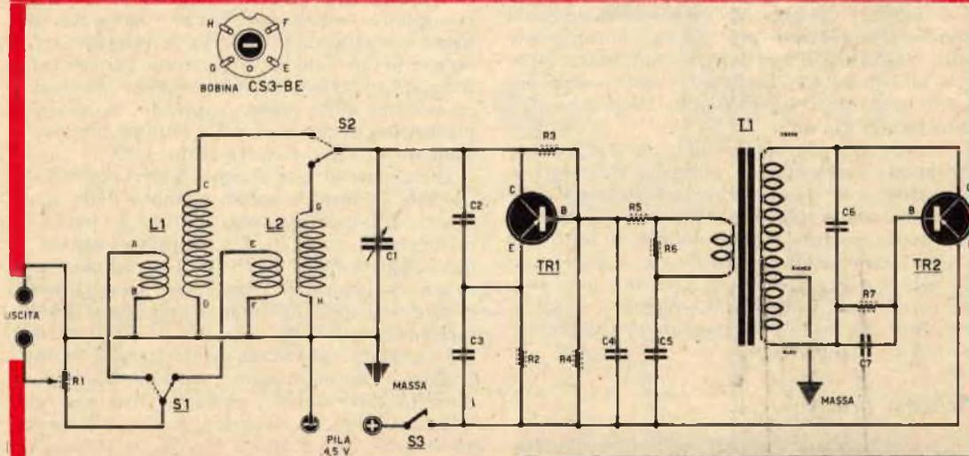
Fig. 2 - Schema elettrico dell'oscillatore modulato.
