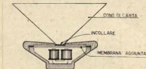
**Fig. 2 - L'altoparlante di figura 1 è qui rappresentato visto in sezione.**
