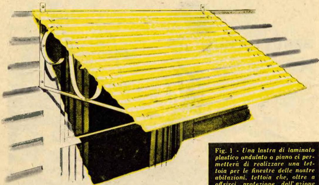
**Fig. 1 - Una lastra di laminato plastico ondulato o piano ci permetterà di realizzare una tettoia per le finestre delle nostre abitazioni, tettoia che, oltre a offrirci protezione dall'azione diretta dei raggi solari, non si attingerà nè si logorerà come nel caso dei tendaggi in tela.**
