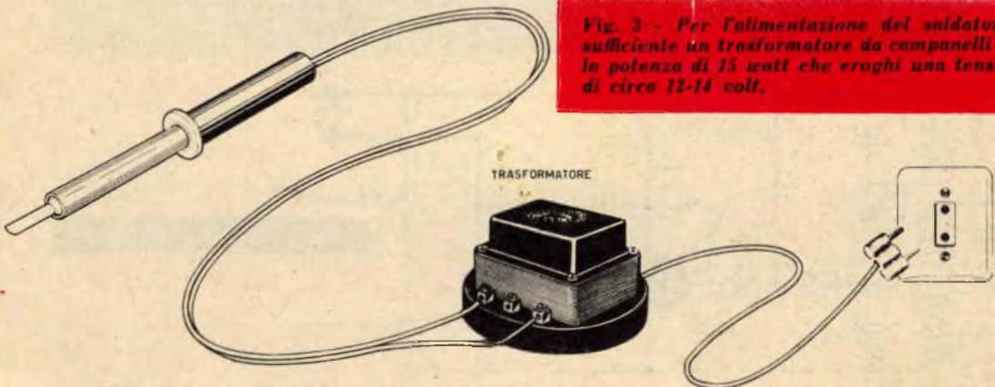
**Fig. 3 - Per l'alimentazione del saldatore è sufficiente un trasformatore da campanelli della potenza di 15 watt che eroghi una tensione di circa 12-14 volt.**
