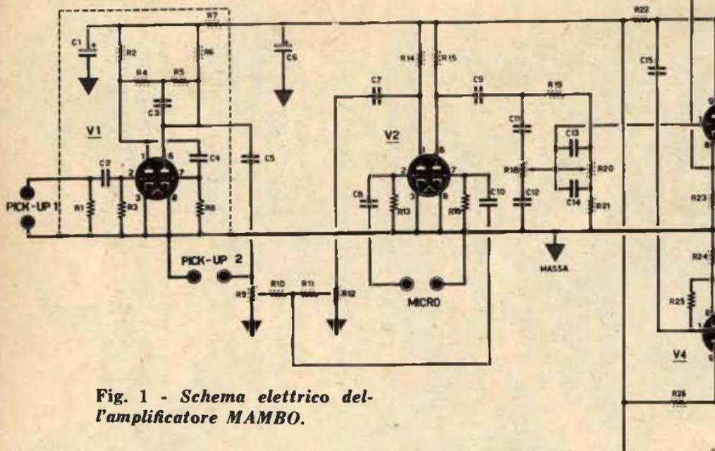
Fig. 1 - Schema elettrico dell'amplificatore MAMBO.
