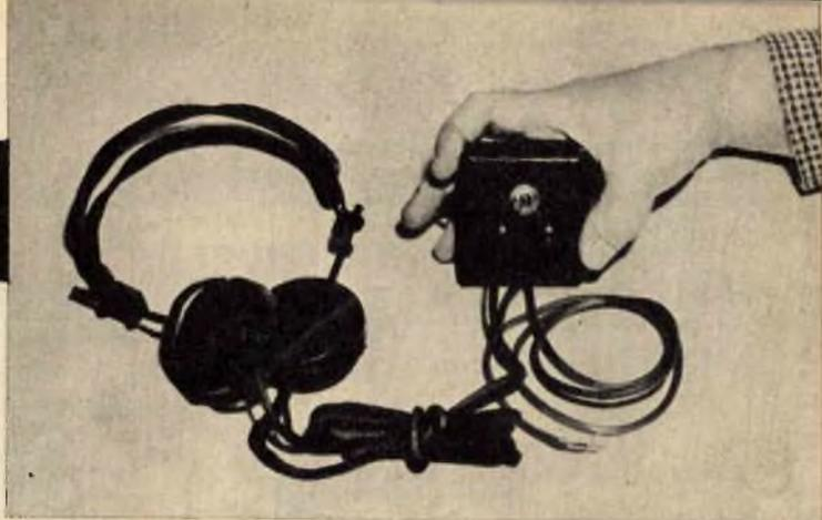
far funzionare le cuffie stesse. Per cui necessita ricorrere ad un altro trasformatore d'uscita della potenza massima di 3 watt, il cui secondario presenti un'impedenza da 2 a 4 ohm e il primario un'impedenza pari a 500 ohm.
