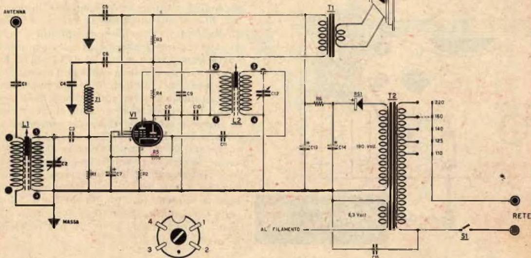
scelte a piacere. In figura 2 è rappresentato il telaio visto dalla parte superiore. I componenti sistemati in questa parte sono: il condensatore variabile (C2 - C12), il trasformatore d'alimentazione T2, la bobina d'alta frequenza L1, la valvola V1, il condensatore elettrolitico doppio a vitone e l'altoparlante; quest'ultimo però potrà essere mantenuto separato dal telaio e fissato con viti direttamente nel retro del pannello frontale del mobile.
