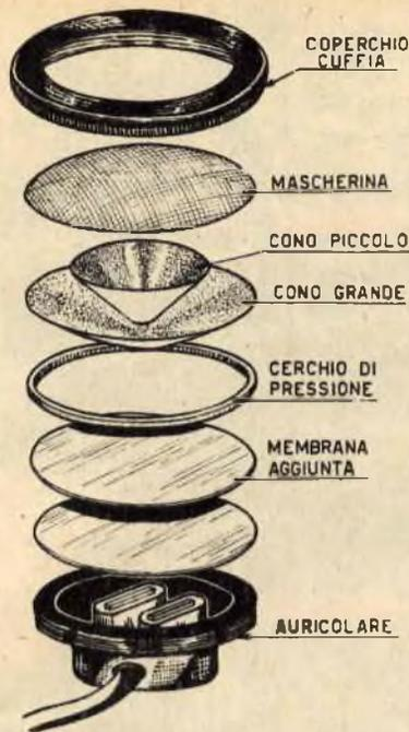
Fig. 3 - Altro tipo di altoparlante ottenibile dall'auricolare di una cuffia scomposto nei suoi elementi. L'anello di chiusura può essere ricavato dallo stesso coperchio della cuffia adoperando un seghetto da traforo ed una lima mezzo tonda.
