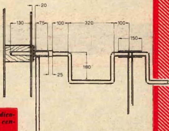
Fig. 10 - Dimensioni della manovella e indicazioni di montaggio sulle sezioni laterali e centrale dello scafo.
