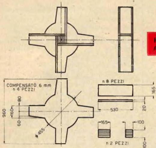
Fig. 9 - Dimensioni e profilo delle parti componenti le ruote a pale.
