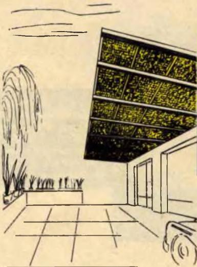
**Fig. 4 - Le verande di edifici moderni potranno godere di una copertura a tettoia in laminato plastico ondulato o piano. Una tettoia di tal genere, pur permettendo il passaggio della luce, riparerà dall'azione violenta e diretta del sole, nonché dalle intemperie.**
