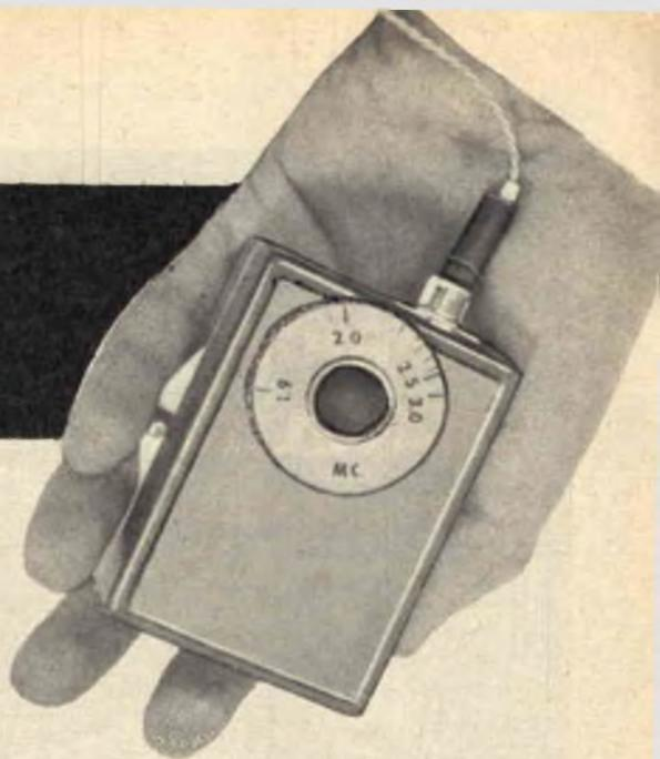
La pila di alimentazione del circuito è a 9 volt. L'ascolto è ottenuto mediante un auricolare di tipo ad oliva per sordi.
