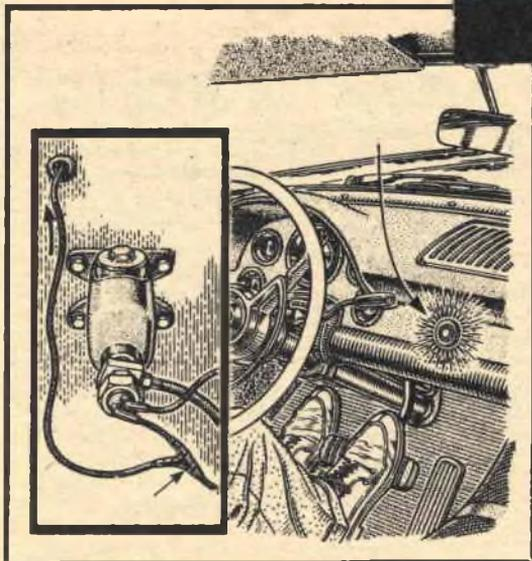
Non sarebbe certo un accorgimento inutile quello di applicare sul cruscotto una lampadina-spia in grado di accendersi quando si accendono i fanalini dello STOP. Niente elettroauto per un simile facile impianto. Basta collegare un cavetto bifilare alla lampadina-spia opportunamente fissata al cruscotto e fissare il cavetto all'interruttore applicato alla pompa del freno: più precisamente al cavetto che porta la corrente alle lampadine dello STOP.
