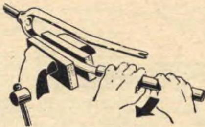
Fig. 2 - Per raddrizzare la forcella usiamo un tubo per far leva.
