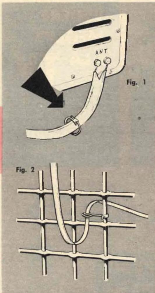
**Fig. 1 - Un qualsiasi oggetto metallico che recinga la piattina di discesa di un televisore può influire a modificare notevolmente la potenza del segnale alta frequenza captato. Provate ad infilare un anello nella piattina, muoverlo avanti-indietro, potrete voi stessi constatare quanto affermiamo.**
