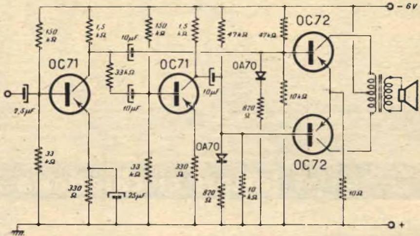
Lo schema che Lei ha visto pensiamo sia quello riprodotto in figura. Si tratta in verità di un sistema di accoppiamento diretto tra lo stadio pilota e i due transistor finali in push-pull che non richiede nessun trasformatore di accoppiamento. Nello schema troverà anche i valori dei vari componenti nel caso desiderasse sperimentarlo. Il vantaggio di questo schema è uno solo maggior fedeltà di riproduzione, abbiamo per con-
