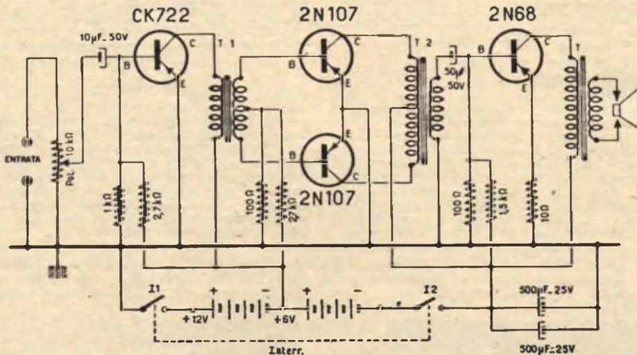
**Sig. DI MARCA LUIGI.** - Roma. - Dispongo di un transistor 2N68 di due 2N107 del trasformatore d'uscita e quelli di accoppiamento per 2N68 ora vorrei costruire un piccolo amplificatore a transistor che penso di utilizzare in molte applicazioni, ad esempio per giradischi per auto, elettrofono, ecc., megafono ecc. Vorrei sapere anche quale potenza è in grado di fornire lo schema che mi consiglierete.
