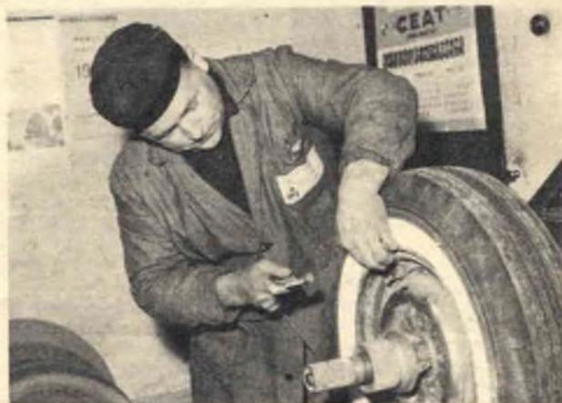
**Fig. 2 - Constatata con la macchina la squilibratura della ruota, si applicherà il piombo necessario nella grammatura e nella posizione del cerchio indicato dal quadrante della macchina stessa.**
