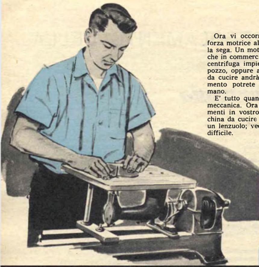
Ora vi occorre un motorino che imprima la forza motrice alla macchina destinata a muovere la sega. Un motorino da 1/8 di cavallo, di quelli che in commercio trovate abbinati ad una pompa centrifuga impiegata per estrarre l'acqua da un pozzo, oppure anche un motorino per macchina da cucire andrà benissimo ed anche questo elemento potrete facilmente trovarlo di seconda mano.
