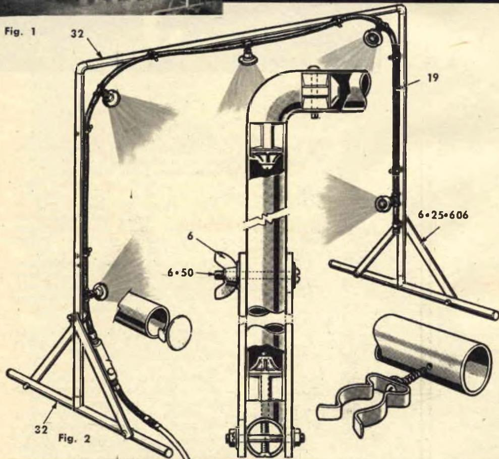
Fig. 3 - Potrete usare come diffusori quelli che servono per l'irrigazione delle aiuole dei giardinieri, che sono in grado di assicurarvi un getto d'acqua uniforme, e che potrete facilmente acquistare in ogni ferramenta a prezzi convenienti. Diversamente potrete usare i diffusori installati nei bagni a doccia.
