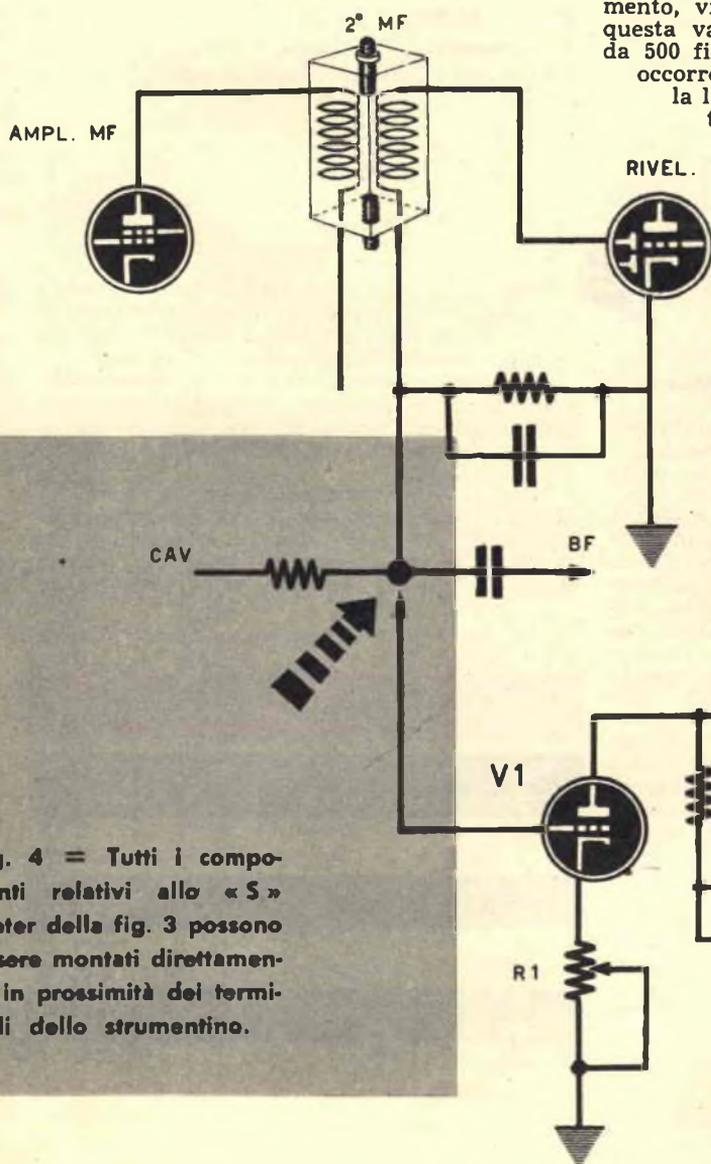
Fig. 4 = Tutti i componenti relativi allo «S» Meter della fig. 3 possono essere montati direttamente in prossimità dei terminali dello strumentino.
