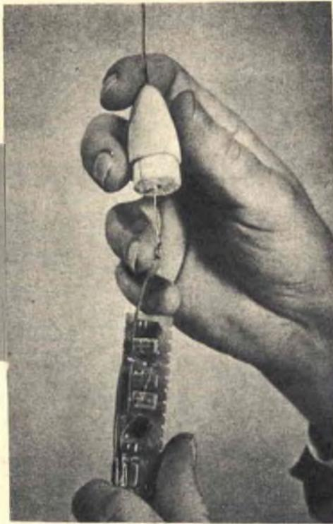
Fig. 2 - L'antenna uscirà dall'oggiva del missile e sarà costituita da un sottile spezzone di acciaio.
