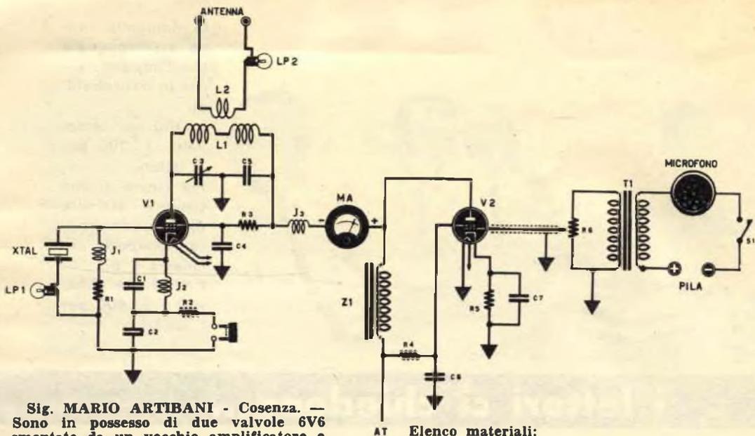
**Sig. MARIO ARTIBANI - Cosenza.** — Sono in possesso di due valvole 6V6 smontate da un vecchio amplificatore e vorrei usarle nella costruzione di un piccolo trasmettitore per telegrafia e a voce; dispongo anche di un alimentatore che mi fornisce la tensione di 300 volt a circa 100 mA. Se ciò è possibile vi prego volermi inviare uno schema che non usi trasformatori di modulazione.
