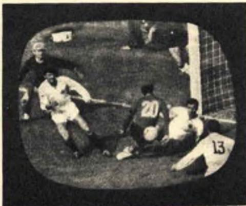
**Fig. 5 - Foto eseguita con pellicola KODAK X con una macchina VITO-B, tempo 1/25 f. 8, con un televisore da 21 pollici PHILIPS.**
