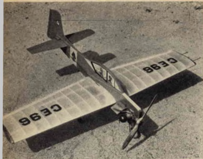
Fig. 4 - Il « TRAINER » pronto per la partenza. Basterà avviare il motore facendo compiere qualche giro all'elica con il dito ed inizierà il volo circolare fino ad esaurimento della riserva di carburante.
