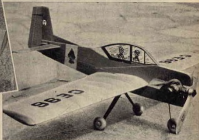
Fig. 3 - Osservate i particolari relativi alla sistemazione del motore e del relativo serbatoio per il carburante. Anche il carrello di atterraggio a tre ruote molleggiato rende facile le operazioni di decollo e atterraggio.
