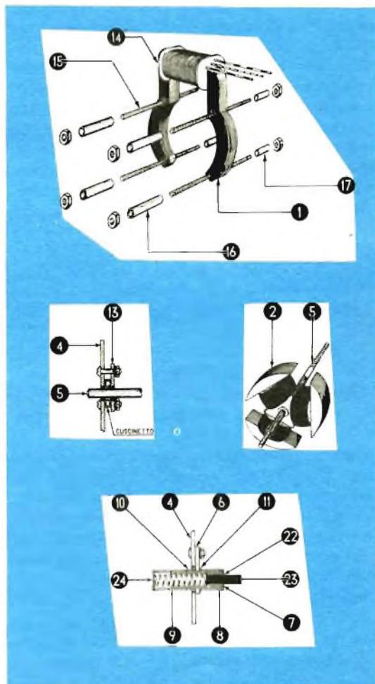
Dall'alto in basso, sono visibili i particolari: a) per il montaggio del gruppo statorico; b) il montaggio del cuscinetto per l'asse, dal lato opposto della puleggia; c) per il serraggio del pacco lamierini rotore; d) portaspazze.
