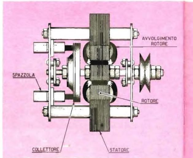
Ben s'intende che per l'esecuzione del diametro esterno avremo provveduto a serrare il pacco di lamierini mediante un bulloncino, inserito nel foro centrale, con relativo dado.
