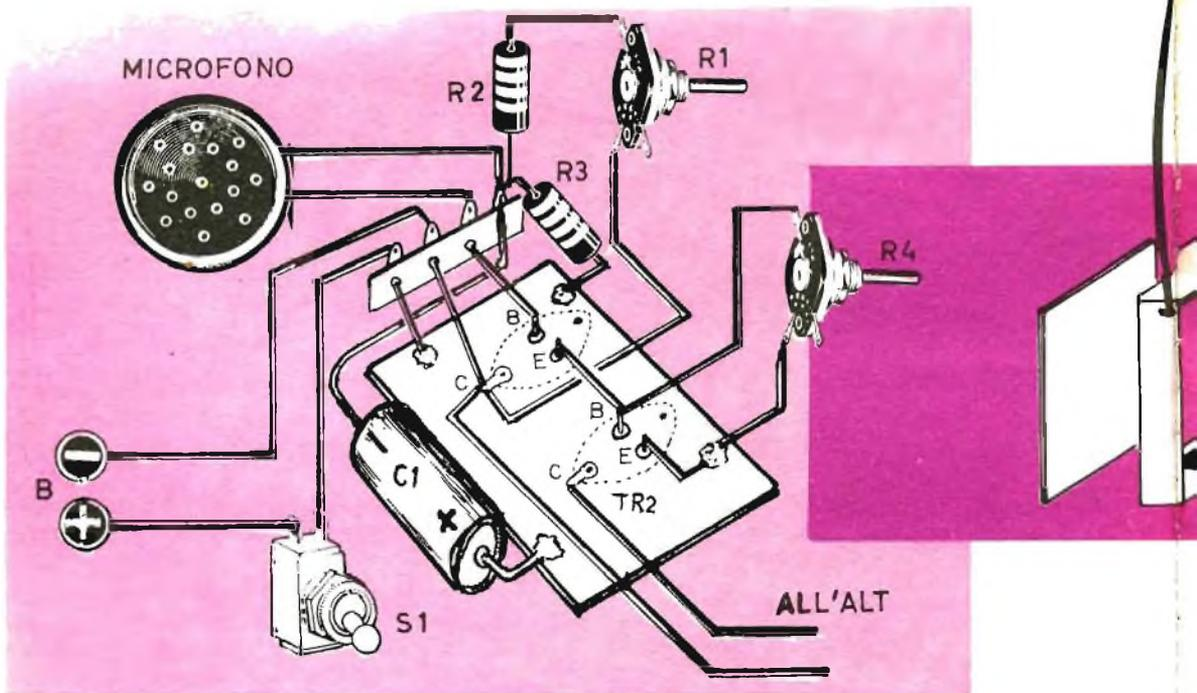
le del microfono, è disposto un condensatore (C1), in modo da rendere il circuito «freddo» per l'audio. Il transistor TR1 è accoppiato direttamente, e per aggiustare le polarità rispettive, ha l'uscita sull'emettitore. Questa configurazione, ha lo scopo primo ed evidente di semplificare il complesso; però questa connessione del transistor serve anche per adattare ottimamente la sua impedenza d'ingresso e d'uscita.
