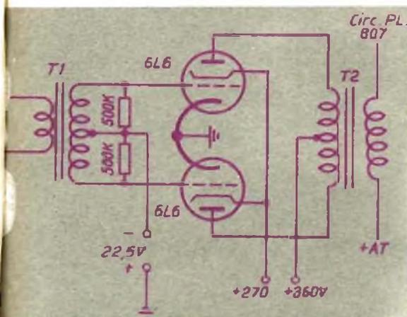
Un possibile uso dell'amplificatore BF del sig. Anania è invece quello di «pilota», ossia di preamplificatore di potenza, capace di pilotare uno stadio finale BF della potenza necessaria alla modulazione.
