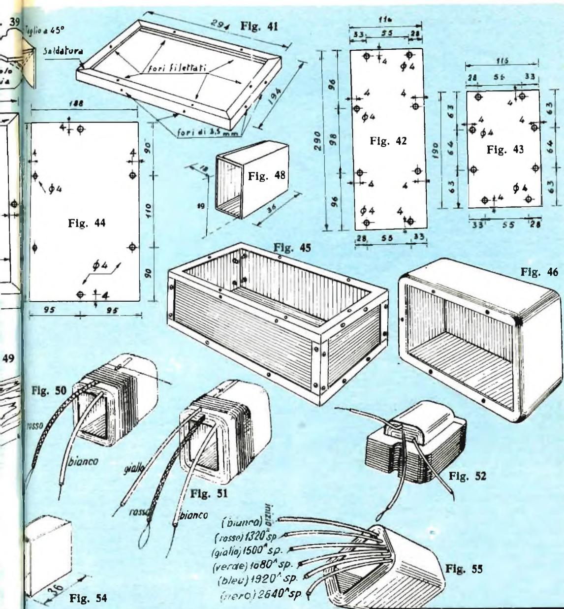
interrompere il filo, si passa attraverso l'intacca del secondo dischetto nella gola successiva (compresa fra il 2° e il 3° dischetto). Avvolte altre 31 spire si passa direttamente attraverso l'intacca del 3° dischetto nell'ultima gola ove si avvolgono altre 31 spire.
