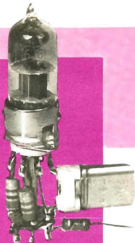
*Un piccolo strumento che unisce alla notevole semplicità anche l'utilità. Genera una serie di frequenze stabilizzate a cristallo e può essere impiegato, ad esempio, per la taratura dei ricevitori, oppure per verificare la calibratura in frequenza di un generatore di segnali, di un grid-dip-meter, per lavori sperimentale, ecc.*
