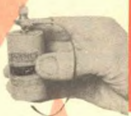
Fig. 1: Per provare rapidamente le pile, si può usare un filo d'acciaio, un coccodrillo ed una lampadina dell'adatta tensione: i tre, montati come si vede nella figura, costituiscono un tutto pratico e rapido nell'uso.
