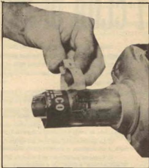
occorre invece una pazienza certosina quando la trappola deve essere rimontata: eh, sì, perchè la luminosità dal cinescopio dipende strettamente dalla posizione del pezzo: basta un minimo spostamento e la visione peggiora in maniera notevolissima o risulta del tutto impossibile.
