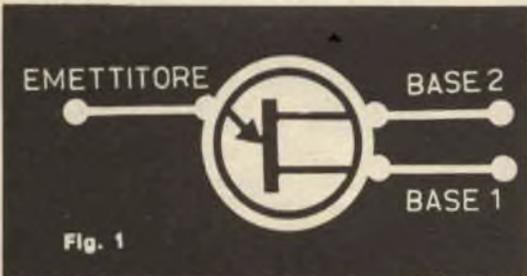
saldato funge da reoforo di Emettitore. La saldatura Alluminio-Silicio è l'unica « giunzione » presente, da cui il nome del dispositivo.
