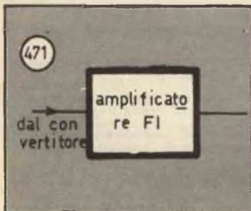
(471) L'amplificatore FI, che segue lo stadio convertitore, può essere, come abbiamo visto, a canali separati o unico (sistema inter-carrier).
