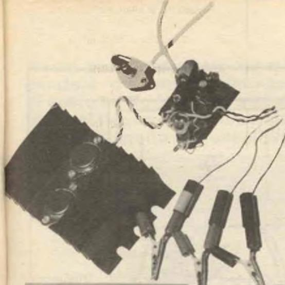
in serie al collegamento di A mettete un amperometro e provate. La corrente massima fornita dalla pila non è in grado di danneggiare il regolatore; (non aspettatevi però che funzioni il dispositivo di sicurezza, poiché, sia la tensione, che la corrente sono troppo basse). *Tutte queste operazioni vanno effettuate prima di collegare il dispositivo alla pista altrimenti si può correre il rischio di bruciarlo.* Effettuate ora i collegamenti alla pista seguendo la fig. 5, ponendo in serie al
