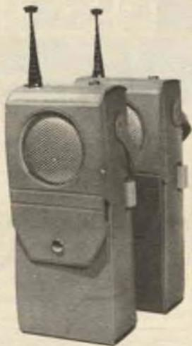
**MICROTALK** radiotelefono transistorizzato. Caratteristiche tecniche: Apparato per comunicazione bilaterali. Frequenza di lavoro: 29,5 MHz. Potenza irradiata: 5 mW. Portata: oltre 2 Km. Ricevitore: superrigenerativo. Trasmettitore: modulato in ampiezza. Alimentazione: pila a secco da 9 V di lunga autonomia (reperibile ovunque). Peso: gr. 350. Dimensioni: cm. 16 x 7 x 3.
