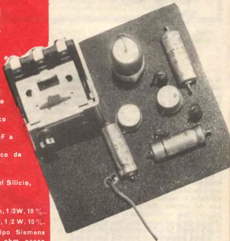
Purtroppo, sono troppi, veramente troppi i metodi di controllo dei vari registratori per esporre la «tipica connessione» tra Ry1 ed il tasto di registrazione. Chi legge tenga presente che i contatti di Ry1 devono poter chiudere i circuiti controllati manualmente: ecco tutto.
