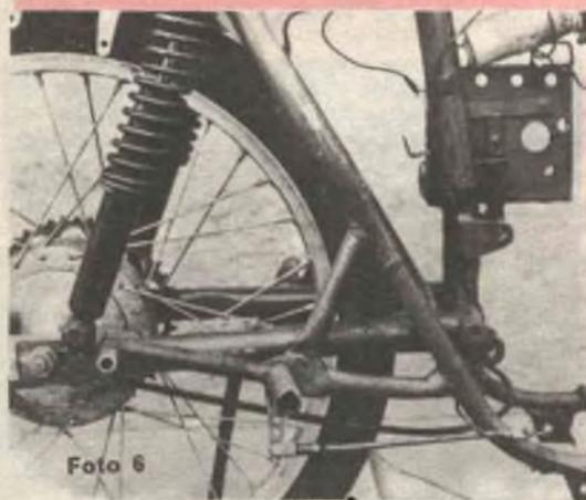
Foto n. 6 Questa foto mostra invece la corretta sistemazione del castelletto di supporto della pedaliere del cambio saldato al tubo modificato della culla destra del telaio.
