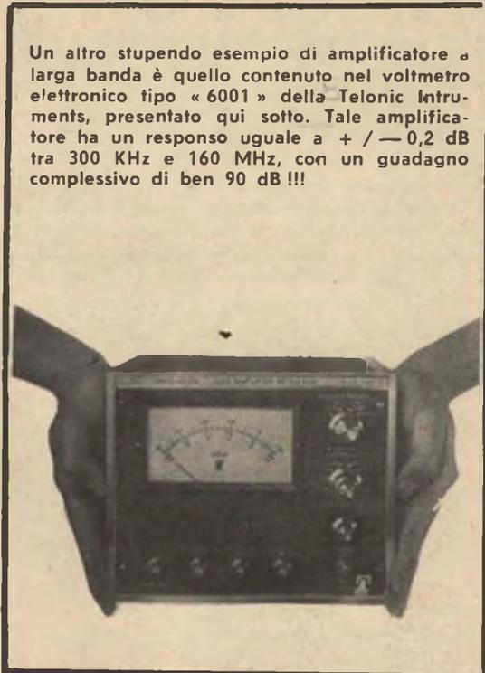
Un altro stupendo esempio di amplificatore a larga banda è quello contenuto nel voltmetro elettronico tipo « 6001 » della Telonic Instruments, presentato qui sotto. Tale amplificatore ha un responso uguale a  $+ / - 0,2$  dB tra 300 KHz e 160 MHz, con un guadagno complessivo di ben 90 dB !!!
