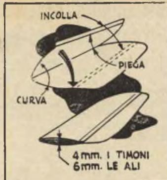
all'elica la necessaria presa sull'atmosfera. Le due pale verranno quindi unite con un cilindretto di legno, lungo circa mm. 80.
