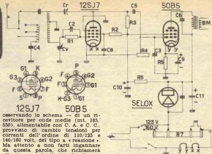
FIG. 1 - Schema elettrico e collegamenti alle valvole
