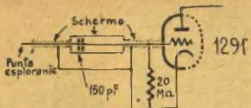
cennato (fascicolo 5 e 7 1950) però esclusa tutta la parte di alta frequenza ossia la bobina L1 L2 L3 ed i condensatori C1 C2 C3 C4, e modifichi secondo lo schema accluso tenendo presente che il condensatore da 150 pF va schermato nella punta esplorante ed il cavetto che unisce alla griglia controllo del primo triodo della 1291 va messo a massa. Anche il lato — 1,5 della piletta di accensione va messo a massa.
