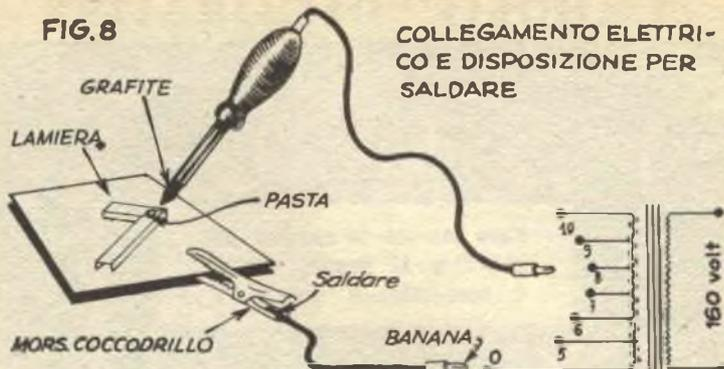
COLLEGAMENTO ELETTRICO E DISPOSIZIONE PER SALDARE
