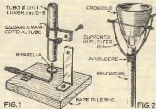
re con la pipetta e per ram-mollire tubi di vetro. Sollevando il tubo si otterrà invece una fiamma azzurra di temperatura più elevata, formata di due coni, uno interno ed uno esterno, fiamma che non è rumorosa come quella di un Bunsen vero e proprio, anche quando l'aria è sovrabbondante.
