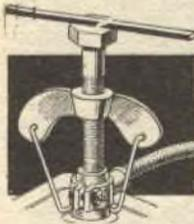
Se avete delle noie nel rimuovere i cavi corrosi dalle batterie, ecco qui un utensile che vi sarà di non piccolo aiuto. Consiste di un bullone da 3/8" e di un dado
