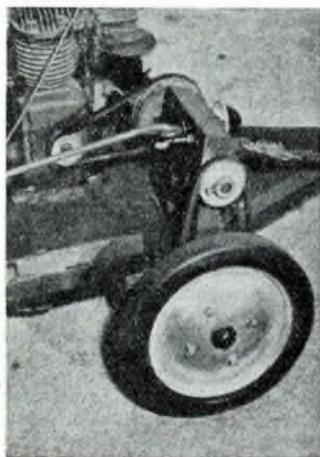
**QUANDO LA LEVA** della frizione è spinta indietro, la cinghia di trasmissione si tende, comunicando alle ruote la potenza del motore e l'auto si mette in movimento.
