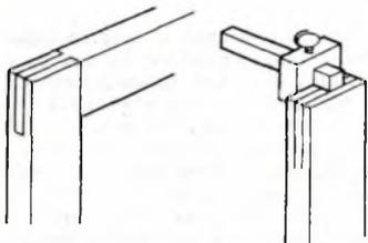
Il giunto a mortasa aperta e tenone è semplice e robusto. Per questo lo si usa sovente nelle intelaiature, laddove la solidità è un requisito essenziale. Per la sua esecuzione non occorre che un po' di cura.
