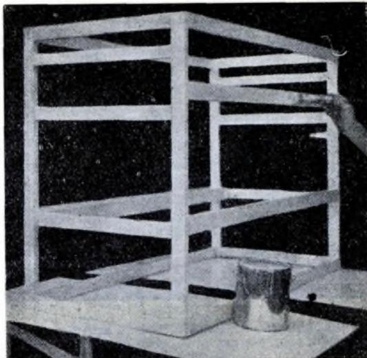
**SMALTATO DI BIANCO**, il telaio di una semplice scatola per semenzai è pronto ad essere rivestito di faesite metallizzata. Usate correntini di cipresso di 2,5x3, trattati con un qualche preservativo, uniti a mezzo di viti in ottone.
