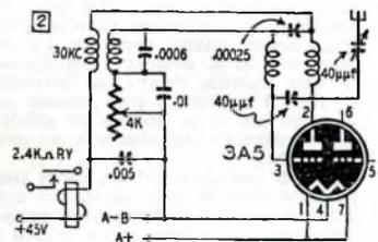
**Il monovalvole Goode** usa una valvola a gas, ed è regolato in modo che l'arrivo del segnale causa una diminuzione della corrente di placca che provoca l'apertura del relay.
