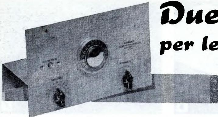
te. Il trivalvole può coprire anche la banda delle onde lunghe (basse frequenze). L'effettiva gamma di frequenze va da 155 kc. a 35 mc., quella del secondo da 550 kc a 31,5 mc.
