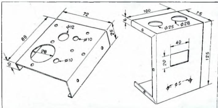
Il telaio vero e proprio (a destra) è contenuto in una scatola di alluminio in due pezzi dei quali a sinistra è mostrato quello anteriore. Procuratevi tutto il necessario, poi controllate se le nostre misure vanno bene per i componenti che vi siete procurati
