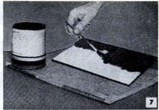
Il vetro deve essere posto perfettamente in piano dentro il vassoio, perché la soluzione argentata possa formarvi sopra una pellicola di spessore sufficiente. Blocchetti di caucciù a sezione triangolare servono benissimo allo scopo.
