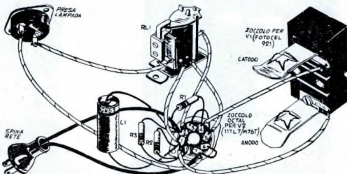
Schema pratico dei semplicissimi collegamenti da fare. Tenete presente che la resistenza R3 in un primo momento va collegata senza saldatura, perché il suo valore esatto va determinato a furia di prove.
