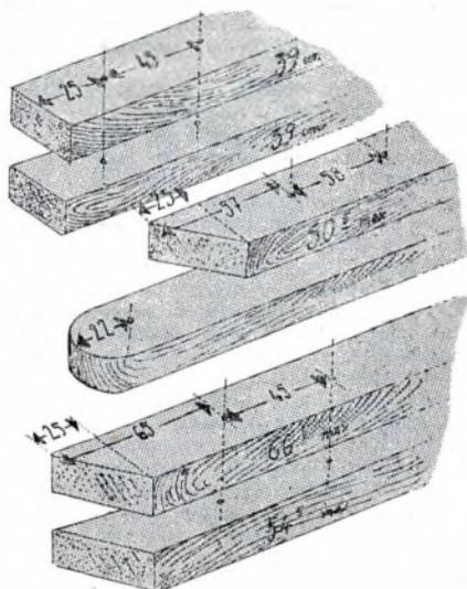
Fori debbono esser fatti a 22 mm. dalla tangente delle estremità arrotondate ed in tutti gli altri punti segnati nell'illustrazione di destra, attenendosi strettamente alle misure. Il diametro di tutti sarà di 3 mm.
