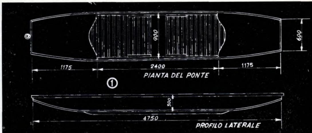
ghezza di 6 centimetri, che occorre per offrire un sicuro appoggio ai due pezzi di compensato che costituiscono il fondo.
