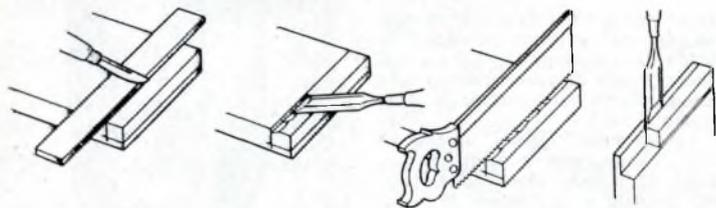
Quando si tratta di aprire un canale trasversalmente alla grana, occorre far ricorso al saracco per tagliarne le spalle, dopo aver tracciato le linee guida con una lama affilata.
