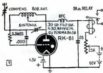
**Il ricevitore monovalvole Aerovalvole:** quando la super-reazione si manifesta, la corrente di placca è bassa, perché è alto il potenziale di griglia
