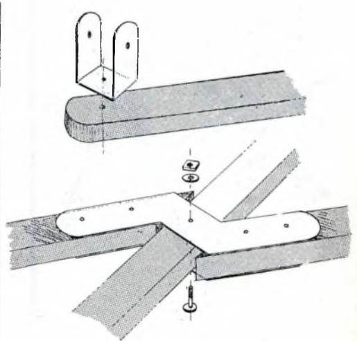
Montate poi le due parti della sedia, anteriore e posteriore. Notate che i pezzi C, che sono alle estremità dei pezzi, non sono fissi, ma impernati mediante un bulloncino, fornito di dado e di riparella. Una riparella è bene porla anche tra testa e legno, per evitare che questo si rovini. E' inutile, invece, per i pezzi B, perché in questo caso il metallo è a contrasto del metallo.
