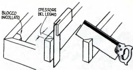
non sarebbe solido quanto occorre, se non si provvedesse a rinforzarlo. Un blocco incollato, e magari avvitato, nell'interno è uno dei mezzi migliori e più semplici per conferirgli robustezza necessaria. Si potrebbe anche ricorrere a delle spine od a delle linguette, ma la loro messa in opera non è troppo semplice, e di conseguenza è bene che sia lasciata agli esperti.
