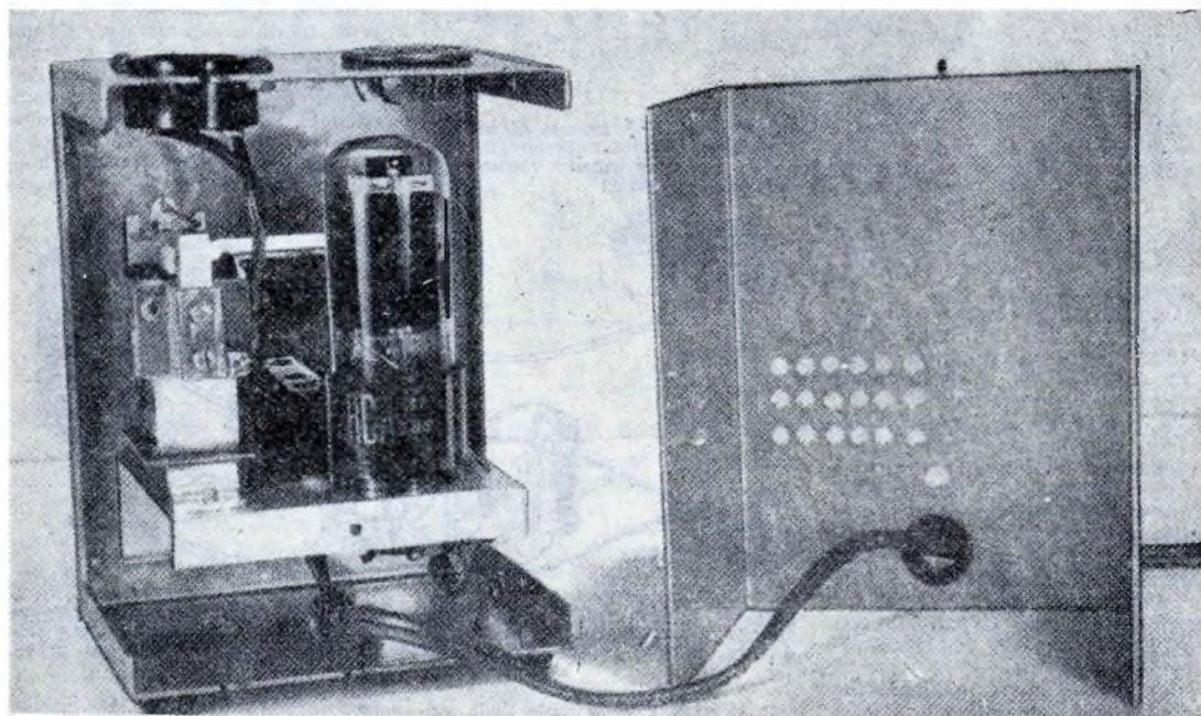
L'apparecchio completo nel telaio. Notate che i fori dai quali passano il cordone dell'alimentazione sono isolati per evitare cortocircuiti. In alto la presa di corrente per il cordone che porta all'impianto di illuminazione.
