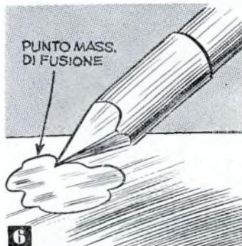
**6** Quando invece il saldatoio è scaldato alla giusta temperatura, lo stagno scorre bene, senza accumularsi.
