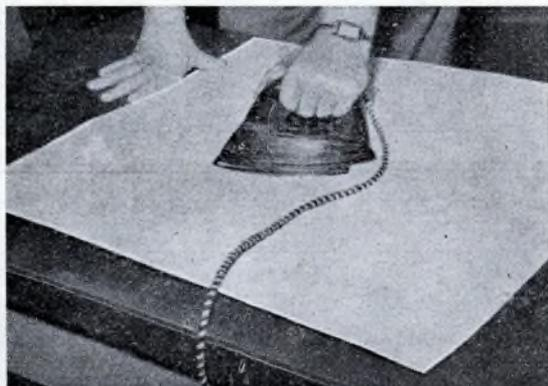
Inumidire il compensato, poi passarvi sopra un ferro ben caldo, oppure, tenerlo per qualche ora nella sabbia calda ed umida.
