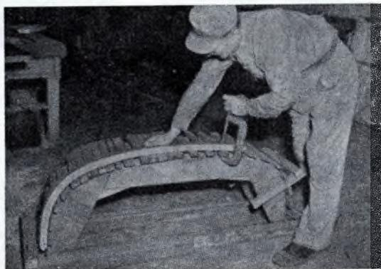
Ecco una forma per realizzare le intelaiature di una imbarcazione.
