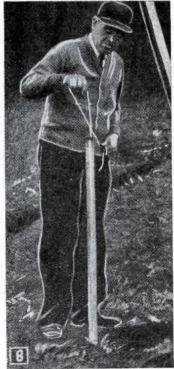
**Prova per il controllo della presenza dell'acqua nello strato raggiunto dalla punta: consiste nel calare un lungo filo a piombo nel tubo, fino a che il peso di esso non raggiunga il fondo.**
