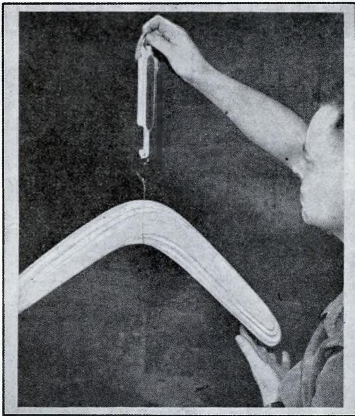
**Controllate il bilanciamento del vostro boomerang: se ambedue le sue parti non avranno lo stesso peso, potrete notare che esso, in volo, ondeggerà e sarà meno stabile. Per effettuare il bilanciamento basterà che raspiate alquanto la estremità che pare pesare di più. Il controllo si effettua sospendendo il boomerang per il suo centro.**
