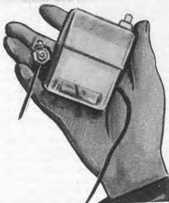
volt. La tensione anodica necessaria gli è invece fornita da una batteria da 22,5 volt, del tipo compatto, ossia di quelle che si usano ancora per l'anodica degli apparecchi a valvole per i deboli di udito e non richiede di essere sostituita se non dopo diversi mesi di uso normale dell'apparechietto.
