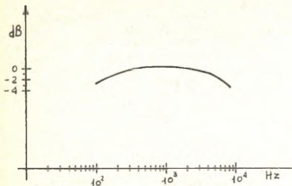
Fig. 7: Distorsione lineare a 50 mW di uscita
