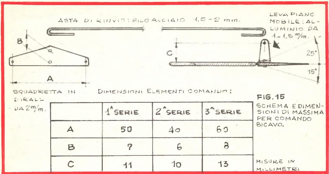
modelli da velocità, è consigliabile realizzare la squadretta in dural da 2 mm., e, specie per la 3<sup>a</sup> serie, imboccolare tutti i fori con pezzetti di tubetto d'ottone, ribattuti da ambedue le parti. Spesso la squadretta viene piegata come in fig. 16, per poterla fissare sotto
