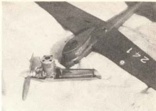
Particolare di un altro modello 1<sup>a</sup> serie. Si notino il fondo metallico corto; l'astina di fissaggio posta avanti al cilindro del motore e l'altra dietro al serbatoio, e l'ala con il longerone di rinforzo.
