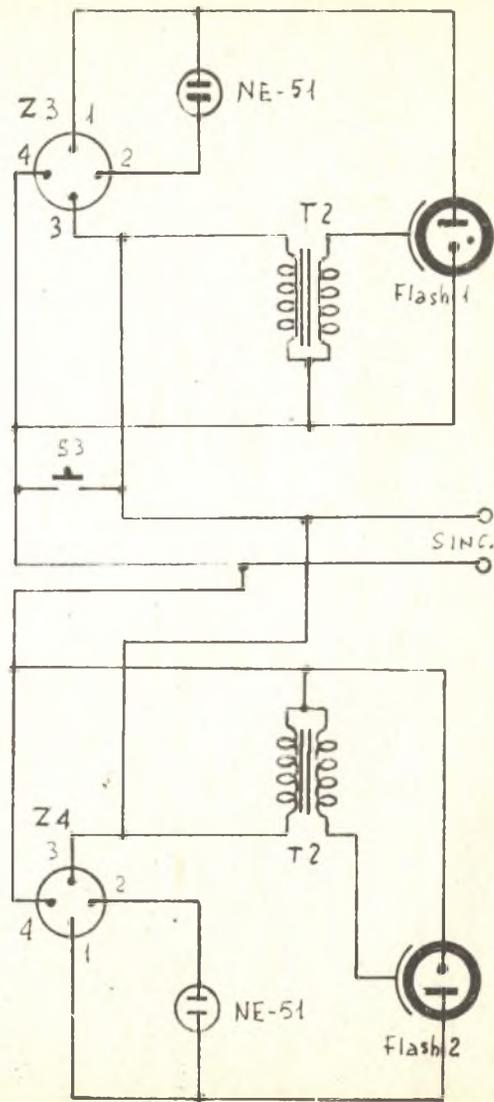
FIG. 2 - Flash elettronico a tre intensità e due tempi
