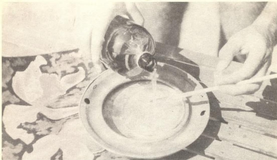
L'operazione visibile nella foto è quella di scioglimento della plastica. Si noti come l'operatore **aiuti**, con il pennello, l'azione solvente del cloroformio.
