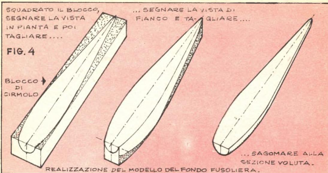
ma secondo la vista in pianta e poi secondo la vista laterale inferiore della fusoliera (figura 4), lavorando con la sega a nastro, o semplicemente con scalpello e raspa. Quindi si inizia la sagomatura esterna, mediante raspa e cartavetrata, ed interna, mediante sgorbia, fino a raggiungere uno spessore di 2-3 millimetri (maggiore anteriormente e minore in coda) ed una perfetta levigatura.
