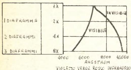
**FIG. 2 - Risposta spettrale della cellula CL-4**
