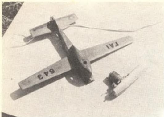
Un modello nel quale si può notare la fusoliera realizzata con il sistema a cassone ed il piano di coda ricavato da compensato. Si noti anche il disassamento verso l'interno della deriva.
