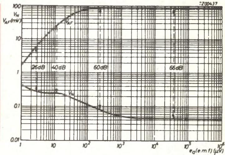
more ( $V_n$ ) e della tensione di uscita a frequenza audio ( $V_{af}$ ) in funzione della tensione di antenna  $E_a$  (f.e.m.).
