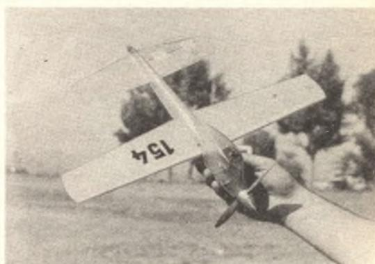
Un modello la cui carenatura è realizzata in modo da lasciare scoperta la testata del motore. La parte superiore della fusoliera è realizzata in fibreglass e resina poliestere, sistema che richiede una certa pratica costruttiva, ma consente di ottenere una notevole robustezza e una superficie levigatissima.
