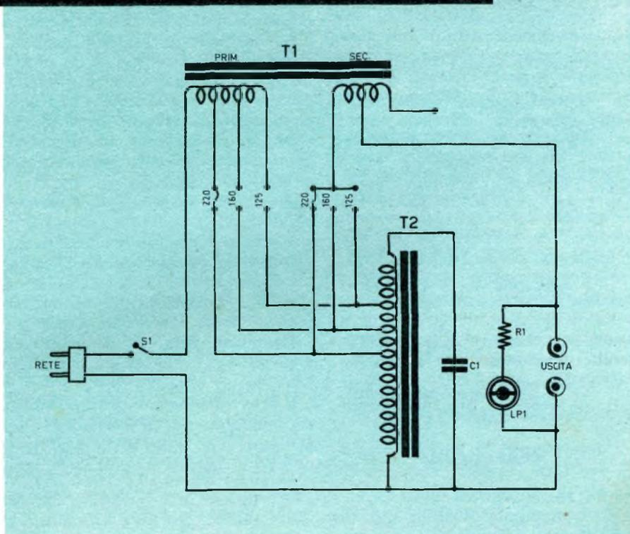
SCHEMA ELETTRICO di uno stabilizzatore a ferro saturo per 250 o 320 Volt. L'autotrasformatore T1 assieme al condensatore C1 da 16 mF. per i 250 Volt e da 10 mF. per il complesso a 320 Volt, costituiscono gli elementi principali dello stabilizzatore.
