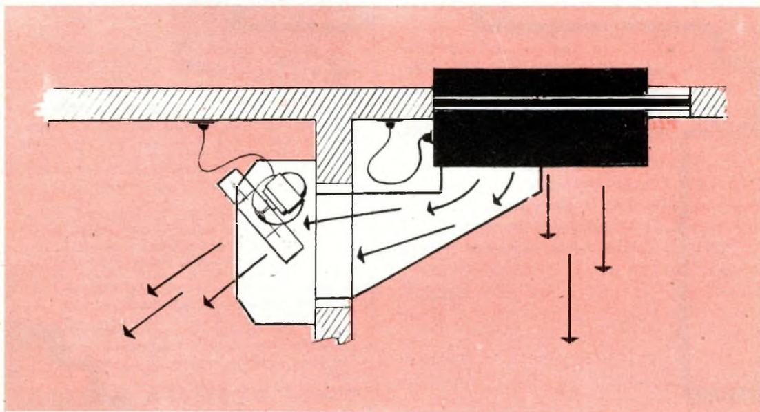
Per conseguire un risultato utile dovreste costruire una cassetta che chiuderà gli elementi del radiatore del termo contro il muro. E' ovvio che la cassetta non dovrà chiudere ermeticamente il radiatore per cui lascerete come vedete in fig. 2 un'apertura rettangolare in alto.
