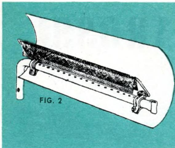
FIG. 2 - Nella figura si potrà notare i fori per la fuoriuscita del gas, e la rete metallica.
