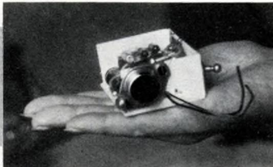
**Per ottenere da una batteria a 12 Volt una tensione di 100 o 200 Volt necessari per alimentare un qualsiasi complesso, radiricevente non si fa più uso di vibratorri, ma semplicemente di due transistor montati su circuito oscillante**
