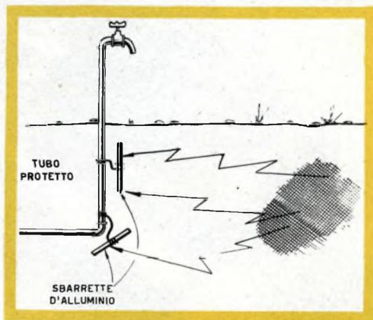
**Il blocco di alluminio o di metallo analogo viene interrato vicino alla struttura di ferro da proteggere ed essendo più attivo diviene sede di un fenomeno elettrochimico più attivo di quello che si svolgeva in precedenza sul ferro, per cui la corrente e con essa la corrosione, risulta distolta dal ferro stesso.**
