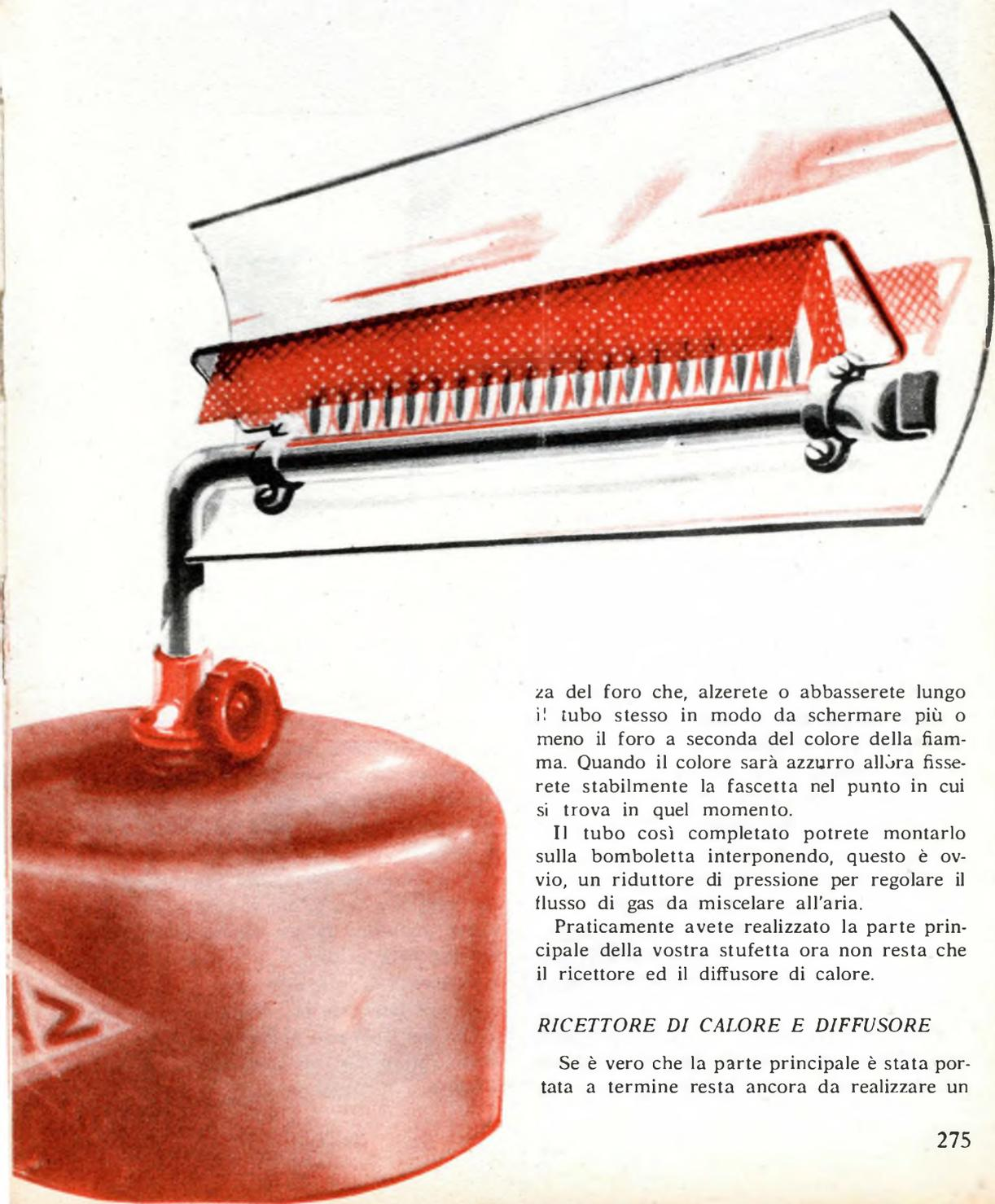
za del foro che, alzerete o abbasserete lungo il tubo stesso in modo da schermare più o meno il foro a seconda del colore della fiamma. Quando il colore sarà azzurro allora fissere stabilmente la fascetta nel punto in cui si trova in quel momento.
