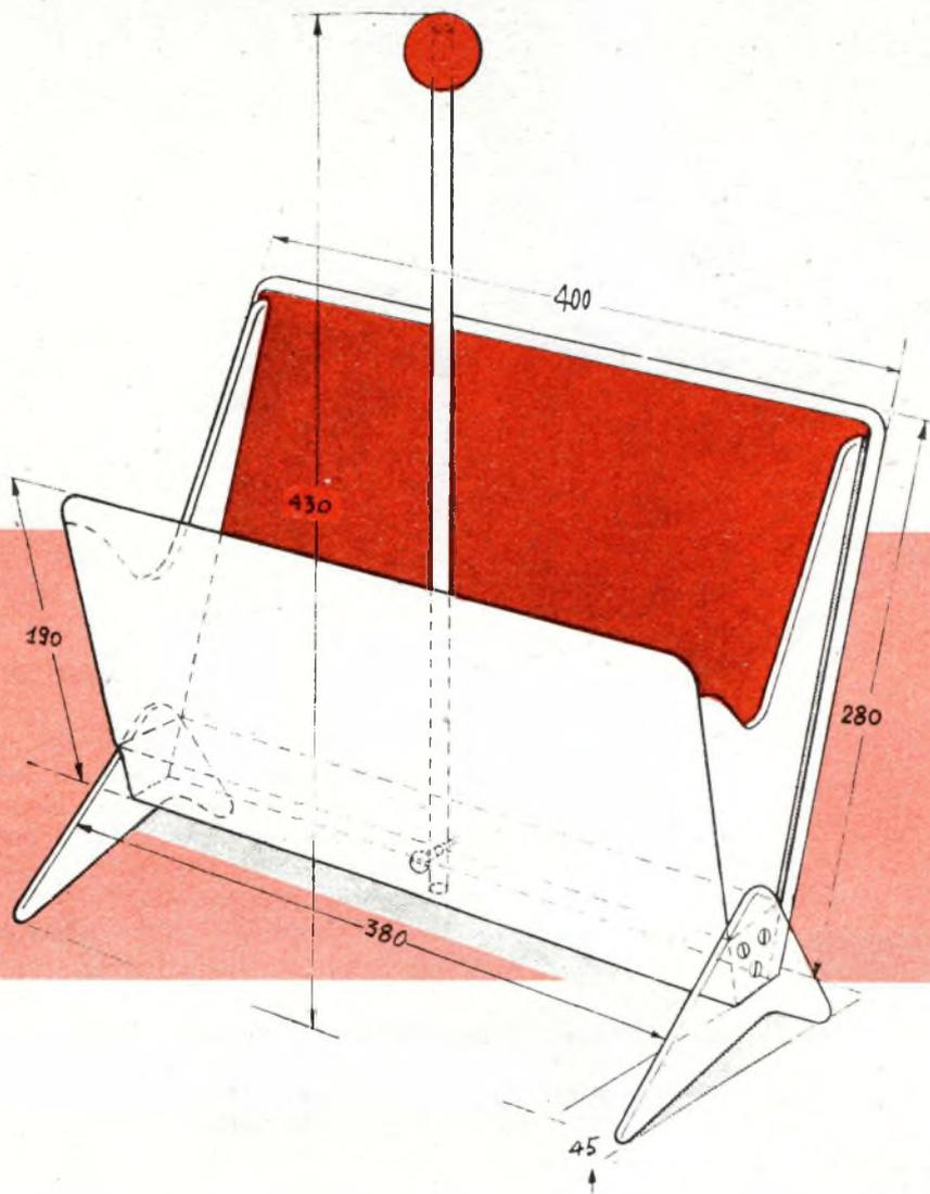
Per quanto concerne le gambe, ancora una volta la fig. 2 non permette di avere dubbi sulle misure da adottare. Inutile raccomandarvi l'esattezza.
