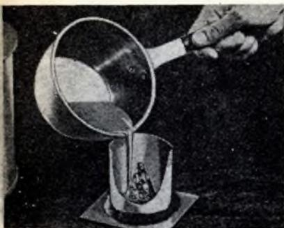
**FIG. 1 - Costruite una specie di parete tutt'intorno al modello (sopra).**
