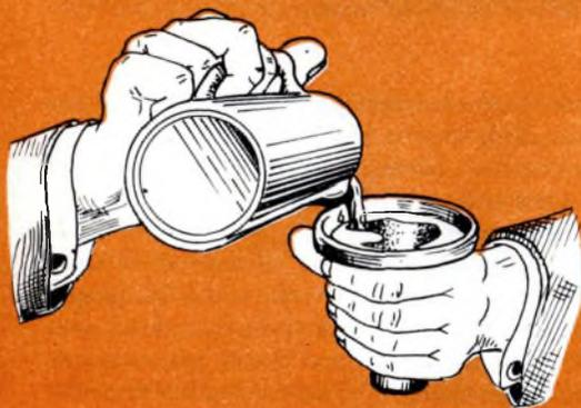
**FIG. 7 -** La prima metà del gesso o del poliestere si versa nello stampo tenendolo in mano.
